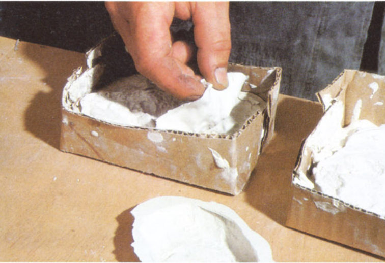
Bild 5: Nach Ausvulkanisierung des Gummis (bei Raumtemperatur ca. 1 – 2 Stunden) wird die Gummiform mit dem noch darin befindlichen Stein in ein vorbereitetes "Gipskorsett" eingedrückt.
