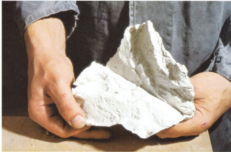
Bild 6: Ist die Gipschale, die wegen der Weichheit des Gummis erforderlich ist, ausgehärtet kann der Originalstein entnommen und mit den ersten Gipsausgießungen begonnen werden. Unser Bild zeigt einen hervorragend gelungenen Abguß.
