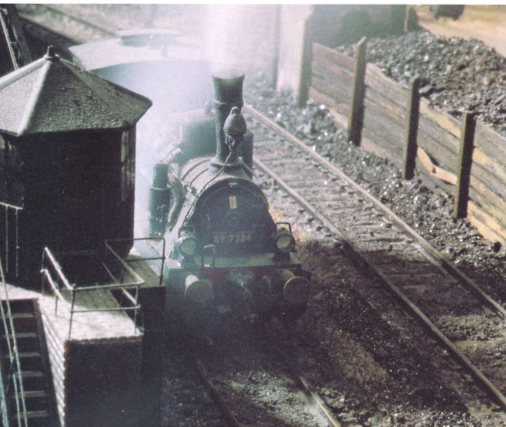
◀ Bild 2: Der "Rangierbock" rollt an die Bekohlung. Sämtliche Behandlungsanlagen des Betriebswerkes sind im Eigenbau erstellt. Natürlich füllt echte Kohle den aus Furnierholz und Profilen erstellten Bansen.
