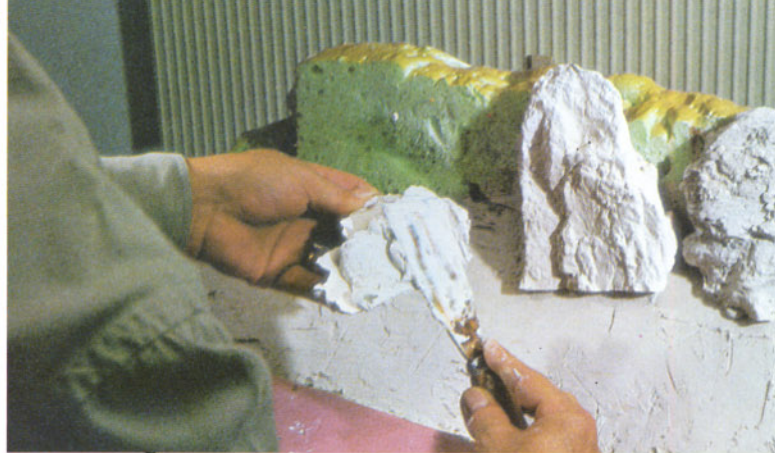
Bild 10: Dann werden die Felsteile auf der Rückseite mit einem groben Pinsel angefeuchtet und mit nicht zu flüssigem Gips eingestrichen.
