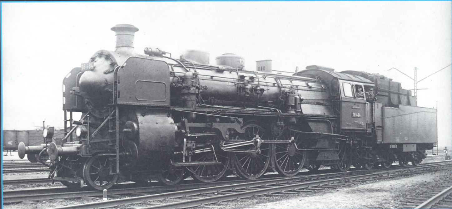
Bild 10: Die Nürnberger 18 484 fällt durch den neben dem linken Windleitblech angebrachten Dejektor-Speisewasserreiniger auf.
