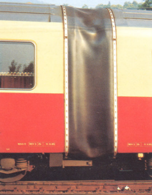
Bilder 14-17: Hier wieder wie auf der vorhergehenden Seite oben abgebildet zwei Detailpartien des TEE "Gottardo" mit Faltenbalk usw. Darunter die Gestaltung der Details beim Modell. Bei engen Radien muß auf den extra einzusteckenden Faltenbalk verzichtet werden.
