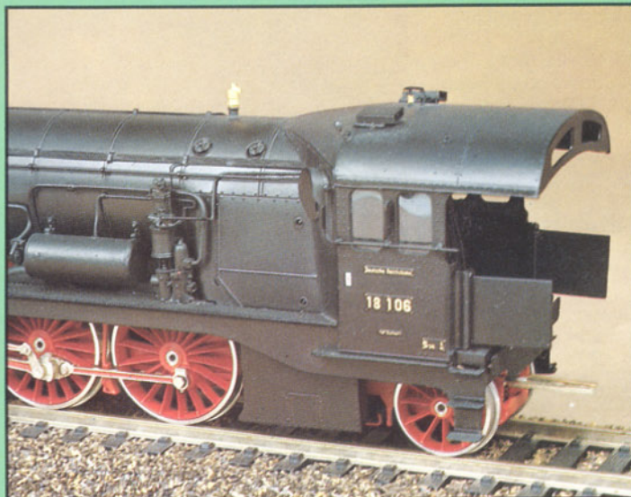
Bild 16: Die Türen am Führerhaus sind beweglich angeordnet, ebenso die Brücke zum Tender.
