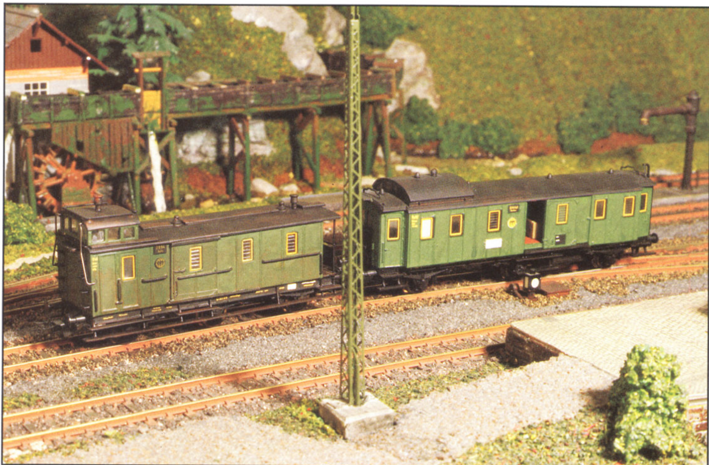
Bild 1: H0-Modelle des Pw3 (Bay 92) und des Pw3i (Bay 95). Man sieht deutlich den Wandel der Konstruktionsprinzipien des Waggonbaues in diesen Jahren. Zum Vergleich: links "Baujahr" 1892, rechts 1895. Nur drei Jahre auseinander, mutet der eine wie Methusalem, der andere selbst für heutige Begriffe noch modern an. Foto: Dr. Hufnagel
