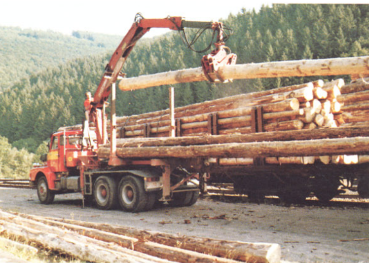
Bild 3: Der Sattelaufleger ist leer, das Zusammenlegen des Krans in die Fahrstellung hat bereits begonnen. Bei dieser Fahrzeuggattung kann der Auflieger bei Leerfahrt nicht auf die Zugmaschine verlastet werden. Die Runnen bleiben in voller Länge ausgezogen. Bei stark geneigten Frontscheiben im Sommer ein wertvolles Zubehör: die Sonnenblende.
