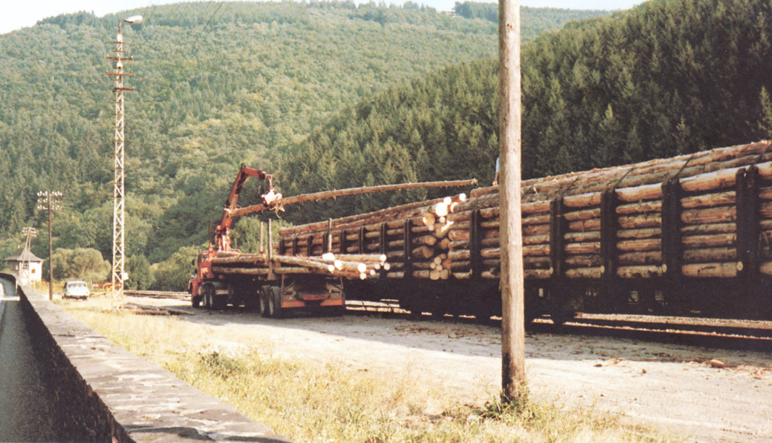
Bild 1: Der bordeigene Kran macht den Lastzug von stationären Verladeeinrichtungen unabhängig. Zum Zeitpunkt des Fotos war der größere Teil der Langholzladung bereits auf den Runnenwagen umgesetzt. Bei Leerfahrten von Vorteil: der Unterfahrerschutz des Aufliegers ist mit reflektierender Folie beklebt.
