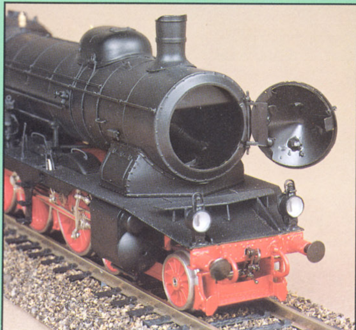
Bild 12: In der Rauchkammer des H0-Modells der württ. C von Lemaco, deren Tür zu öffnen ist, findet man eine komplette Inneneinrichtung.
