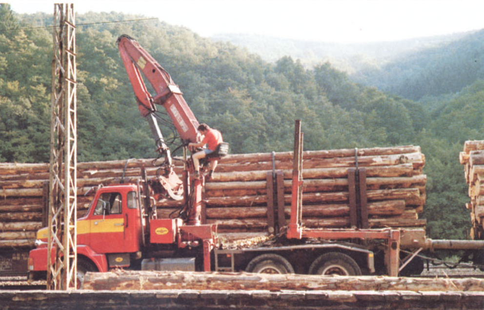
Bild 3: Der Sattelaufleger ist leer, das Zusammenlegen des Krans in die Fahrstellung hat bereits begonnen. Bei dieser Fahrzeuggattung kann der Auflieger bei Leerfahrt nicht auf die Zugmaschine verlastet werden. Die Runnen bleiben in voller Länge ausgezogen. Bei stark geneigten Frontscheiben im Sommer ein wertvolles Zubehör: die Sonnenblende.
