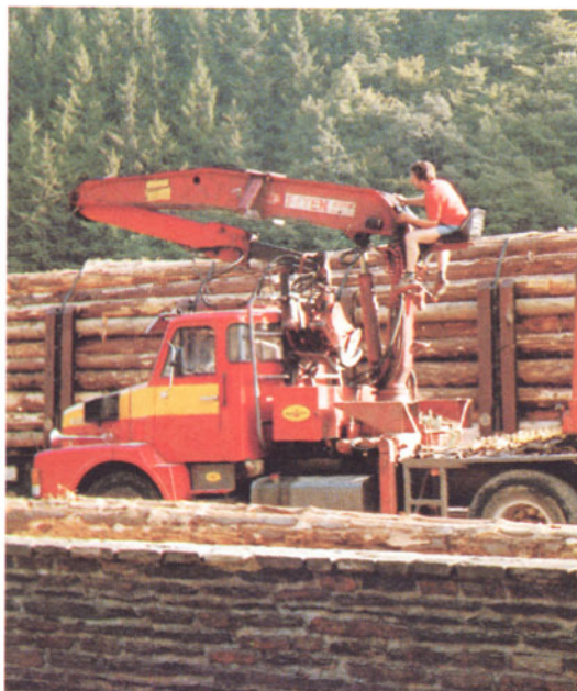
Bild 4: Der Kran ist schon fast ganz über dem Fahrerhaus in Fahrstellung gebracht. Je "schwerer" der Kran, desto größer die Nutzlasteinbuße des Fahrzeuges. Den linken Vorderkotflügel zieht eine Druckluftfanfare nach Art der amerikanischen Trucker.
