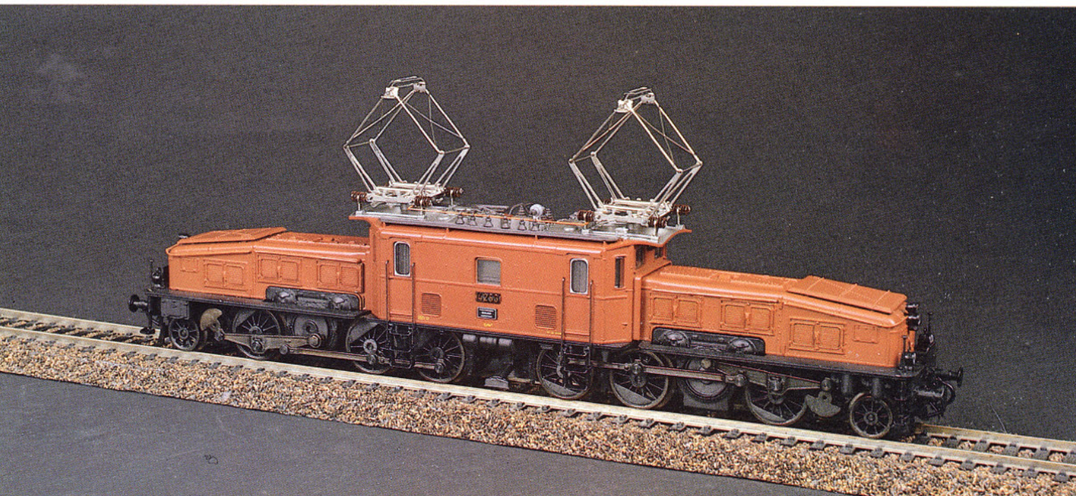
Bild 7: Das exzellente Modell wurde fast ganz aus Metall-Druckguß gefertigt, nur das mittlere Gehäuseteil und die Deckel auf den beiden Vorbauten bestehen aus Kunststoff.
