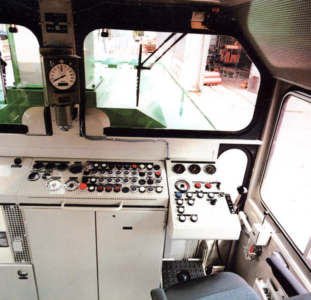
Bild 6: Ein Blick in den Führerstand einer dieselektrischen Lokomotive des Typs DE 1000 – im Bild der vordere Führertisch mit dem Elektronikschrank.
