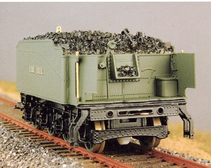
Bild 4: Unter dem Messinggehäuse des vierachsigen Tenders verbirgt sich vorbildliche Antriebstechnik. Ein Faulhabermotor mit zwei Schwungmassen treibt alle Tenderachsen an.
