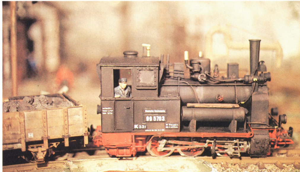
Bild 4: Die Lokomotive der ehemaligen Spreewaldbahn wurde im kompletten Eigenbau (aus Messing) auf einem LGB-Serienfahrzeugwerk aufgebaut.
