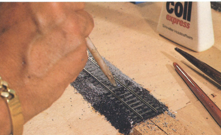
Bild 44: ...wird anschließend ein verdünntes Klebergemisch aufgetragen (siehe auch Haupttext).
