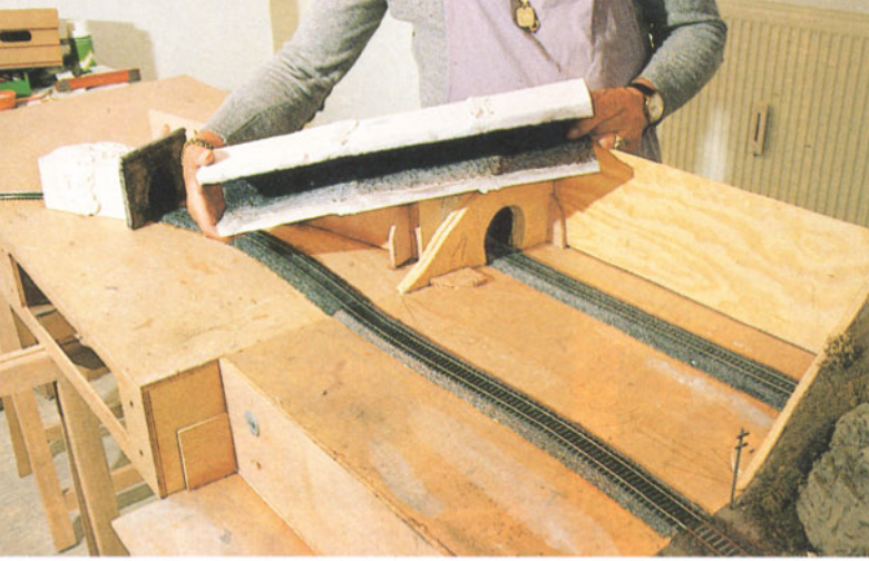
Bild 49: Das Einfügen einer vorgefertigten und innen eingefärbten Tunnel-Gipsröhre.
