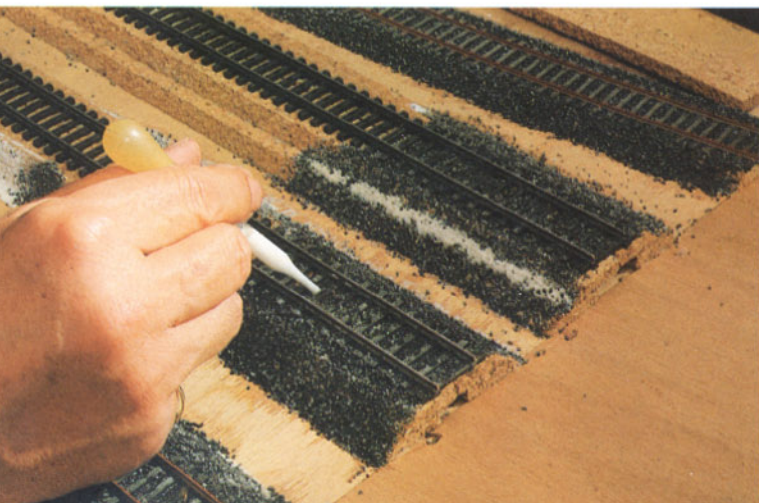
Bild 47: Hier sind die verschiedenen Gleisbettungen gut sichtbar. Vorne das doppelt hohe Gleisfundament mit durchgehender Schotterung durch zwei in der Schräge genau abschließend übereinander liegende Böschungstreifen hergestellt. Daneben dasselbe Verfahren, jedoch mit Böschungsabsatz. Die untere Stufe könnte genauso gut auch schon mit Grün bestreut werden.
