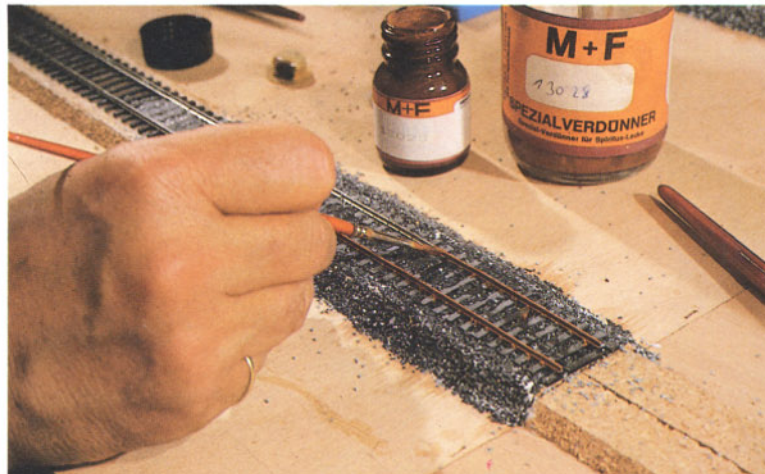
Bild 45: Mit Pinsel und Farbe wird nach dem Trocknen die Schieneneinfärbung vorgenommen...
