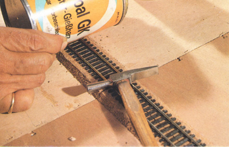
Bild 38: ...das Gleis selbst mit Pattex aufzukleben und es u. U. mit einer runden Dose (ohne scharfe Kanten) festzudrücken.
