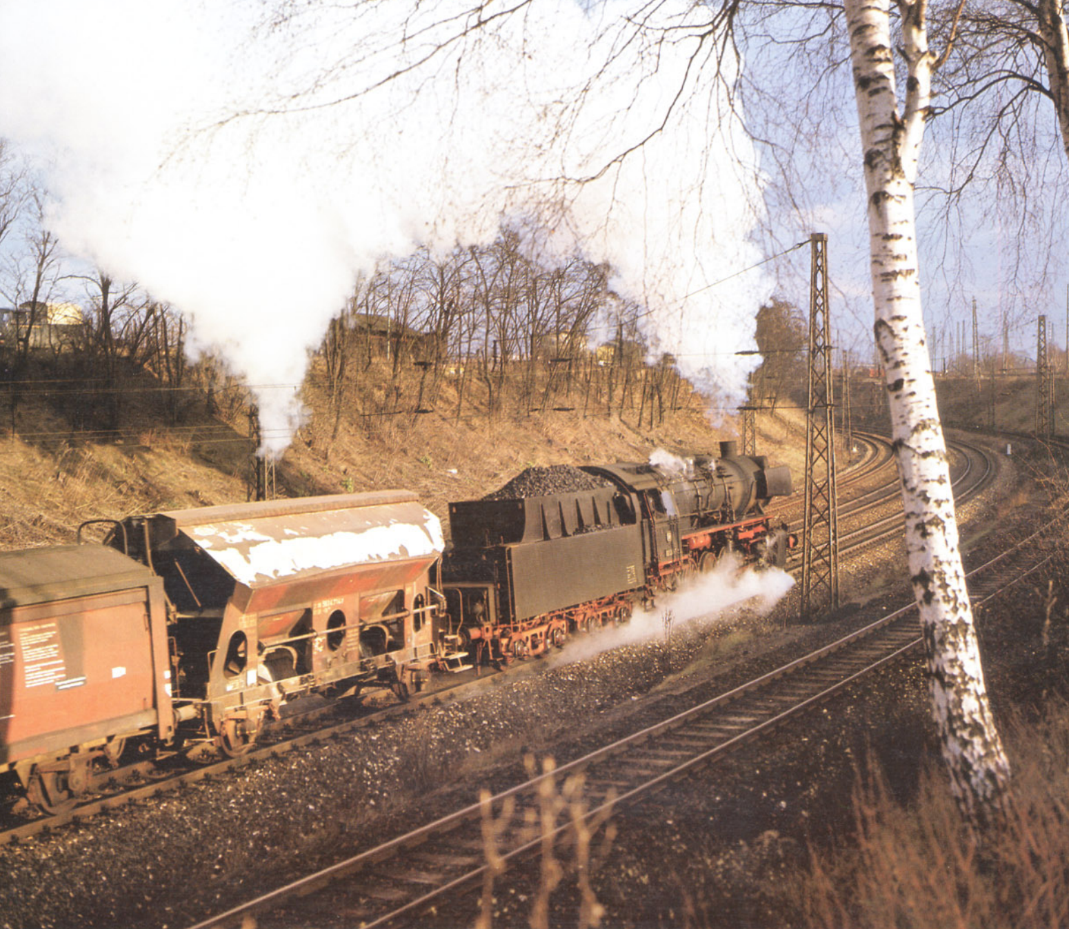
Bild 1: Der Selbstentladewagen hinter der Lokomotive 052 241 zeigt typische Merkmale eines häufigen Betriebseinsatzes. Auch der nachfolgende Wagen ist nicht mehr "taufersch". Foto: U. Geum
