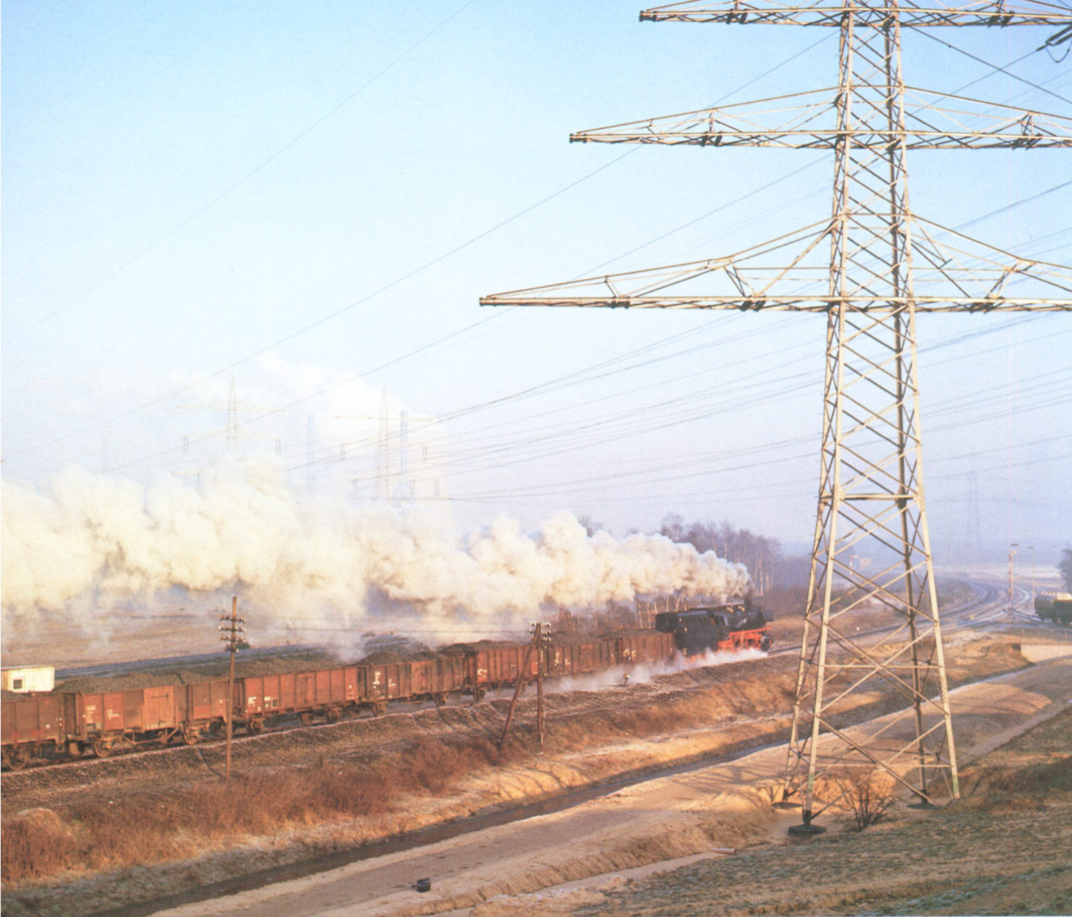
Bild 16: Zweiachsige offene Güterwagen verkehrten in Ganzzügen mit Kohle beladen auch im Emsland. Geführt wurden die Züge von Lokomotiven der Baureihen 042 und 043 der Bahnbetriebswerke Emden und Rheine.
