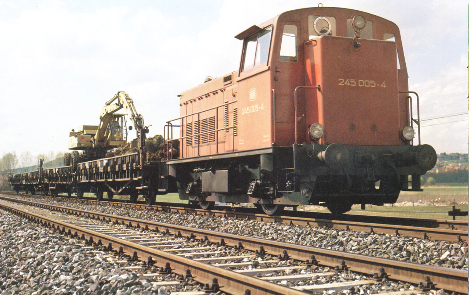
Bild 4: Hier wird ein Graben entschlammt. Ein kleiner Atlas AB 1302 führt, auf dem Waggon stehend, diese Arbeiten durch. Er kann vor- und zurücksetzen, um auch die dahinter befindlichen Wagen beladen zu können. Eine V 45 (245 005) befördert diesen Zug am 3.5.1973.
