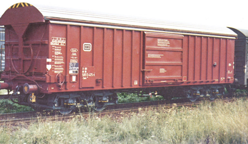
Bild 6: Wie im Märklin-Katalog auf Seite 144 sah dieser Schwenkdachwagen der DB (Taes) tatsächlich aus, als er am 27.8.1973 in Ledenitzen (Strecke Villach – Rosenbach) vor das Objektiv geriet. Er war nagelneu. Foto: Dr. Hufnagel
