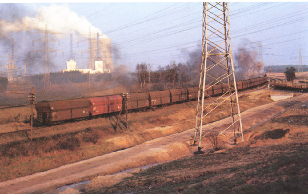
Bild 17: Den Gattungsbuchstaben F tragen die mit Erz beladenen Großraumwagen mit Seitenentladeklappen. Das bei Lingen im Emsland aufgenommene Bild erinnert an die dort bis Oktober eingesetzten ölgefeuerten Dampflokomotiven der Reihen 042 und 043.
