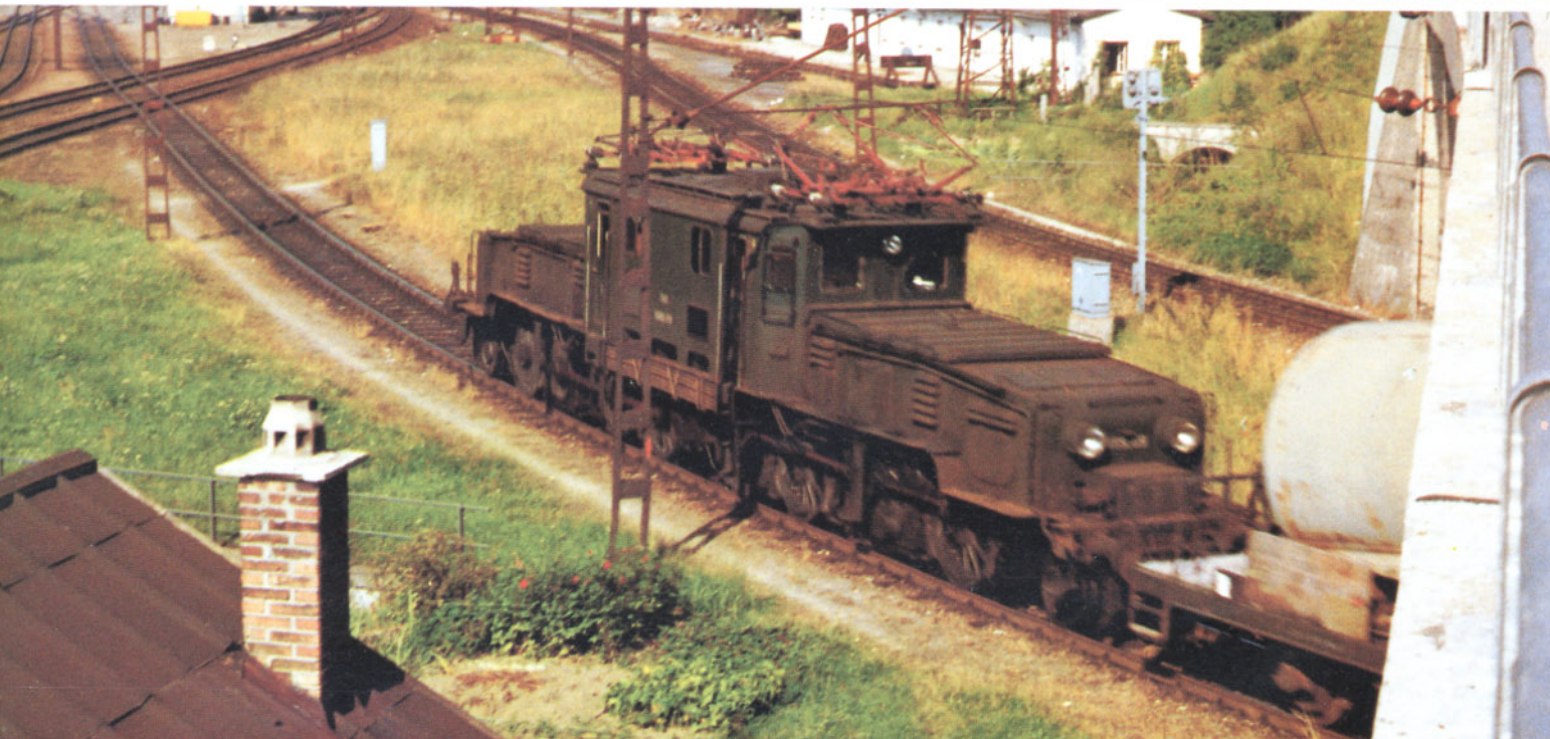
Bild 5: Am 29.8.1978 stand die 1189.08 der ÖBB noch voll in Betrieb. Trotzdem ist sie in einen schmutzig rostbraunen Schleier gehüllt. Das einstmalig silberne glänzende Dach, der tannengrüne Lokkasten und die hellgrauen Radsterne sind nun mit Bremsklotzstaub matt und bräunlich überzogen. Foto: Dr. Hufnagel
