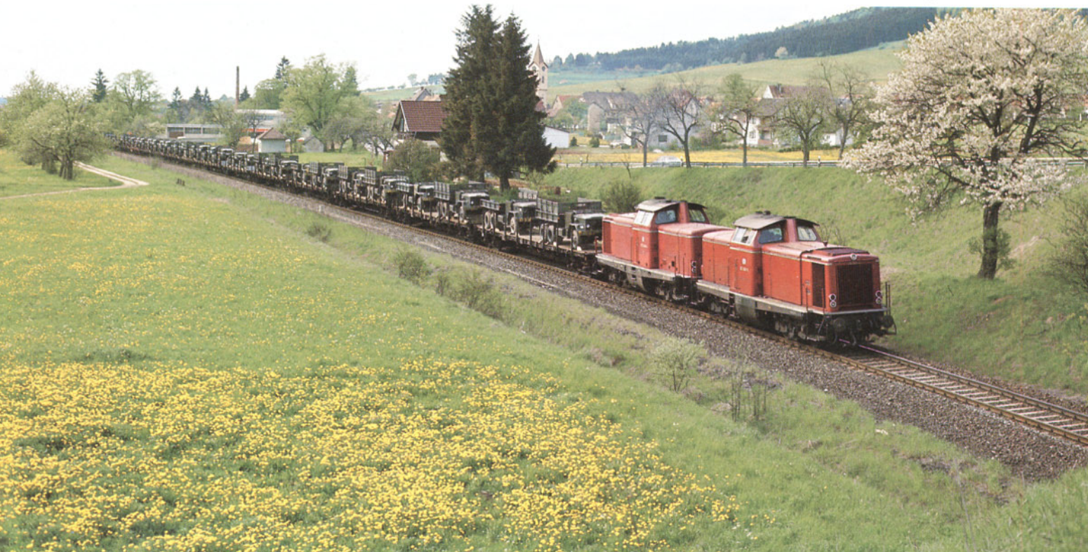
Bild 19: Zwei Diesellokomotiven der Baureihe 212 vor einem Zug mit leichten Militärfahrzeugen, die auf Rungenwagen der Gattung R zwischen Rottweil und Tuttlingen befördert werden.
