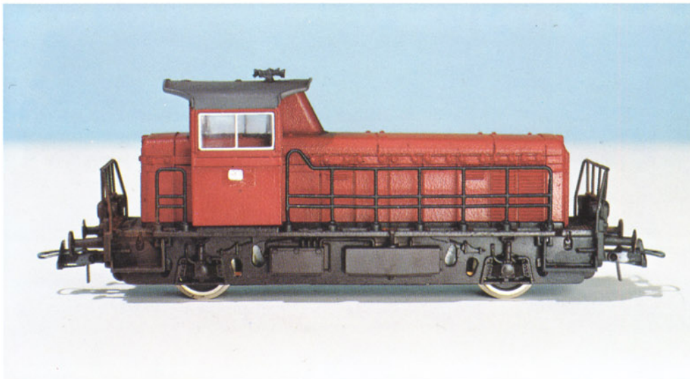
Bild 16: Aus der SNCF-Maschine haben wir durch Umlackierung eine Pseudo-V 45 geschaffen. Anschließend wurde diese Maschine mit Trockenfarben patiniert.
