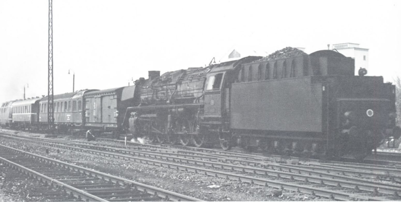
Bild 18: Im Sommer 1963 fanden auf der Allgäubahn Meßfahrten mit einer V 200 statt, die 45 023 war als Bremslokomotive mit von der Partie. Das Foto entstand bei der Ausfahrt in Buchloe. Foto: R. Hehl
