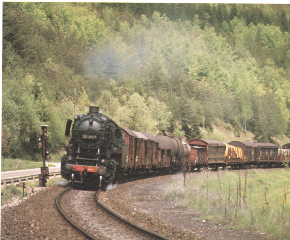
Bild 15: In der Mitte des Güterzuges laufen einige Schiebedachwagen der Gattung T, die in verschiedenen Bauausführungen in Dienst gestellt wurden.
