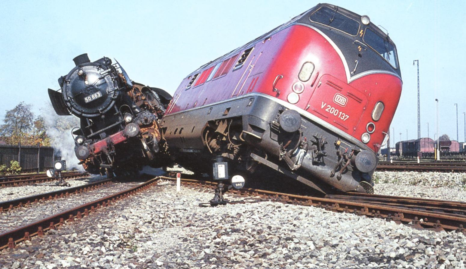
Bild 10: Am 17. Oktober 1965 stießen im Bereich des Bw Buchloe die 50 663 und die V 200 137 zusammen. Aufgrund eines mißverstandenen Befehls eines Feuermanns setzten sich beide Loks gleichzeitig in Bewegung, fuhren auf der Weiche ineinander und hebelten sich gegenseitig in die Höhe.
