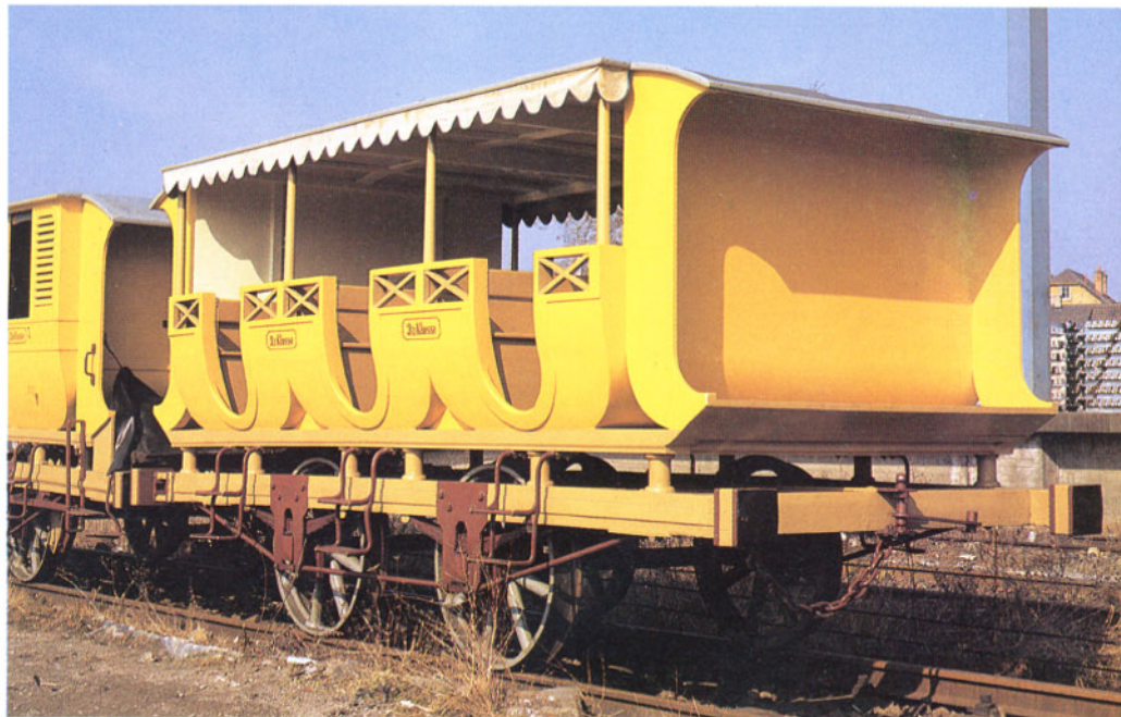
Bild 10: Etwas weniger komfortabel ist der Wagen der 3. Klasse ohne Bremse.
