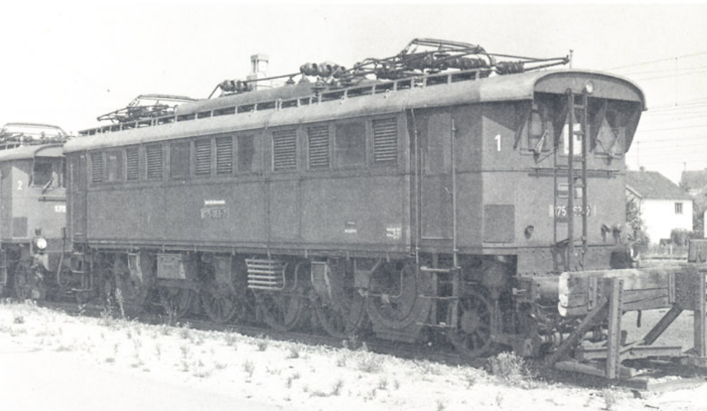
Bild 12: Die 175 063 steht am 1. 9. 1969 im Bw Ingolstadt. Hier sieht man einmal die sonst über der Pufferbohle hinter den Laternen versteckte Leiter „in Betrieb“. Sie diente lediglich dazu, der Lok „aufs Dach zu steigen“. Foto: Dr. W. Fiegenbaum
