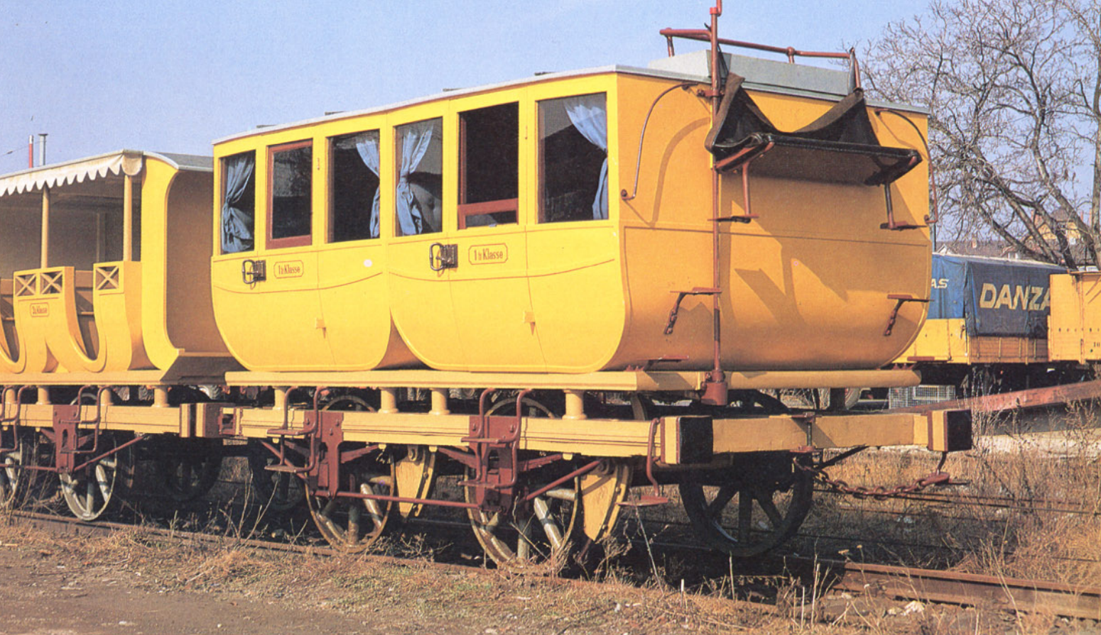
Bild 9: Polstersitze, Vorhänge und der hochgelegte Bremsersitz sind die Besonderheiten des Wagens 1. Klasse.
