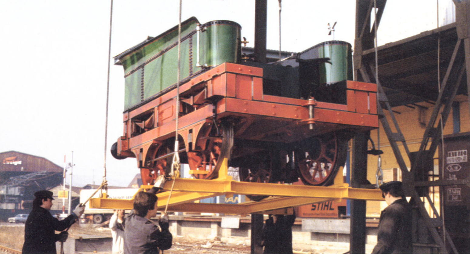
Bild 6: Entladen des Tenders am 1. März 1985 im Güterbahnhof von Stuttgart-Bad Cannstatt. Am Bockkran hängt ein spezielles Hebegeschrir, an dem die vier Drahtseile befestigt sind, die am Grundrahmen eingehängt sind.
