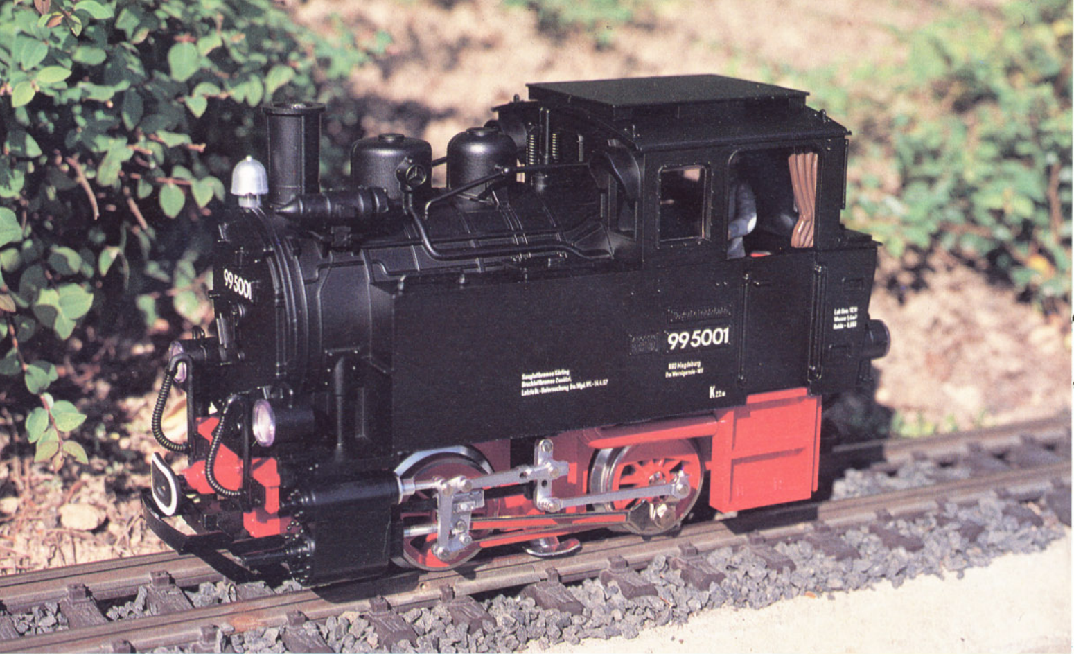
Bild 1: Das LGB-Modell der 99 5001 verfügt über eine Heusinger-Steuerung, über die Nachbildung eines Generators und an der linken Seite über eine fein ausgeführte Luftpumpe. Fotos 1 und 5: Obermayer
