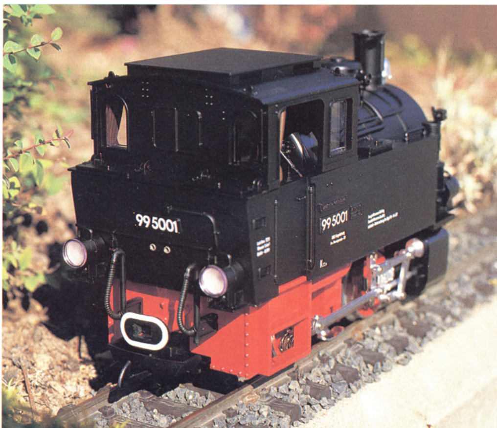
Bild 5: An der Rückfront der kleinen bulligen Lok erkennt man unter der Betriebsnummer die Lichtsteckdose.
