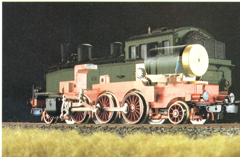
Bild 6: Die Firma SB-Modellbau in 8037 Olching liefert u. a. auch für die Hamo-Version der württembergischen T 5 von Märklin einen handwerklich sehr sauber gefertigten Komplett-Antrieb mit Faulhaber-Motor (Schwungmasse). Foto: W. Kosak
