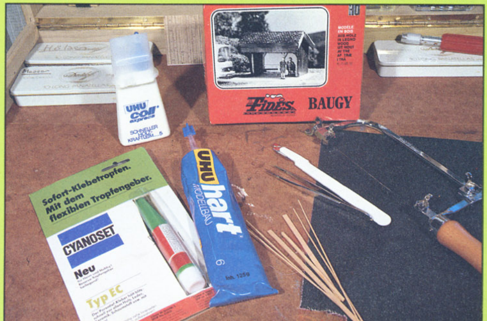
Bild 2: Werkzeug für die Holzbearbeitung: scharfes Messer, Pinzette, Laubsäge, 100er-Schmirlgelleinen und Holzkleber.
