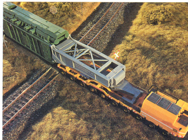
Bild 8: Aus zwei fast identischen Zugmaschinen besteht die Einheit. Beide Fahrer können sich über eine Gegensprechanlage während des Transportes gegenseitig informieren.
