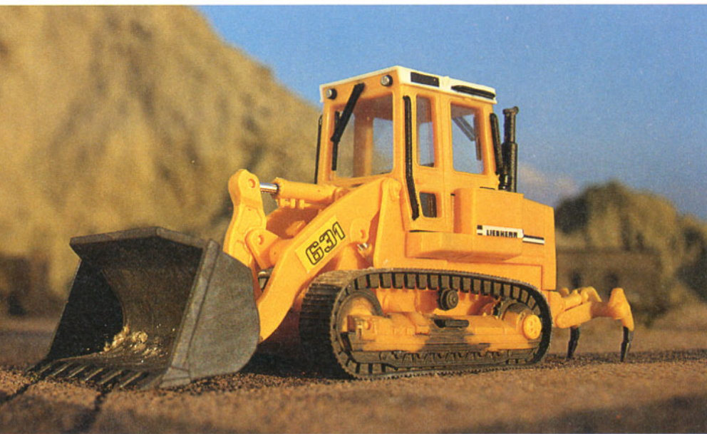
Bild 2: Die Raupe ist nach Anbringung des Kabinenaufsatzes und des Heckaufreißers einsatzbereit.
