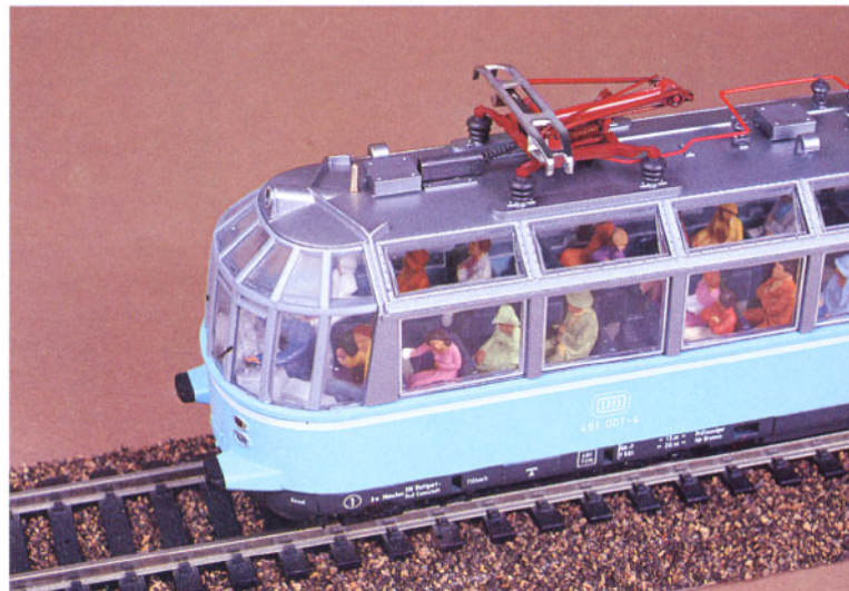
Bild 15: Dem Vorbild entsprechend ist über dem Fahrzeugende 1 ein Einholm-Stromabnehmer montiert. Fotos 12–15: Obermayer
