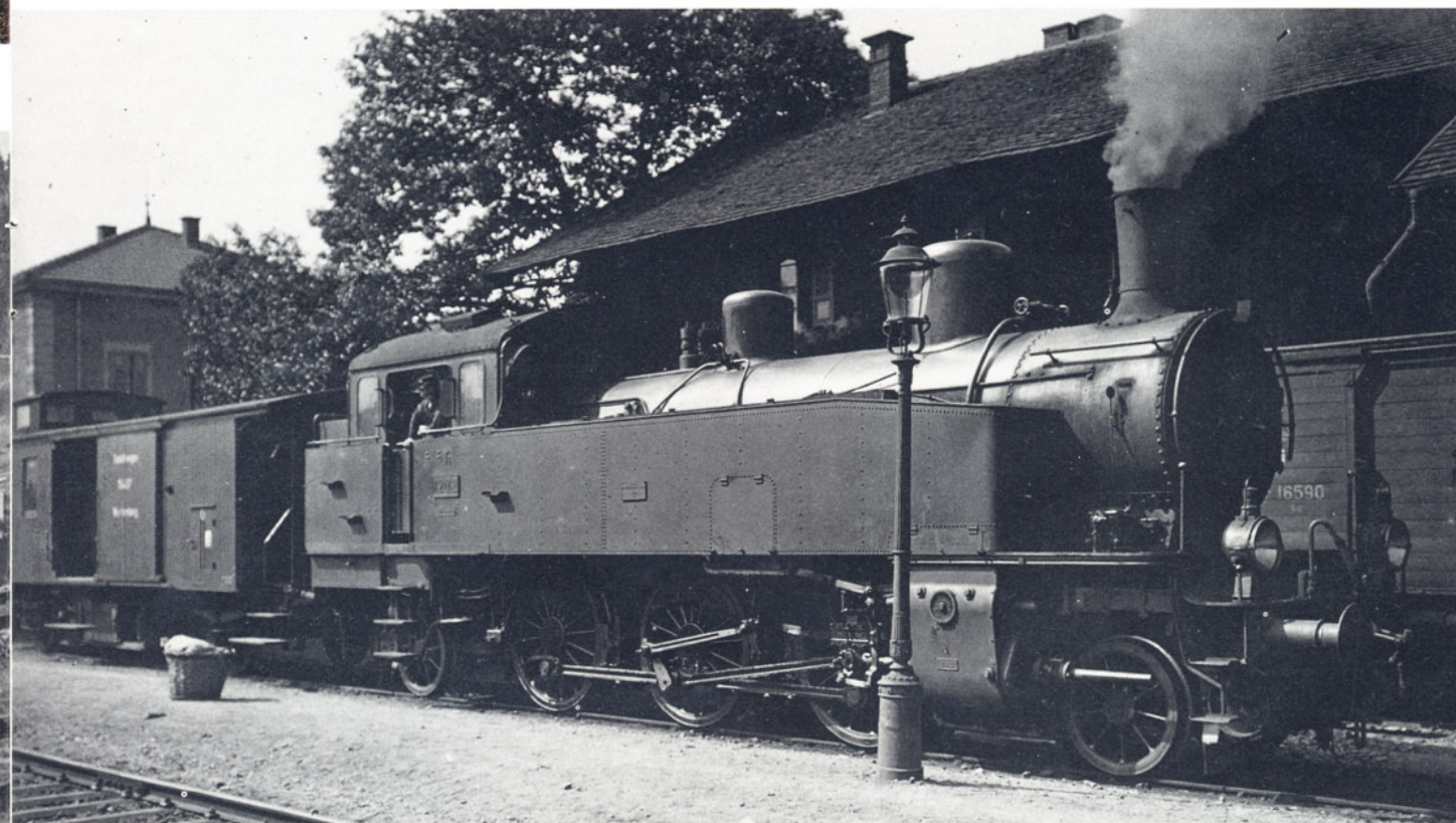
Bild 2: Die württembergische T 5 mit der Bahnnummer 1202 im Lieferzustand. Im Gegensatz zur 75044 in Bild 1 besitzt die von der Deutschen Reichsbahn in 75002 umgezeichnete Lokomotive einen vorne liegenden Dampfdom und einen auf der Kesselmitte angeordneten Sänddom. Das Foto dürfte schon bald nach der im Jahre 1910 erfolgten Lieferung aufgenommen worden sein. Foto: Archiv Deutsches Museum München
