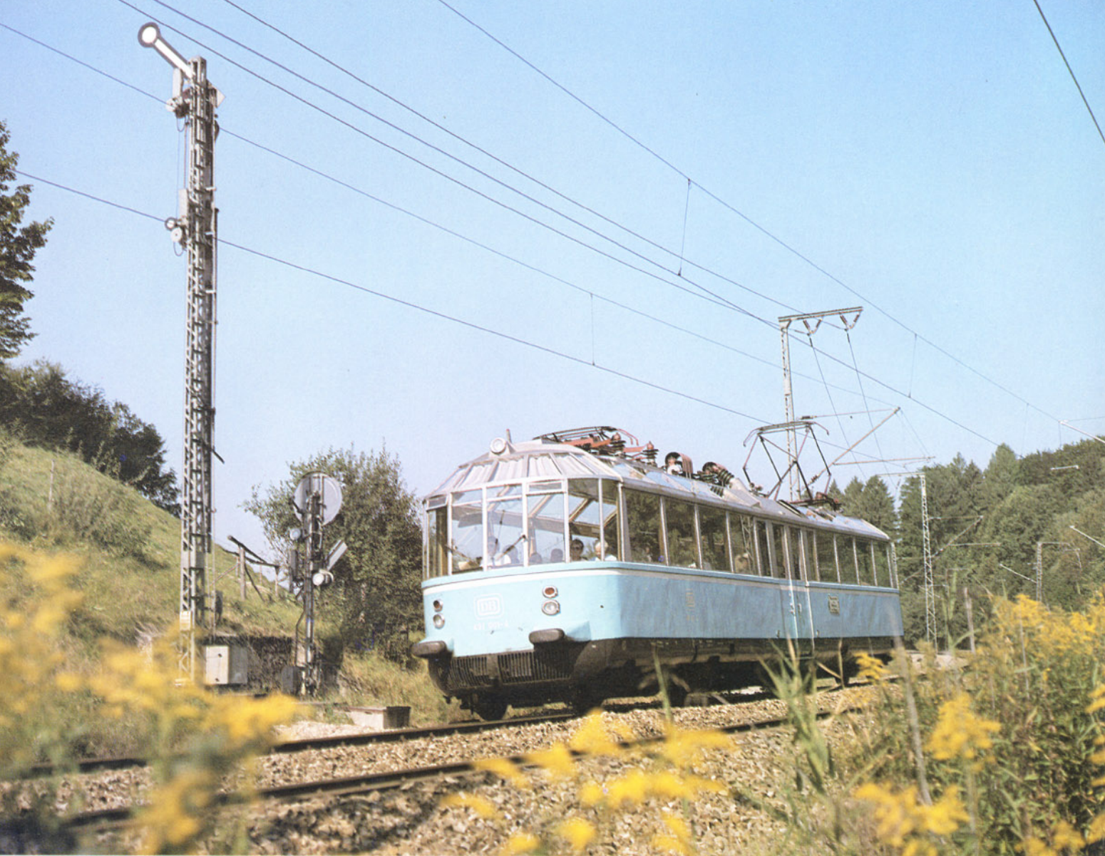
Bild 1: Auf der Fahrt von München nach Garmisch-Partenkirchen hat der 491 001 am 19. 9. 1979 den Bahnhof Hechendorf erreicht. Die Vorhänge hinter der Verglasung der abgeschrägten Dachpartie oberhalb des Triebwagenführers dienen dem Sonnenschutz. Foto: A. Ritz
