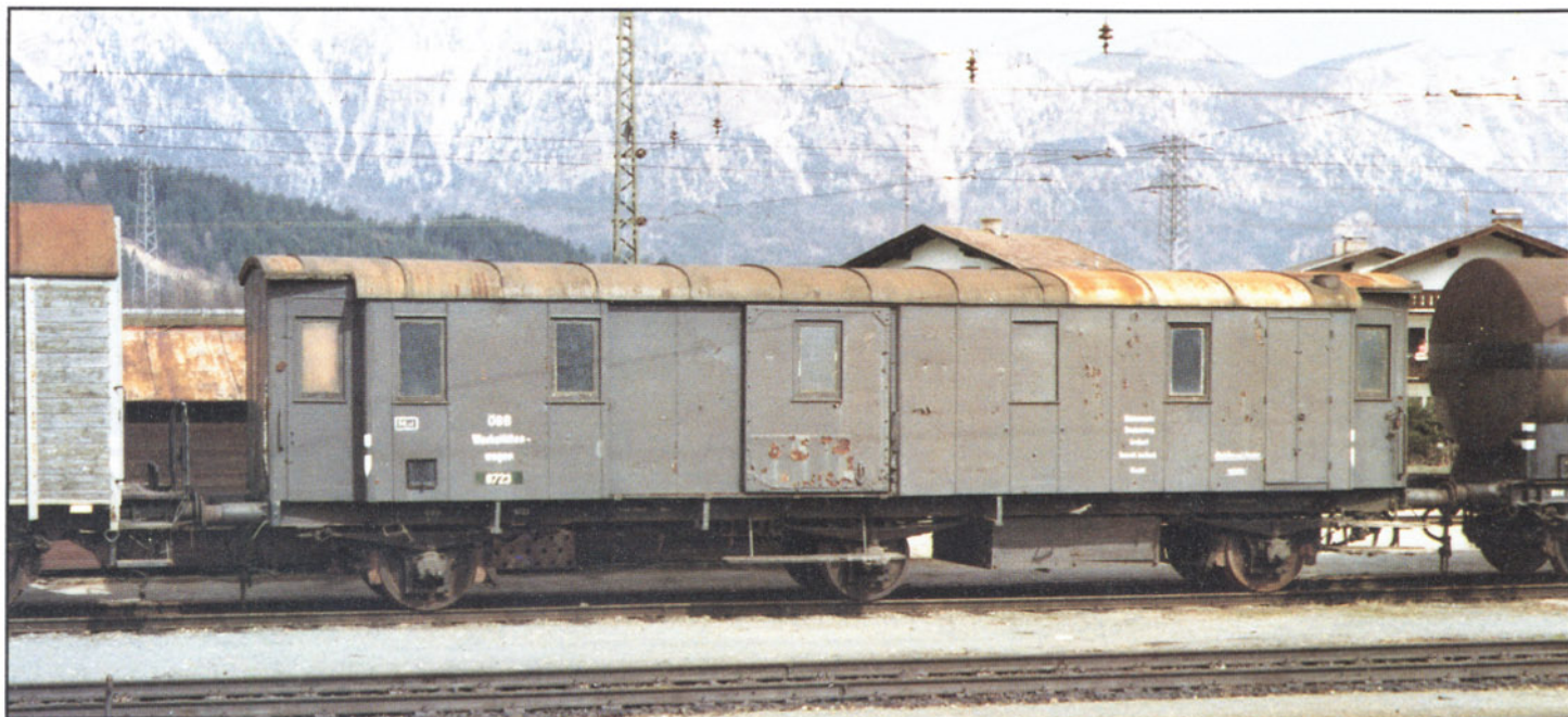
Bild 3: Die ÖBB hatte diesen nach Kriegsende in Tirol verbliebenen Pw3i (Bay95/21) nach einigen Jahren zum Werkstättenwagen 0723 umfunktioniert (5. 4. 1978, Zgfst. Wörgl). Foto: Dr. Hufnagel
