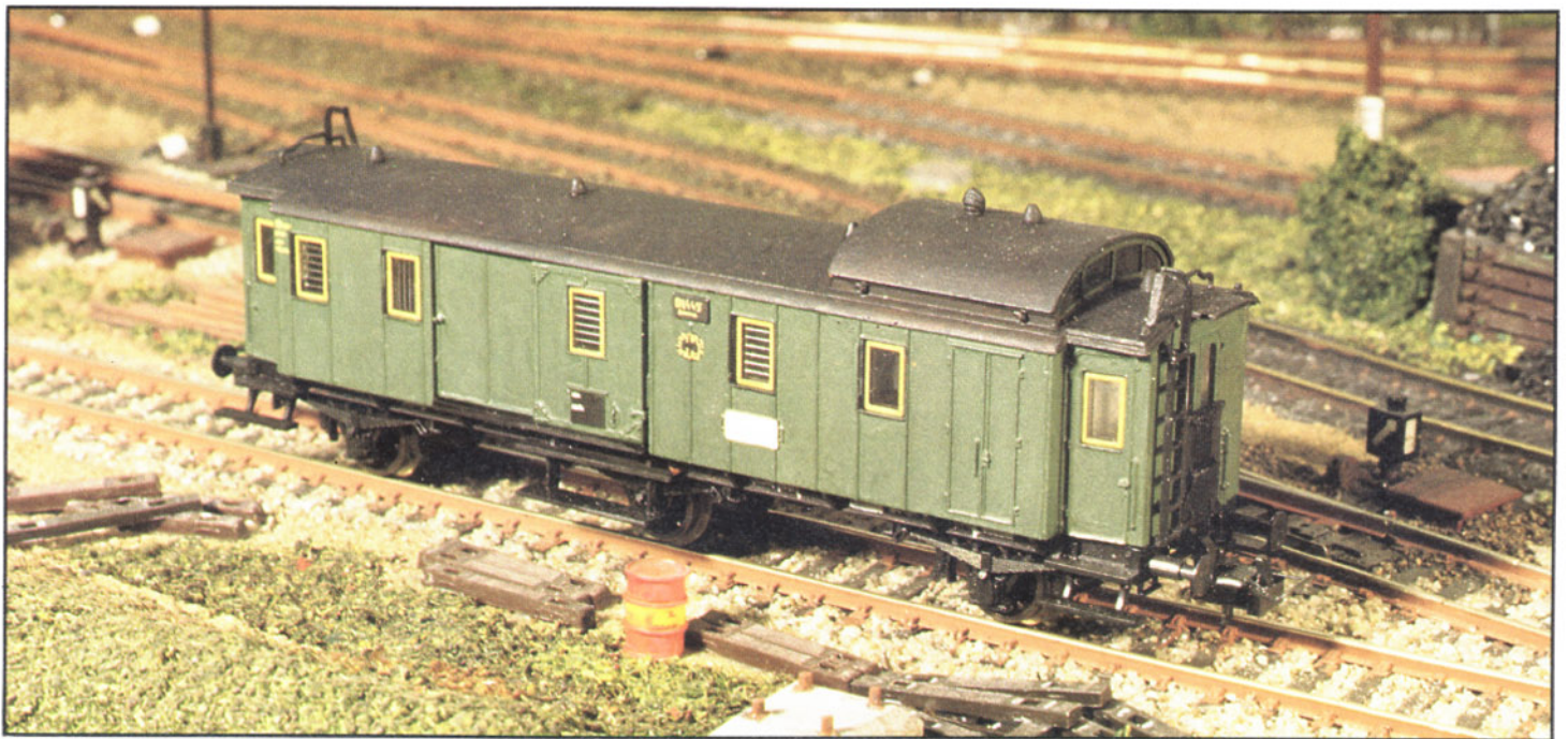
Bild 1: Hier steht der Pw3i (Bay95/21) als H0-Modell. Man sieht, im Gegensatz zur Maßskizze, die rechte Wagenseite.
