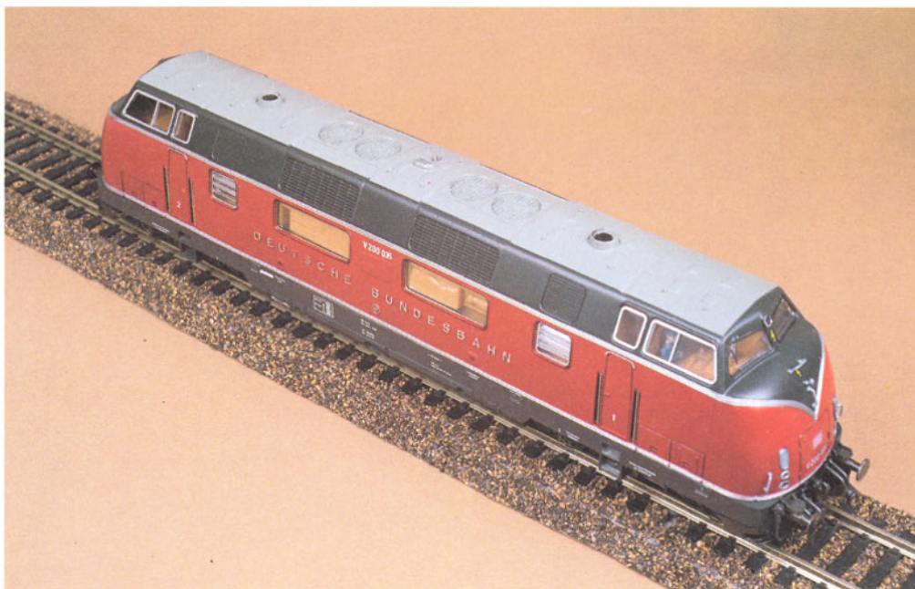
Bild 2: Mit sehr viel Sorgfalt wurde auch die Dachpartie mit den Lüftern der Kühlanlagen gestaltet.
