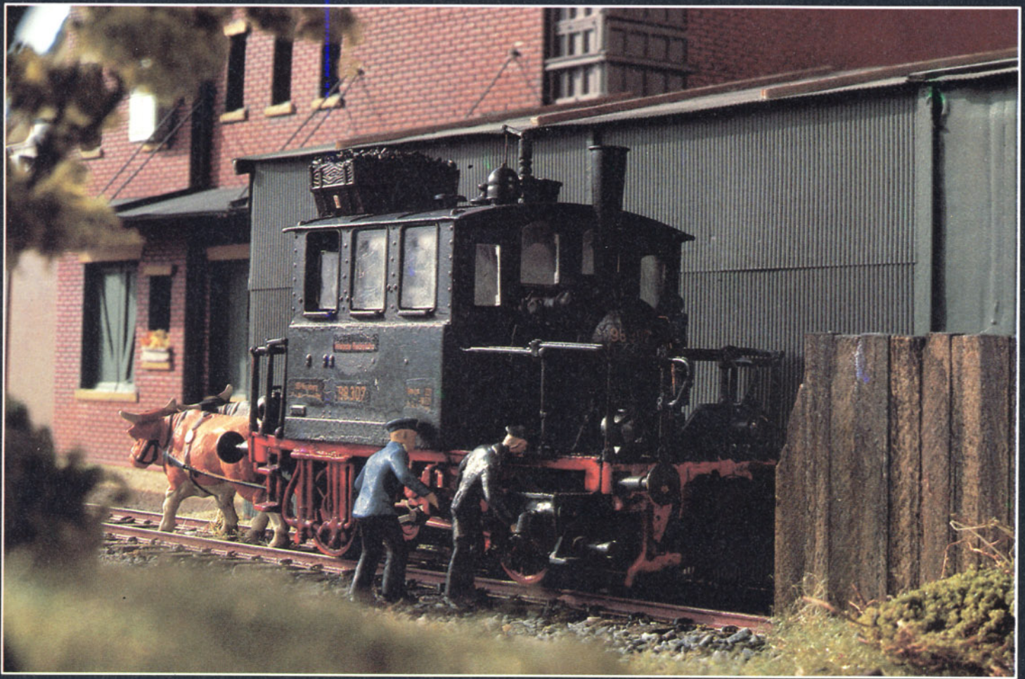
Bild 18: Mit herbeigeholten Ochs, vielen Arbeitern und einer Gleiswinde wurde der Glaskasten wieder auf das Gleis gestellt. Nun sind der Gustl und der Schorsch bemüht, die verbogene Schieberschubstange abzubauen.
