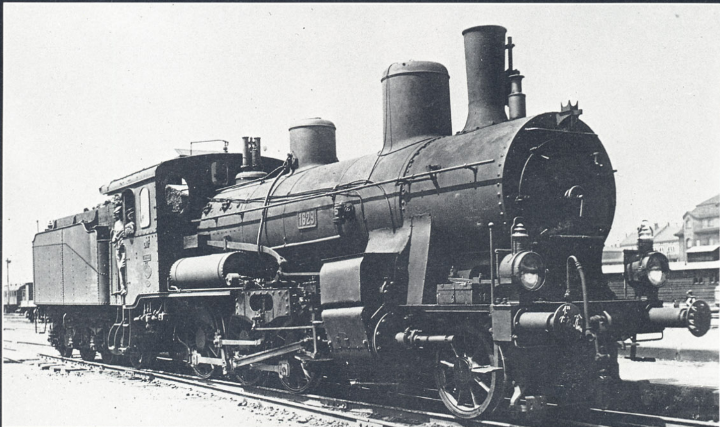
Bild 6: Der letzten Serie der Gattung C VI aus dem Jahre 1905 entstammt die C VI mit der Betriebsnummer 1629 (gebaut von Krauß unter der Fabrik-Nr. 5251). Diese Aufnahme zeigt sie als 54 1363 der Deutschen Reichsbahn. Foto: R. Kallmünzer
