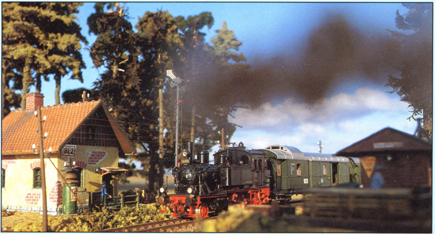
Bild 14: Streckenblockhäuschen an den Bahnlinien waren im vorigen Jahrhundert unerlässlich. Mindestens alle 1500 m waren „Sichttelegraphenstationen“ mit kleineren oder etwas größeren Wärterhäuschen an den Strecken verteilt. Fotos 14–16: W. Kosak
