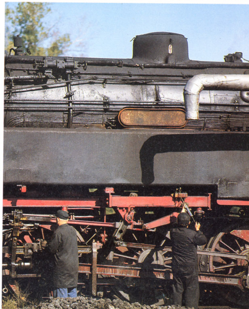
Bild 10: Wer gut schmiert, der gut fährt! Inspektion der 065 013 am 6. 10. 1971 in Miltenberg. Foto: U. Geum
