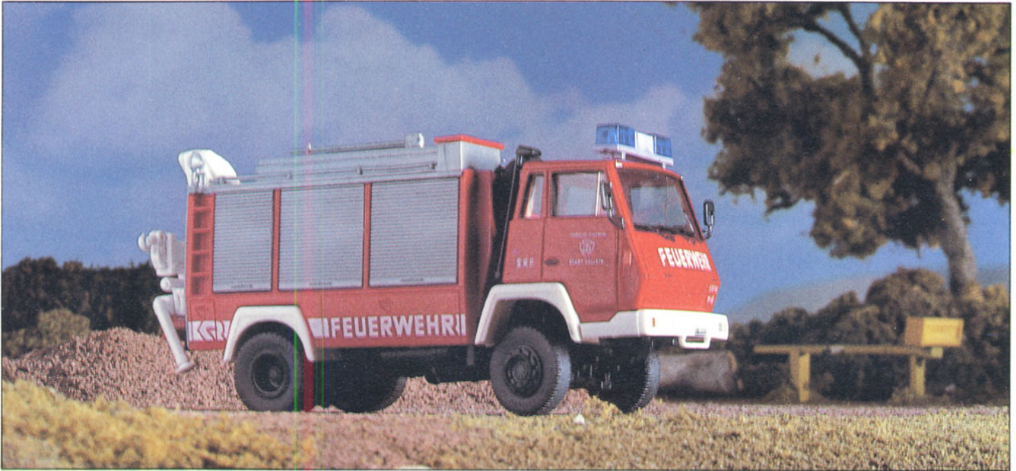
Bild 1: Ein Feuerwehr-Rüstfahrzeug SRF von der Firma Rosenbauer auf dem allradgetriebenen LKW-Fahrwerk der Firma Steyr.
