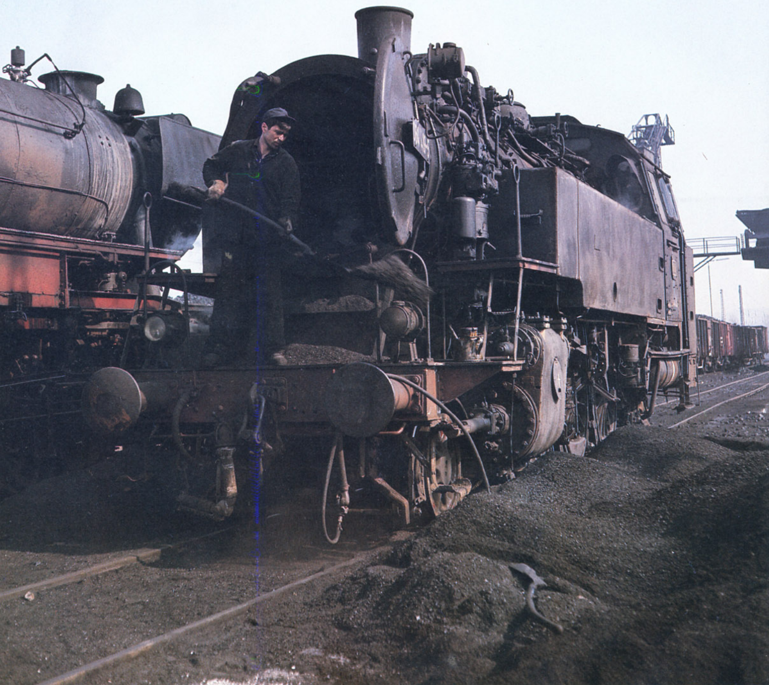
Bild 12: Mit neuen Vorräten war die 064 419 an der letzten Station der Lokbehandlung angekommen. Dort wurde noch die Lösche aus der Rauchkammer entfernt. Alle Fotos: Obermayer
