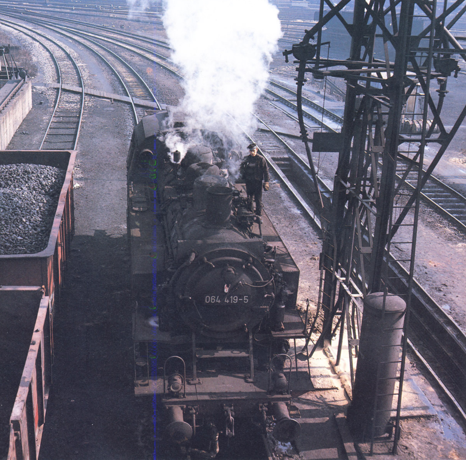
Bild 9: Die aus dem Bahnhof Heilbronn eingefahrene 064 419 befand sich an der ersten Lokbehandlungsstation, der Besandungsanlage.
