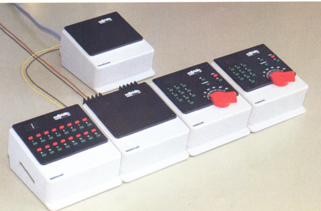
Bild 2: Die wichtigsten Geräte für Märklin Digital H0. Oben der starke Transformator. Unten von links nach rechts das Keyboard, die Steuereinheit und zwei Fahrregler. Foto: Märklin
