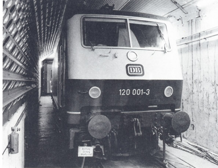
Bild 11: Bald nach ihrer Auslieferung machte die 120 001 der DB ihren ersten Besuch in Österreich. In der Klimakammer der Bundesversuchs- und Forschungsanstalt Wien-Arsenal, die dem UIC-ORE zur Verfügung steht, haben harte Proben stattgefunden. Foto: K. Pfeiffer
