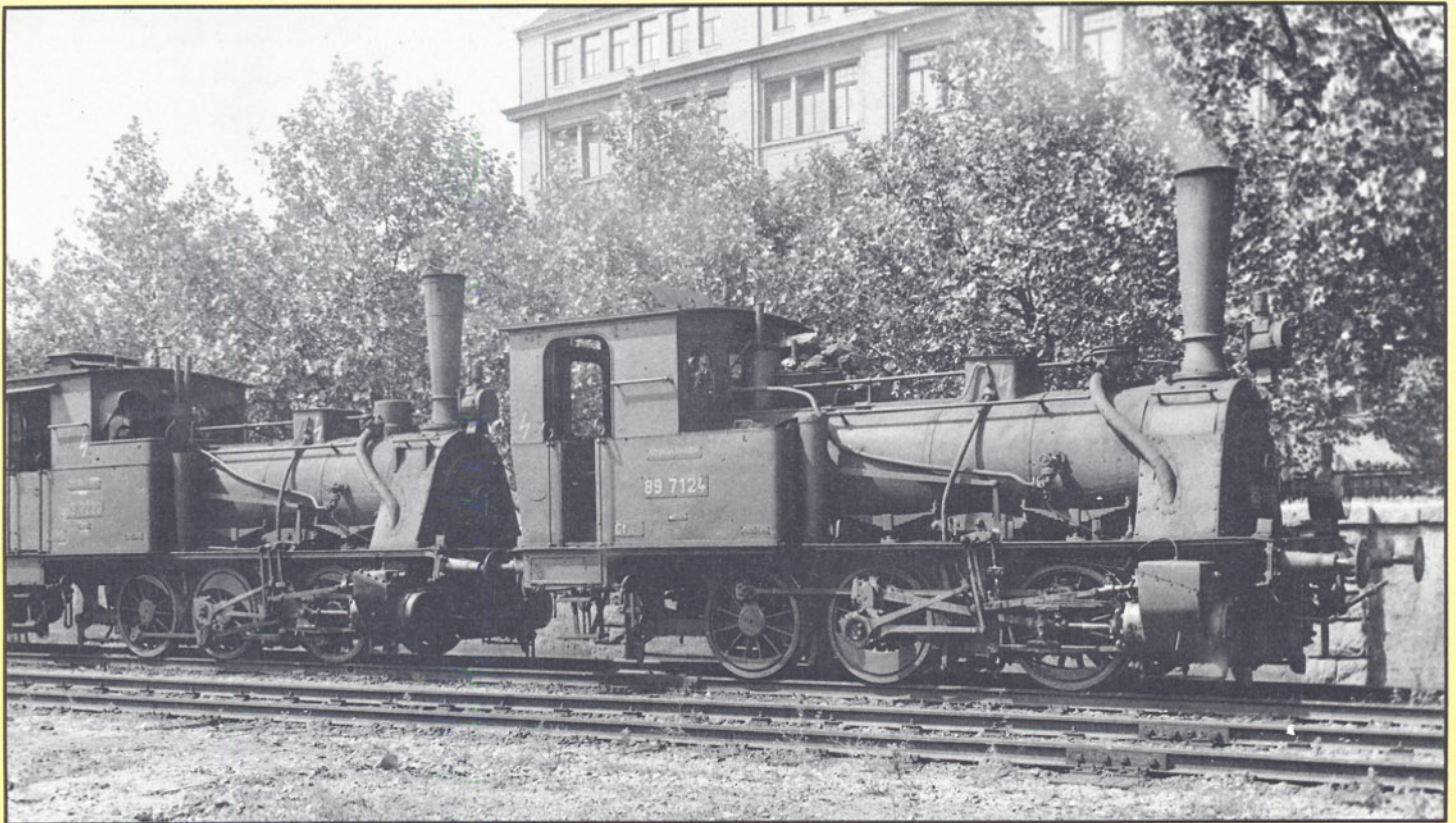
Bild 9: ... die 89 7223 (ex T 3 Osten 6145, gebaut 1896 von Wolf, Fabrik-Nr. 346) und die 89 7124 (ex T 3 Halle 6119, gebaut 1892 von Schichau, Fabrik-Nr. 582). Alle vier Lokomotiven besitzen eine dritte Laterne als Zugspitzensignal. Fotos 8 und 9: W. Kroll, Sammlung Dr. Scheingraber
