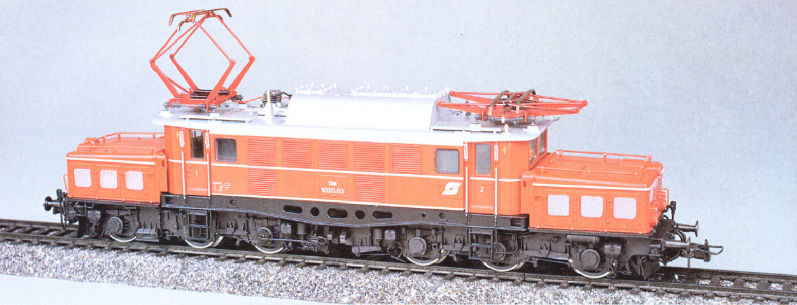
▲ Bild 9: Auch der Rahmen des Drehstells der Reihe 1020 unterscheidet sich von der DB-Ausführung.
