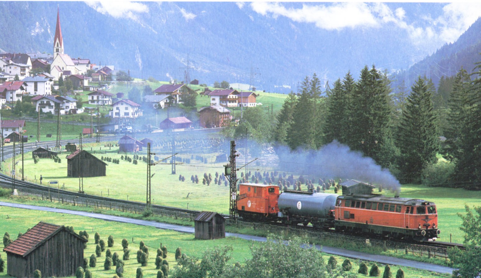
Bild 4: Vorsorglich hinter dem Dampfzug, doch glücklicherweise ohne Einsatz, der Feuerlöschzug für die Ostrampe bei Pettneu: Hinter der Diesellokomotive 2043.45 der Zf. Lienz der 630-hl-Wasserwagen 928.008 und der Schaumlösch-Mischwagen 989.100. Foto: C. Asmus
