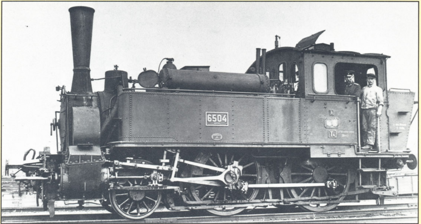
Bild 7: Diese Tenderlokomotive der 1. Berliner Form wurde 1881 von Hohenzollern an die Niederschlesisch-Märkische Eisenbahn geliefert (Fabrik-Nr. 187). Sie wurde dort als 653 in den Listen geführt. Im Jahre 1883 wurde sie in Berlin 1523 und 1905 in (T 4) Mainz 6504 umgezeichnet. Foto: W. Hubert, Sammlung Dr. Scheingraber
