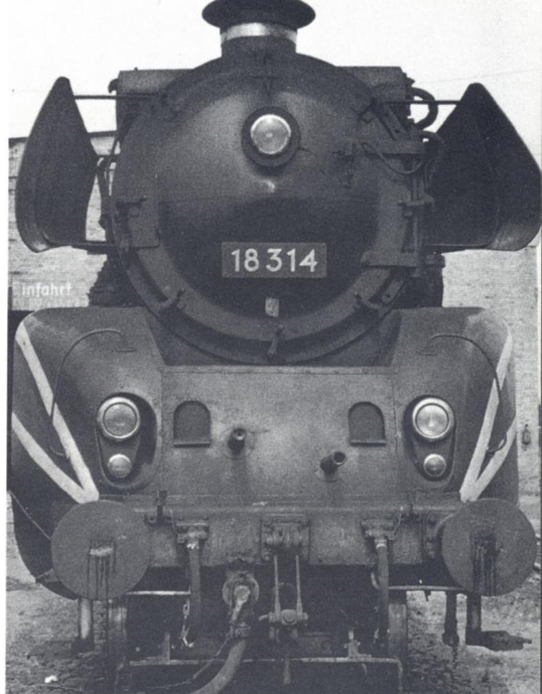
Bild 3: Bei der Rekonstruktion, die 1958 im Raw „7. Oktober“ Zwickau erfolgte, erhielt die 18314 u. a. einen Neubau-Ersatzkessel, Riggenbach-Gegendruckbremse, Oberflächen-Vorwärmer der Bauart Knorr, modifizierte Windleitbleche der Bauart Witte, eine kegelig zulaufende Rauchkammertür sowie einen Caledonia-Schornstein. Die Kesselaufbauten verschwanden unter einer Verkleidung, die vom Sandkasten bis zum Führerhaus reichte. Auch die Zylinderpartie und die Schleppachse erhielt eine windschnittige Verkleidung. Weiße Zierstreifen gaben der Maschine eine elegante Note. Foto: M. Delle
