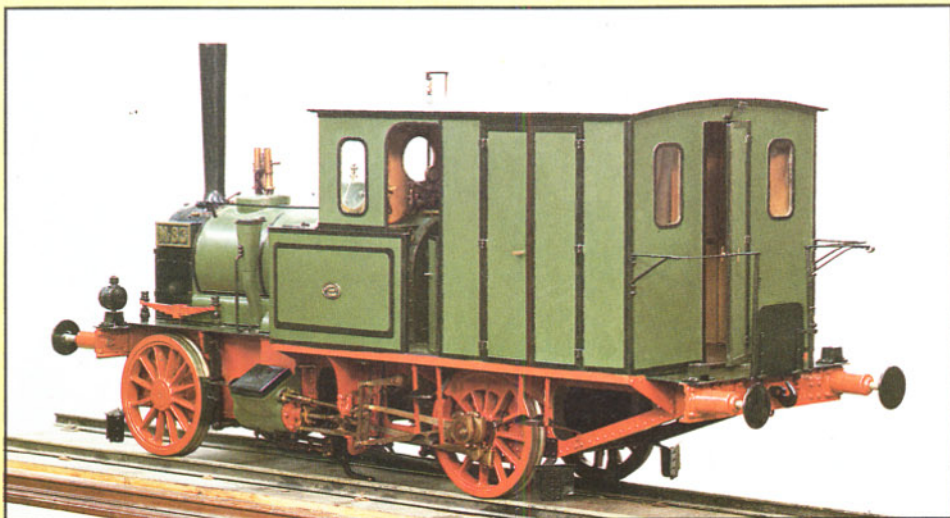
◀ Bild 12: Bei genauerer Betrachtung kann man feststellen, daß das M+F-Handmuster der Gepäcklokomotive nicht in allen Punkten mit diesem Modell im Maßstab 1:5 übereinstimmt. Dies liegt in erster Linie daran, daß die einzigen noch vorhandenen Original-Unterlagen, nach denen das M+F-Handmuster gebaut wurde, nicht vollständig waren.
