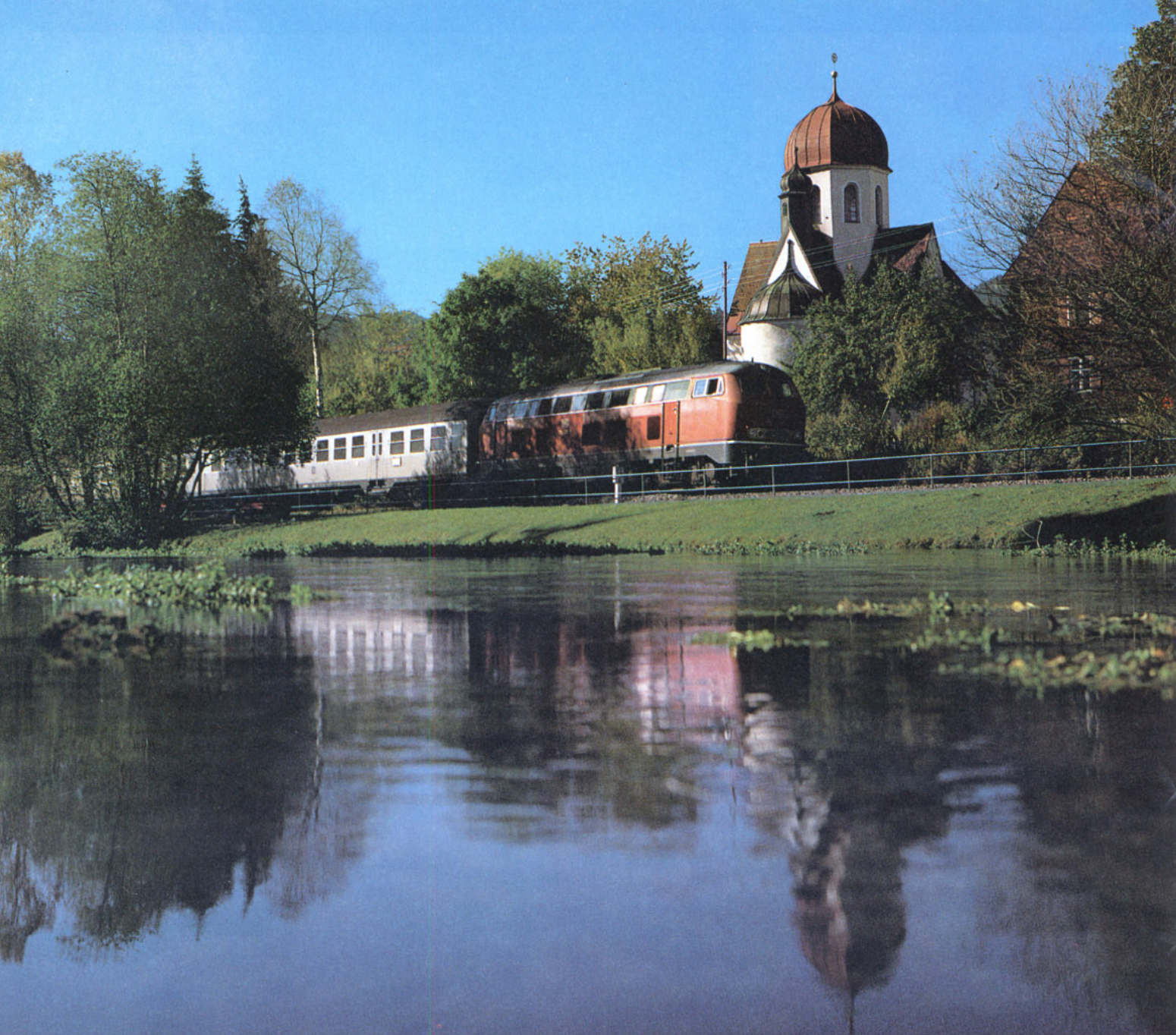
Bild 8: Im Oktober 1980 waren bei einigen Lokomotiven der Baureihe 210 die Abgashutzen auf dem Dach bereits entfernt worden. So auch bei der 210 008, die mit dem Eilzug 3181 soeben aus Fischen (Strecke Oberstdorf – Immenstadt) ausfährt. Foto: A. Ritz
