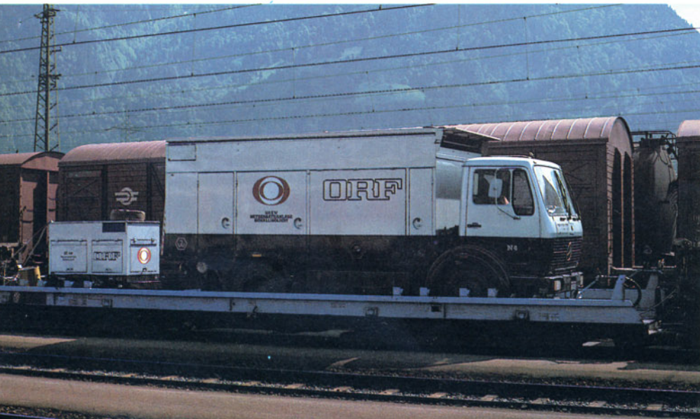
Bild 2: Im Aufbau des Mercedes-LKW des Österreichischen Rundfunks, Fernsehens (ORF), ist eine 100-kW-Netzersatzanlage untergebracht, im einachsigen Anhänger befindet sich eine Netzersatzanlage mit einer Leistung von 20 kW. Foto: A. Ritz
