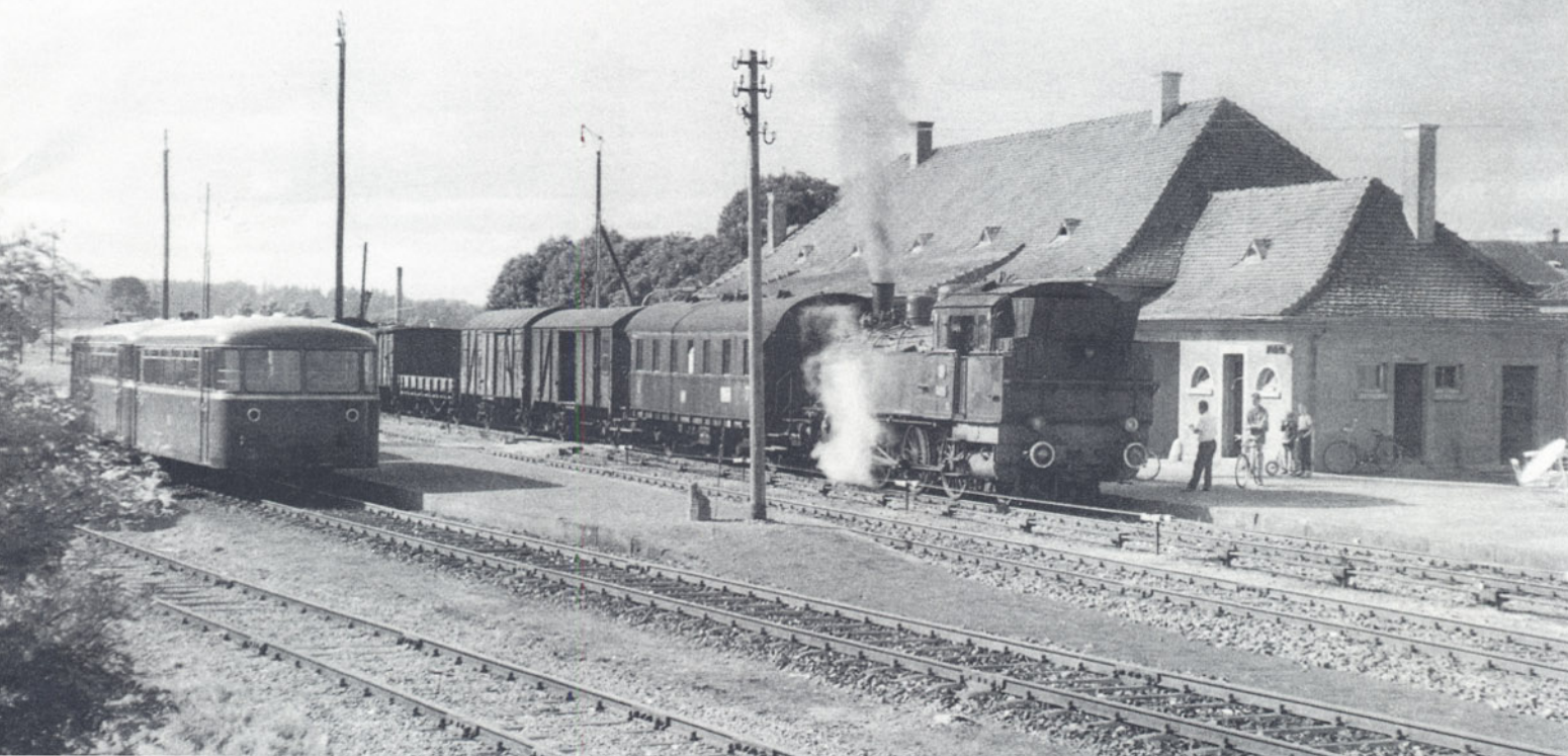
Bild 7: Am Ende ihrer Dienstzeit sah man die Lokomotiven der Baureihe 75 0 oft vor Güterzügen mit Personenbeförderung. Eine solche Garnitur zeigt dieses Bild mit der 75 037, aufgenommen im September 1962 im Bahnhof Pfullendorf.
