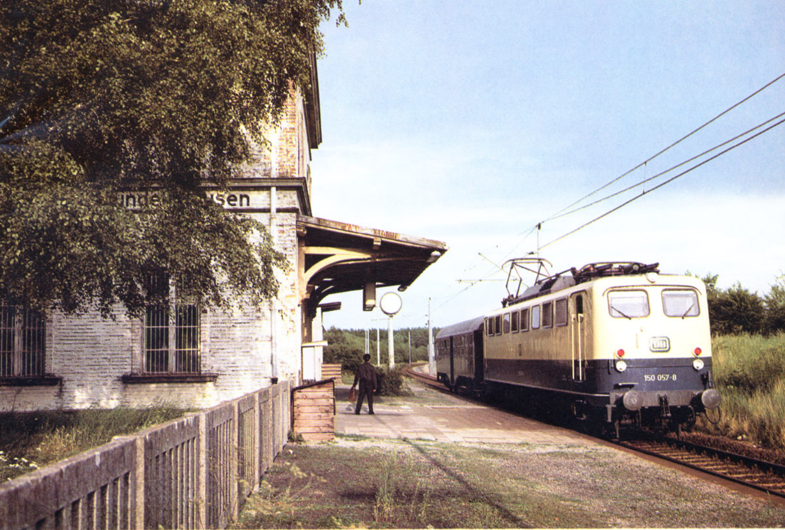
Bild 10: Aus nur einem vierachsigen Umbauwagen bestand am 8. August 1979 der Nahverkehrszug von Saal (Donau) nach Regensburg, der hier beim Halt in Gundelshausen aufgenommen wurde. Die Zuglok 150 057 mußte seit ihrer Ablieferung bereits einige kleine Änderungen, wie z. B. an der Regenrinne, an den Lüfterblenden und an den Griffstangen, über sich ergehen lassen. Foto: W. Matussek (Sammlung Ritz)
