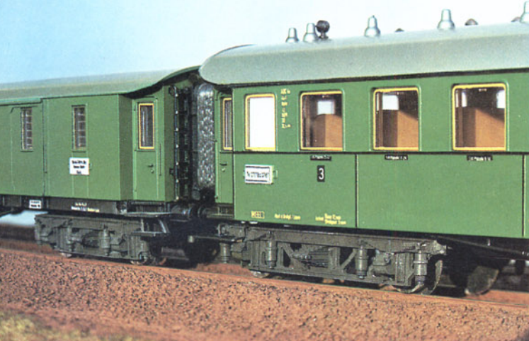
◀ Bild 10 und 11: Neue Drehgestelle, sowie eine vorbildliche und komplette Reichsbahnbeschriftung, liefert seit kurzem der bekannte Beschriftungslieferant Gaßner aus.
