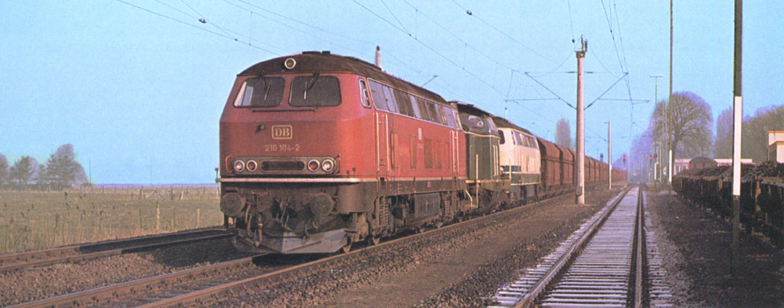
Bild 1: Dreifachtraktionen sind bei der Deutschen Bundesbahn nur mit Ausnahmegenehmigung zulässig. Eine solche wurde für die schweren Erzzüge von Nordenham nach Bremen erteilt, die noch 1980 ab Nordenham mit Diesellokomotiven bespannt wurden. Am 23. Februar 1980 wurde der Gdg 52913 gemeinsam von den Lokomotiven 216 184, 212 248 sowie 216 151 befördert. Das Foto zeigt den Zug im Bahnhof Berne. Foto: J. Hörstel
