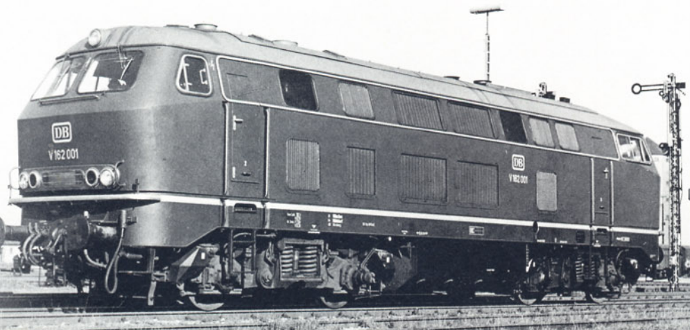
Bild 6: Dies ist die erste Großdiesellokomotive mit elektrischer Zugheizung. Die Lok mit der alten Betriebsnummer V 162 001 war beim Bw Mühldorf der BD München beheimatet. Seit 1968 trägt die Maschine die neue Betriebsnummer 217 001. Foto: BZA München, Sammlung Obermayer
