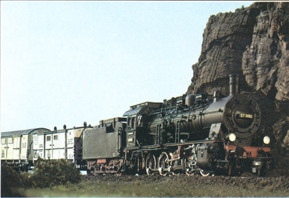
Bild 9: Mit einem dreiaxigen Tender bayerischer Herkunft wurde diese preußische G 10 ausgerüstet. Bei den dahinter befindlichen weißen Wagen handelt es sich keineswegs um Bier- sondern um Milchwagen!
