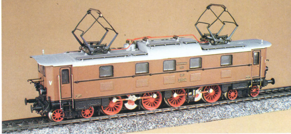
Bild 6: Mit dem Gehäusebausatz von Günther läßt sich auf dem Märklin-Fahrwerk ein solch schmuckes Modell der EP 21 506 aus der früheren Reichsbahnzeit herstellen. Mit dieser Fensterform und den Stirnwandübergängen führen die Maschinen bis zum Umbau in den fünfziger Jahren.
