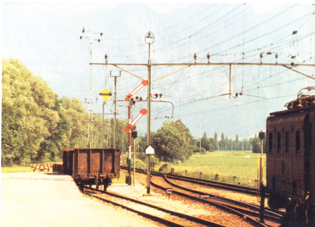
Bild 1: Das zweiflügelige Ausfahrtssignal des Bahnhofs Maienfeld in Richtung Landquart steht, wie heute bei der SBB üblich, links vom Gleis.
