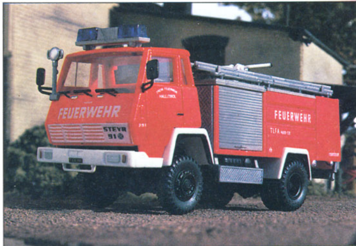
Bild 2: Feuerwehrautos stehen derzeit auch bei Roco hoch im Kurs. Zu dem im Eisenbahn-Journal 1/84 vorgestellten Steyr 91 TLFA 4000 wird nun eine Variante in Tagesleuchtfarbe angeboten. Zudem weist der Wagen anstelle der beiden Rundum-Kennleuchten einen durchgehenden Blaulichtbalken auf. Er kann, wie alle Steyr-Wagen von Roco, nachträglich mit einer Lenkung ausgerüstet werden.
