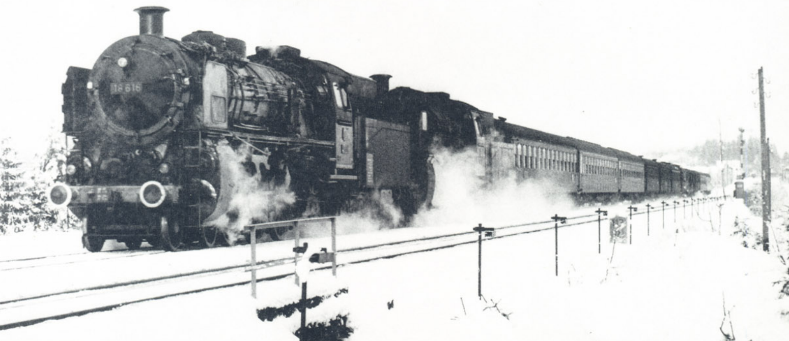
Bild 10: Oftmals waren zwei Schnellzuglokomotiven der bayerischen Gattung S 3/6 mit einer Leistung von zusammengerechnet fast 4000 PS erforderlich, um die schweren Schweizer Schnellzüge über die langen Rampenabschnitte der Allgäubahn zu befördern. Vorspannlok war im Dezember 1960 bei Röthenbach die 18 616.
