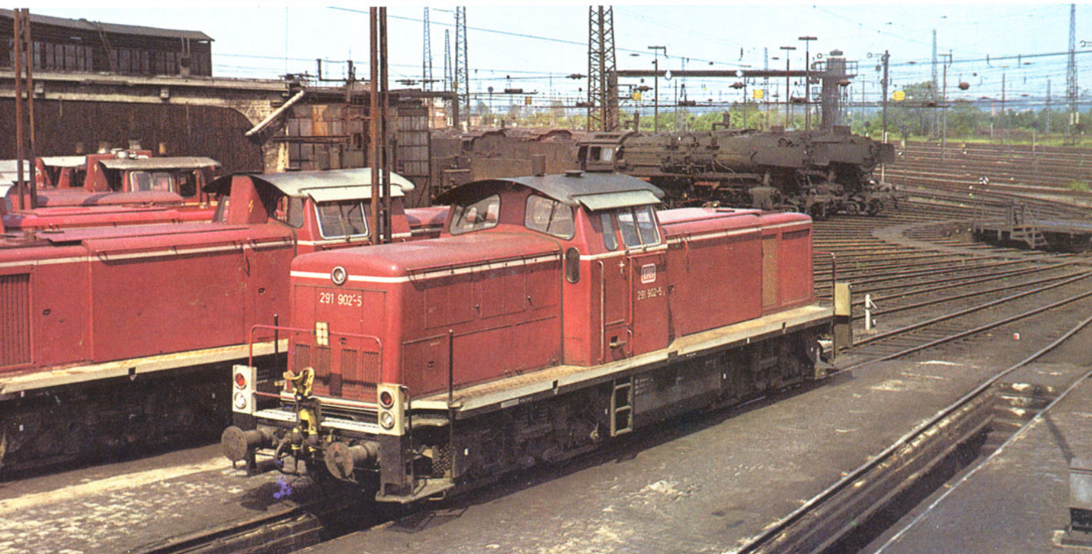
Bild 11: Die 291 902 gehört zu den drei Vorserienmaschinen der Baureihe 291. Die Lokomotiven der Baureihe 291 unterscheiden sich von der Baureihe 290 durch den Achtzylinder-Dieselmotor, der im Schnellgang eine Höchstgeschwindigkeit von 90 km/h ermöglicht. Die Aufnahme entstand am 31. 5. 1971 im Bw Bremen Rbf. Foto: P. Bäuchle
