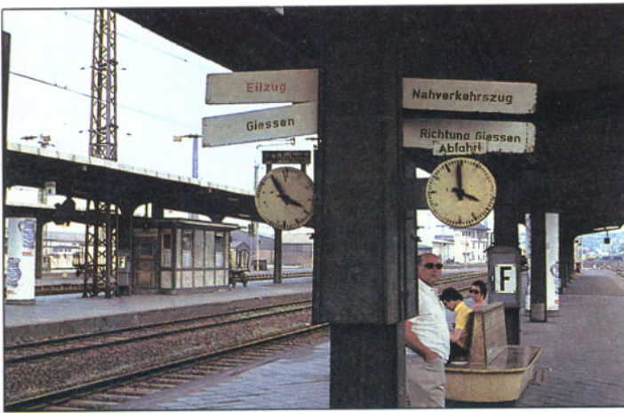
Bild 10: Zuglaufanzeiger älterer Bauart mit Zeitanzeige mittels Zifferblätter (von Hand verstellbare Zeiger). Man beachte auch die Sitzbank und das Häuschen am anderen Bahnsteig. Fotografiert wurde diese Szene im Juni 1975 in Wetzlar. Foto: U. Fetzer
