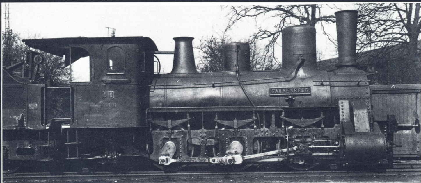
Bild 10: Später wurden die Sigl-C III mit einem bayerischen Ersatzkessel ausgerüstet. Vor allem an ihrem symmetrischen Achsstand konnte man sie auch weiterhin von den C III der Lokomotivfabriken Maffei und Krauss unterscheiden. Die „Fahrenberg“ erhielt bei den Kgl. Bayer. Staatseisenbahnen die Betriebsnummer 600. Gebaut wurde sie als 1874. Lokomotive im Jahre 1874 von Sigl in Wien. Foto: Sammlung Dr. Scheingraber
