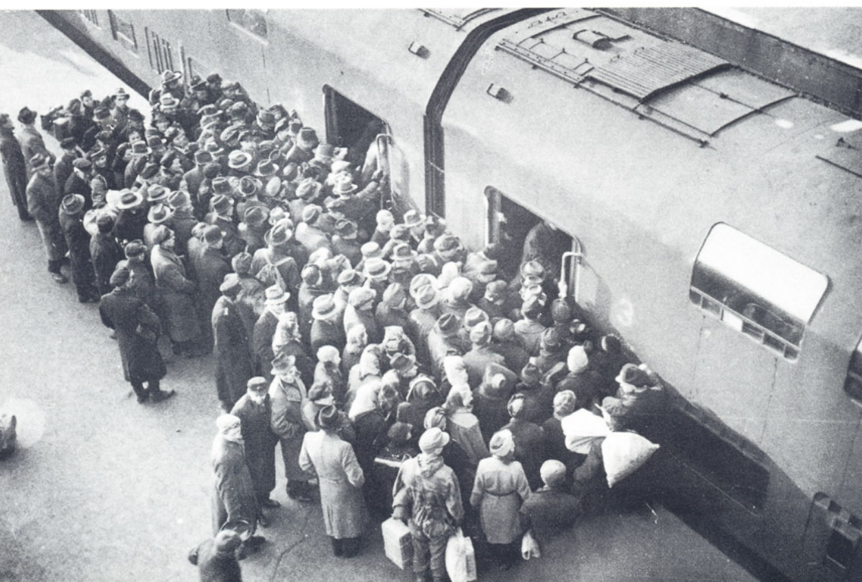
Bild 9: Damals trug man noch Hut! – Kurz nach dem Zweiten Weltkrieg fanden die Doppelstockwagen auch beim Transport von Flüchtlingen Verwendung. Auf dem Dach rechts neben dem Lattenrost sind die Einfüllöffnungen für die Eisstangen zu erkennen. Die Aufnahme entstand im Januar 1946 im Hauptbahnhof Hamburg. Foto: DB, Sammlung Neumann
