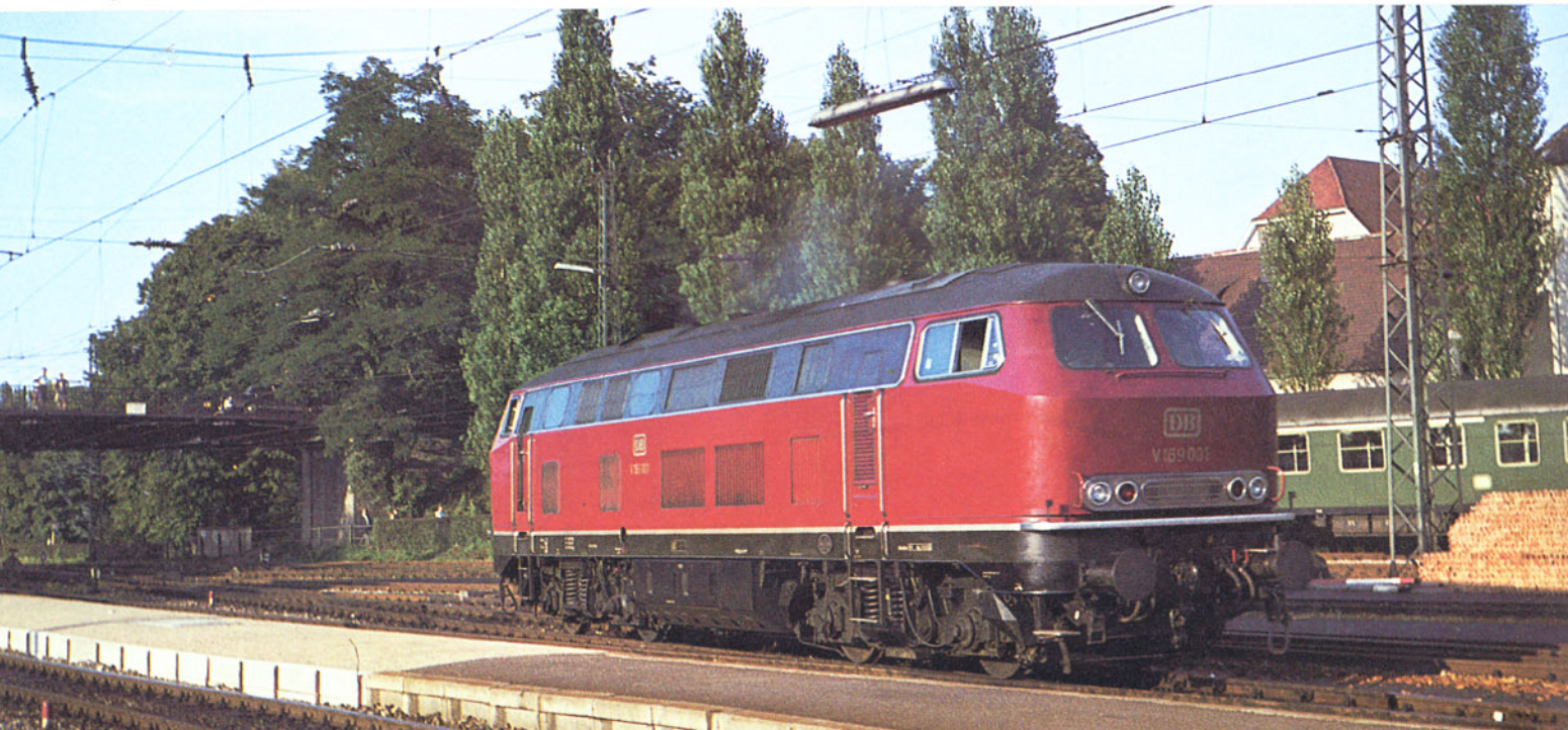
Bild 2: Die V 169 001 wurde zunächst dem Bw Kempten zur Erprobung zugewiesen. Dieses in Lindau aufgenommene Foto vom 24. 8. 1967 zeigt sie bereits mit einer zusätzlichen Luftansaugöffnung in der Führerstandtür. Foto: U. Budde
