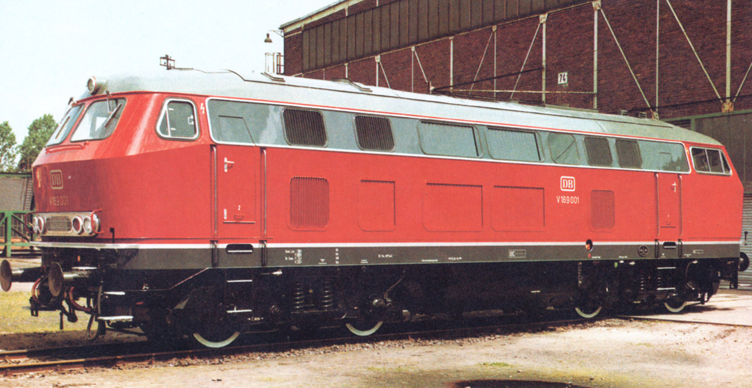
Bild 1: Im Juni 1965 verließ die V 169 001 die Werkhallen von Klöckner-Humboldt-Deutz in Köln. Mit dieser Maschine sollte bei der DB der Einsatz von Gasturbinen erprobt werden. Bei der Ablieferung waren in den Führerstandtüren vorne rechts und hinten links noch keine zusätzlichen Luftansaugöffnungen eingebaut. Werkfoto KHD, Sammlung Obermayer
