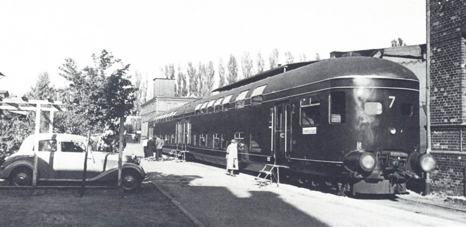
Bild 8: Das Foto zeigt den früheren DW 7 der LBE am 15. 10. 1951 im RAW Lübeck bei der Fahrzeugausstellung „100 Jahre RAW Lübeck“. Obwohl er schon bei der DR die Waggenummer 30007 erhielt, ist die Zahl „7“ an der Stirnfront erhalten geblieben. Der Wagen ist noch mit einer Scharfenbergkupplung ausgerüstet. Er besitzt zwei kleine Stirnfenster (siehe auch Bild 1). Ob im Laufe der fünfziger Jahre alle Doppelstockwagen mit Zierlinien versehen wurden, ist nicht bekannt. Foto: DB, Sammlung Neumann
