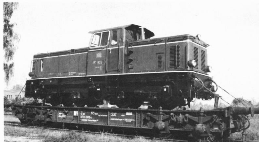
Bild 8: Mit Schmalspur-Transportwagen werden die Schmalspurdieselloks bei fälligen Untersuchungen von Warthausen zum AW Nürnberg transportiert. 251 902 am 7.10.1972 im AW Nürnberg.
