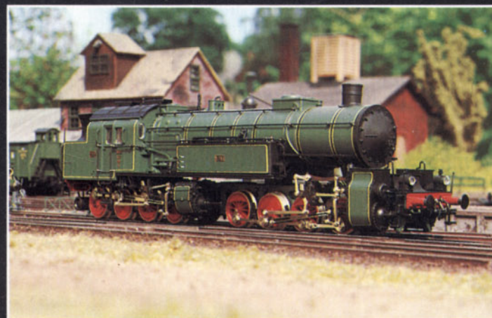
Bild 5: Die Gt 2 x 4/4 von Rivarossi wurde für Stellrampenbetrieb sowohl als zusätzliche Schiebelokomotive wie auch als Zugmaschine verwendet.
