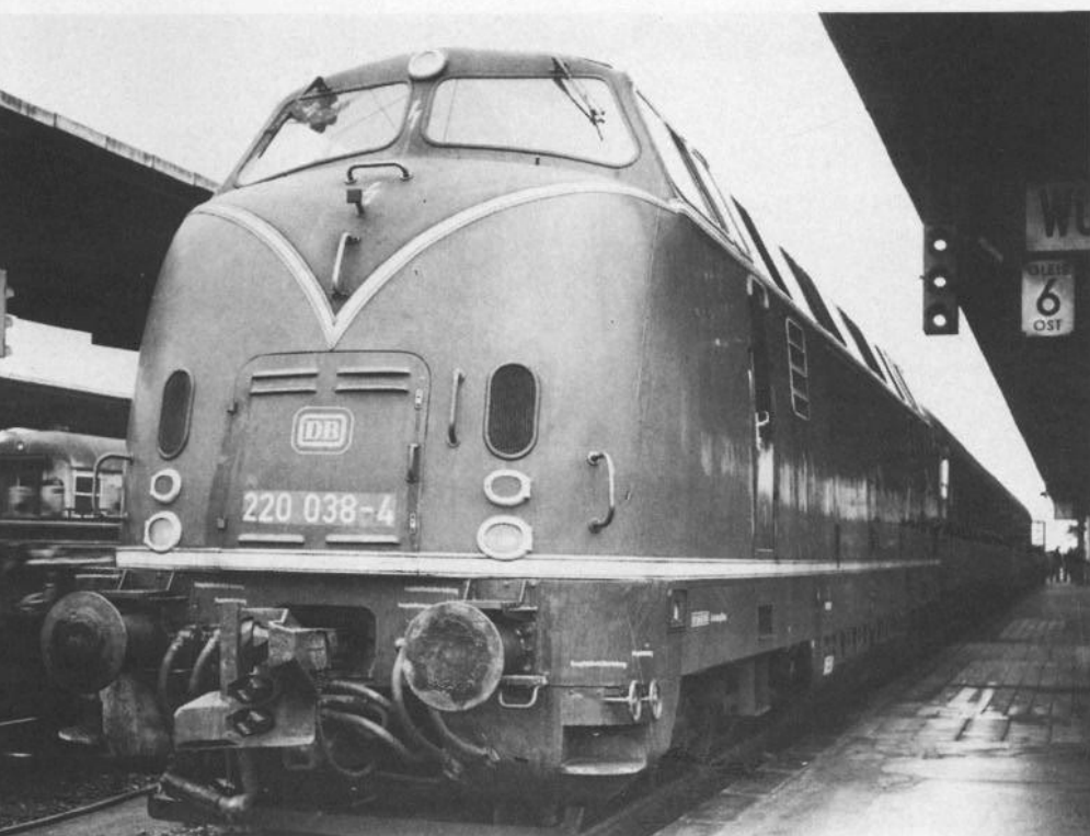
Bild 8: Ende der sechziger Jahre wurde die 220 038 als erste Lok mit der automatischen Einheitskupplung ausgerüstet, um diese Kupplung im Betriebseinsatz zu erproben.
