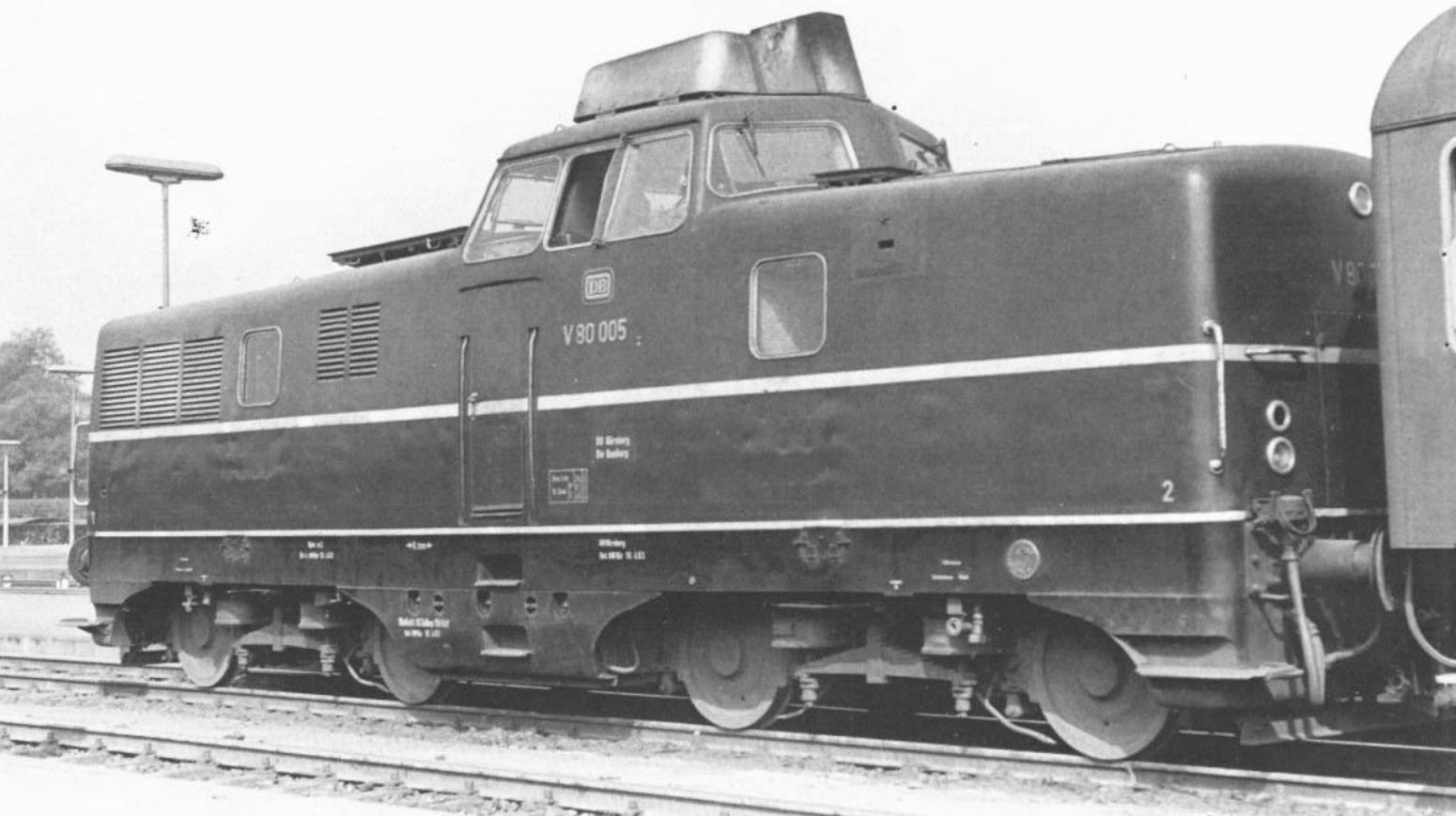
Bild 13: Umfangreiche Versuche wurden vorgenommen, um die V 80 leiser zu machen. Die mit großen Hauben als Schalldämpfer ausgerüsteten V 80 erhielten dafür neben der Loknummer das Begrenzungszeichen. Hier die V 80 005 am 13.8.1964 im Hauptbahnhof Schweinfurt. Foto: K.-D. Holzborn
