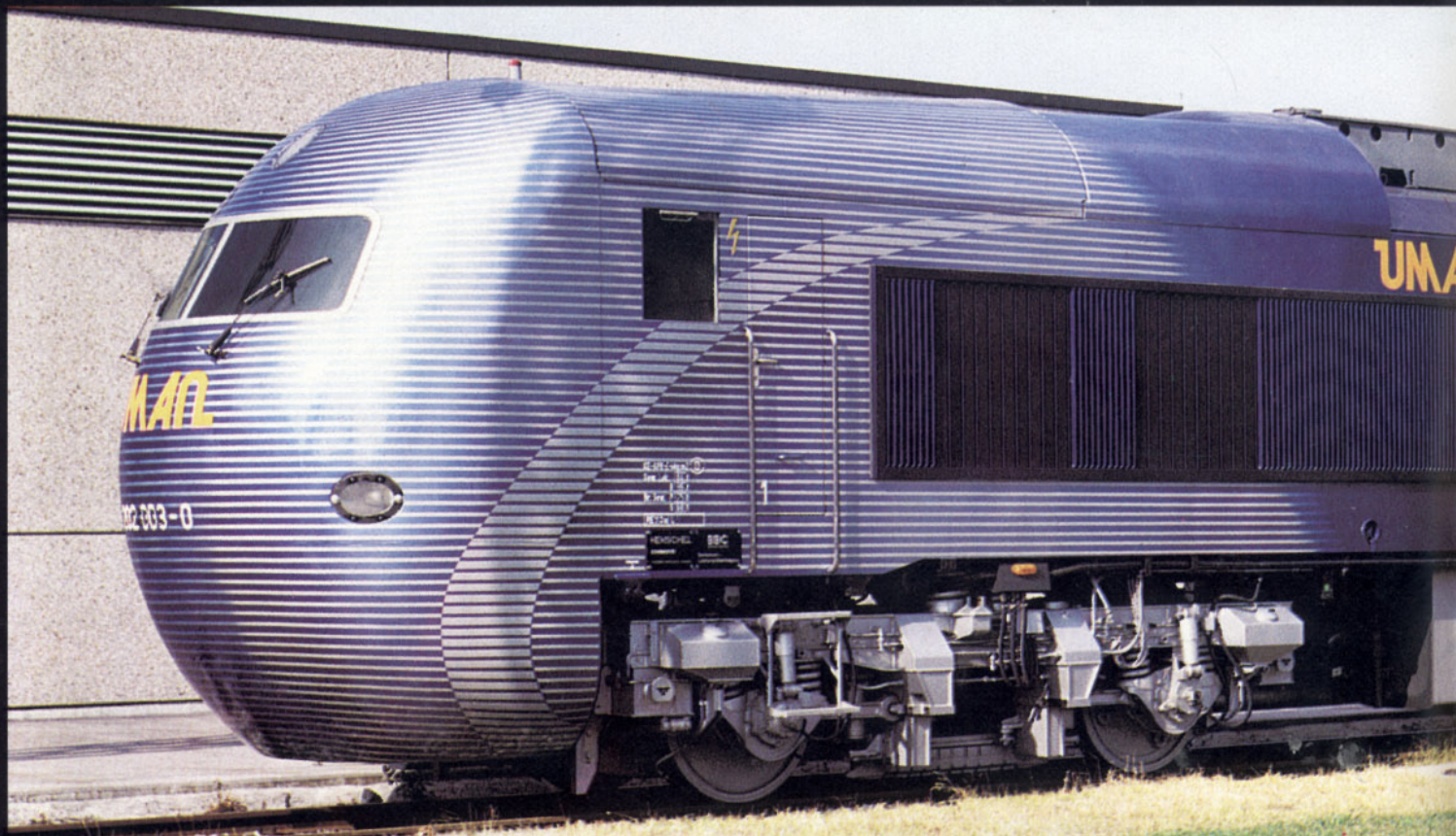
Bild 2: Ebenfalls bei der Jubiläumsausstellung des BZA München entstand diese Aufnahme. Sie zeigt, daß der zweite Führerstand der 202 002 nicht geändert wurde, sondern ganz der von früher bekannten Ausführung entspricht.
