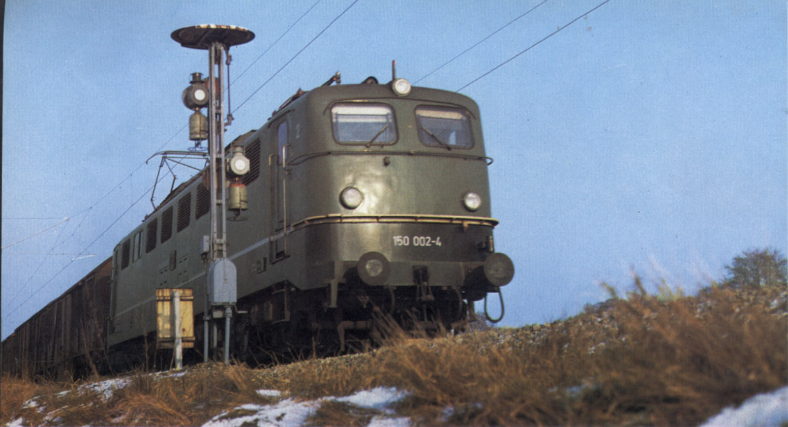
Bild 12: »Fahrt erwarten« signalisiert das Vorsignal bei Paindorf dem Lokführer der 150 002, die mit einem Durchgangsgüterzug von Würzburg nach München unterwegs ist. Aufnahmetag war der 3.2.1982. Foto: A. Ritz
