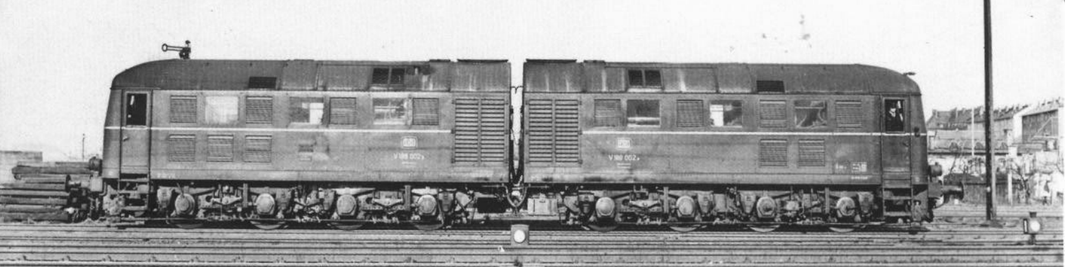
Bild 11: Sehr schön sichtbar ist hier der Übergang zwischen den beiden Lokomotiven V 188 002 a und V 188 002 b. Bw Bamberg am 2.4.1966. Foto: W. Hanold
