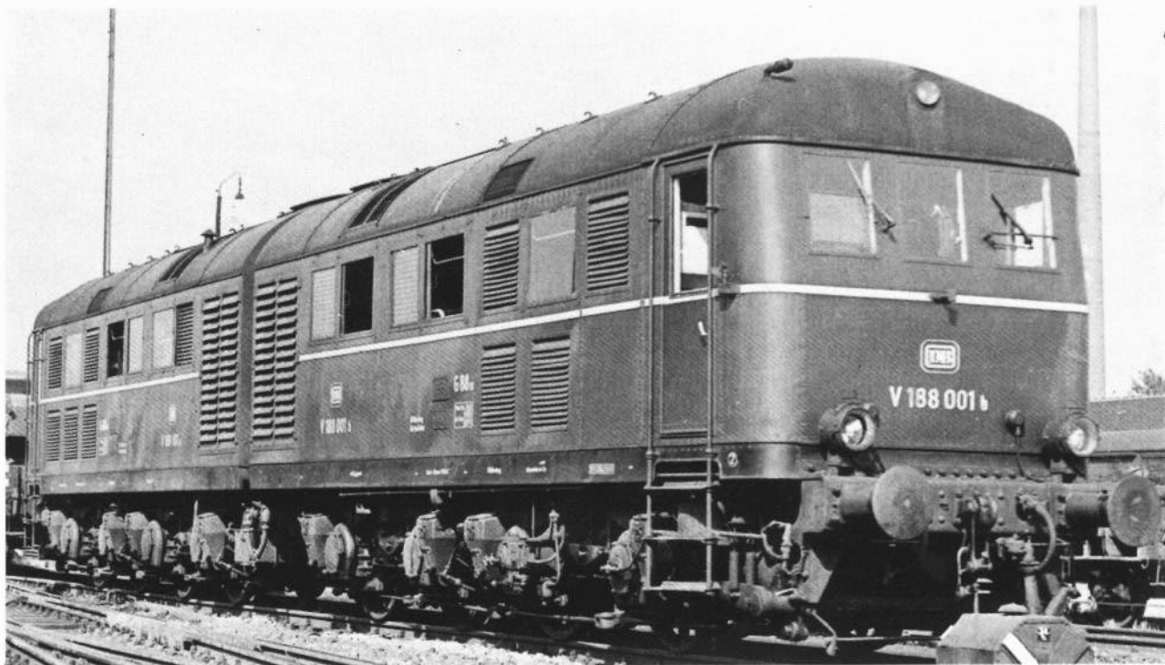
Bild 11: Sehr schön sichtbar ist hier der Übergang zwischen den beiden Lokomotiven V 188 002 a und V 188 002 b. Bw Bamberg am 2.4.1966. Foto: W. Hanold
