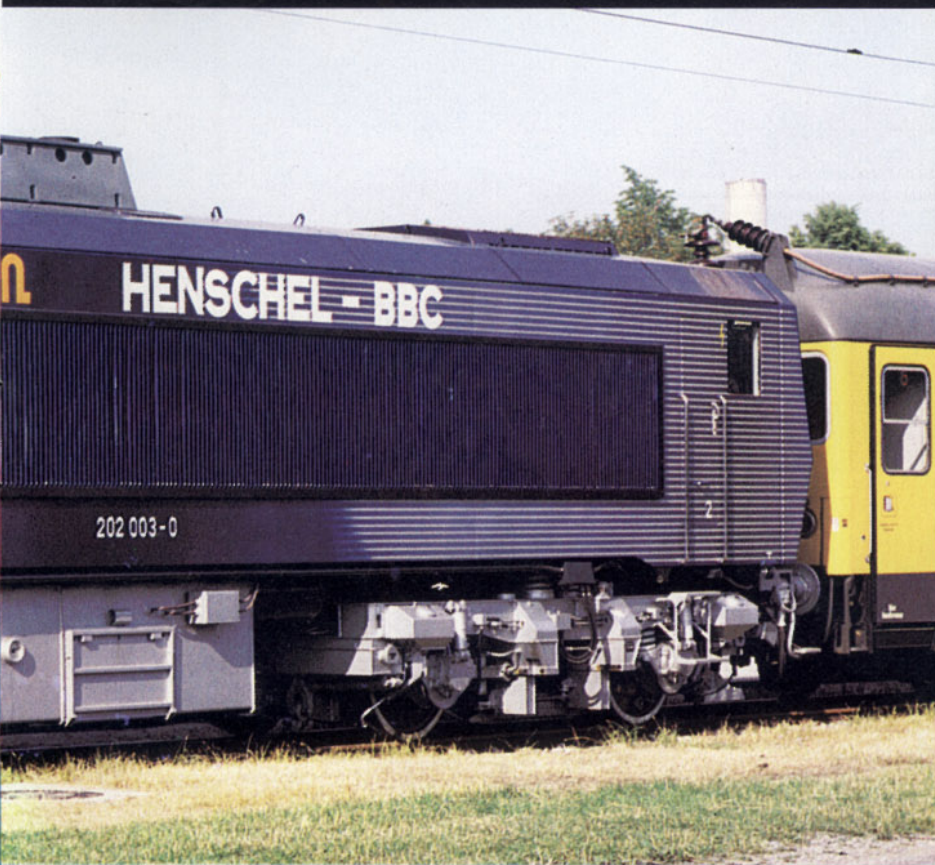
Bild 1: Das ist die neue 202 003 mit den Hochgeschwindigkeitsdrehgestellen und der einseitigen, stromlinienförmigen Verkleidung des Führerstandes. Sehr gut sichtbar ist auf diesem Foto auch die interessante Lackierung des Versuchsfahrzeugs. Foto: Th. Wunschel
