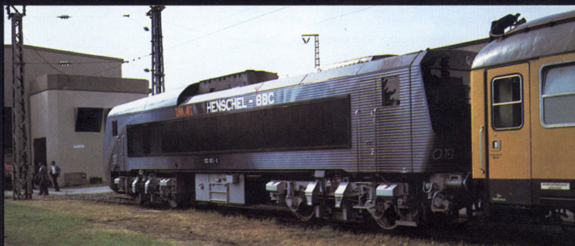
Bild 2: Ebenfalls bei der Jubiläumsausstellung des BZA München entstand diese Aufnahme. Sie zeigt, daß der zweite Führerstand der 202 002 nicht geändert wurde, sondern ganz der von früher bekannten Ausführung entspricht.
