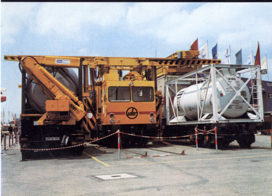
Bild 6: Transport '82 in München: Mit dem Schienenfahrzeug in der Mitte können Container sowohl umgeladen als auch zugestellt werden. Foto: A. Ritz
