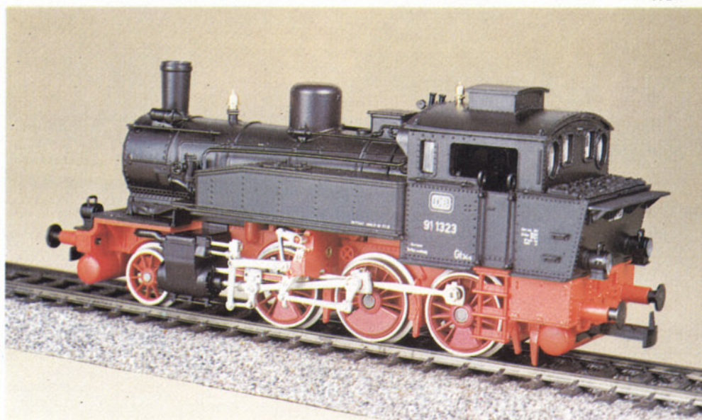
Bild 4: Das Gehäuse der kleinen Lok ist ganz aus Metall-Druckguß gefertigt, hieraus resultiert ein hohes Reibungsgewicht.
