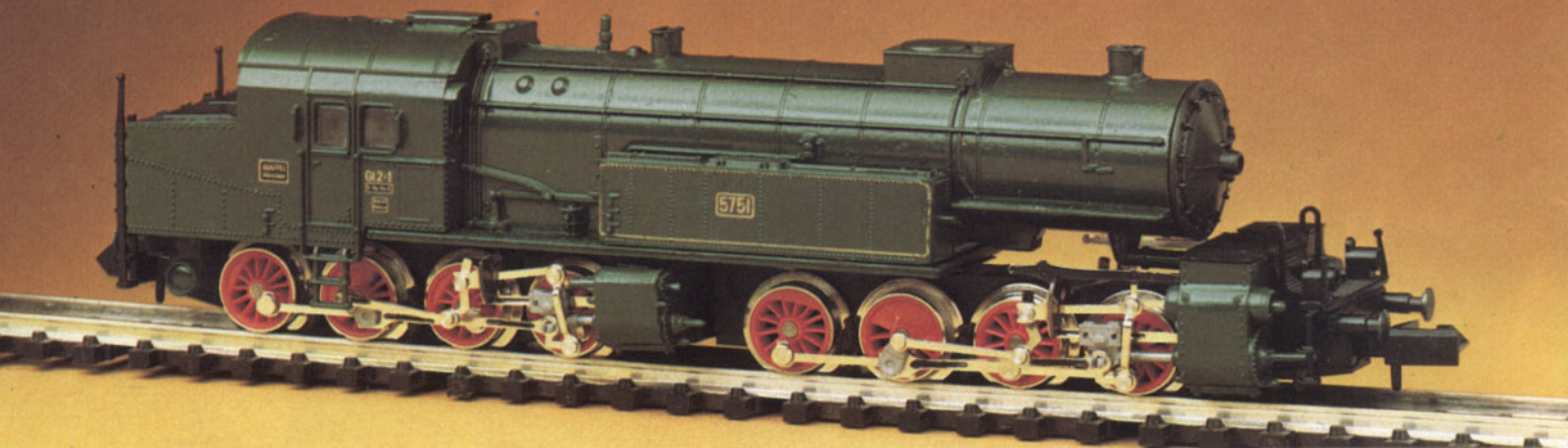
Bild 1: Die bayerische Gt 2 x 4/4 von Arnold, jetzt im neuen schmunken Farbleid der Länderbahnversion. Auf der Heizerseite wurde die doppelte Verbundpumpe gegen eine einfache ausgetauscht.
