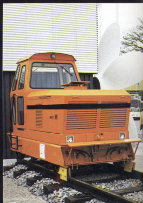
Bild 4: Auf der Hannovermesse erstmalig vorgestellt wurde dieses Weichenpflegefahrzeug der Maxhütte, das fernsteuerbar mit Heißwasser die Weichen reinigt und anschließend mit Fließfett schmiert.
