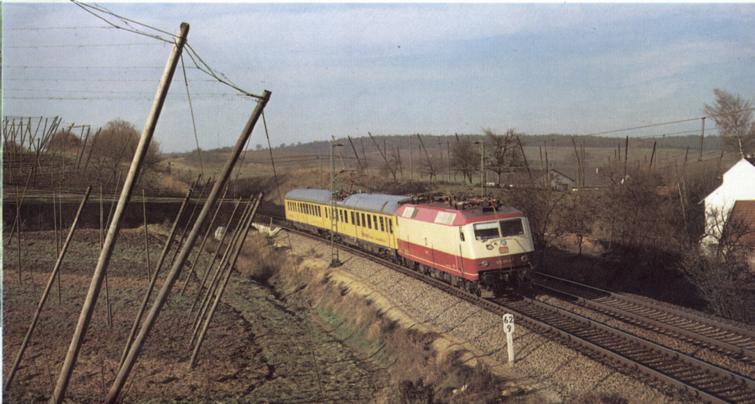
Bild 11: Bei Meßfahrten benützte auch die neue Drehstromlokomotive der Baureihe 120 schon die Hauptstrecke München—Ingolstadt. 120 004 mit zwei Meßwagen am 24.11.1980 zwischen Hög und Wolnzach. Die 120 004 bezog bei dieser Fahrt den Fahrstrom übrigens über den Einholm-Stromabnehmer des ersten Meßwagens.
