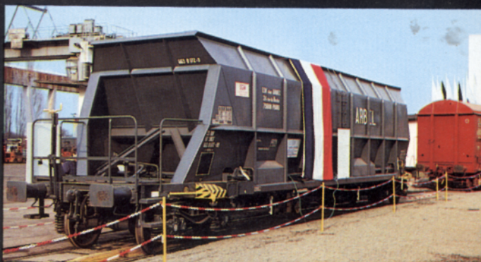
Bild 3: Drehgestellwagen zum Transport von Kohle, Typ Fads, mit automatischem Selbstentladesystem und 75,5 m 3 Fassungsvermögen.
