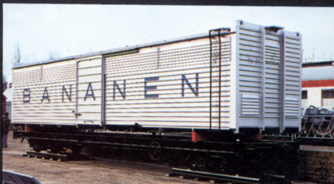
Bild 5: Vierachsiger kombinierter Bananentransporter aus dem VEB Waggonbau Niesky für 914 mm Spurweite. Der Wagenkasten ist abnehmbar, der Tragwagen dann für den Transport von 40-Fuß-Containern einsetzbar.
