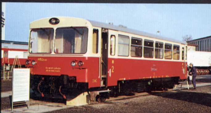
Bild 2: CSD-Triebwagen der Baureihe M 152.0 für Nebenstrecken in Leichtstahlbauweise. Antriebsaggregat ist ein Skoda-Dieselmotor Typ ML 634 mit 210 PS bei 2150 min -1 . Die Kraftübertragung erfolgt über ein hydromechanisches Getriebe und Gelenkwelle.
