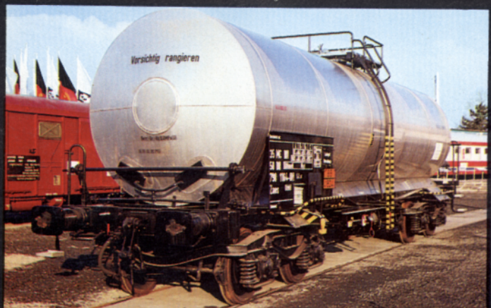
Bild 4: Morgentoilette für den 4achsigen Maschinenkühlwagen aus dem VEB Waggonbau Dessau. Der für die SZD bestimmte Wagen vom Typ MK 4-424-82 dient zum Transport leichtverderblicher Güter. Einstellbare Laderaumtemperaturen von -20° bis + 14°.
