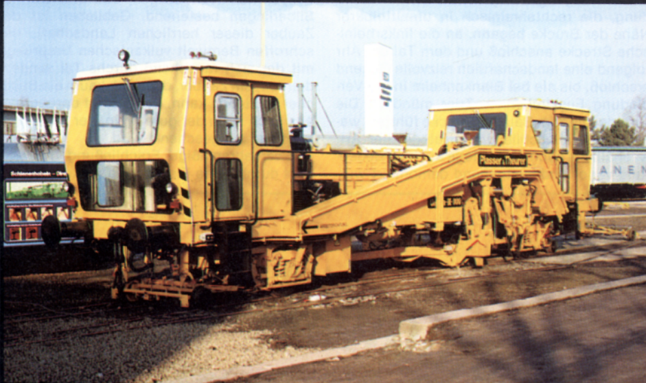
Bild 9: Nivellier-, Stopf- und Richtmaschine UNIMA III-800 für Weichen, Kreuzungen und Gleise von Plasser & Theurer.
