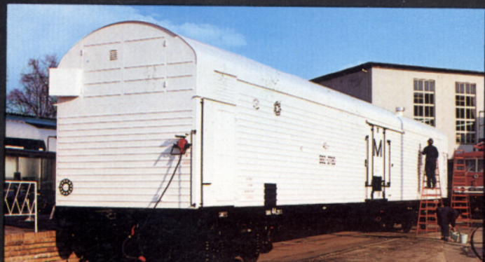
Bild 4: Morgentoilette für den 4achsigen Maschinenkühlwagen aus dem VEB Waggonbau Dessau. Der für die SZD bestimmte Wagen vom Typ MK 4-424-82 dient zum Transport leichtverderblicher Güter. Einstellbare Laderaumtemperaturen von -20° bis + 14°.
