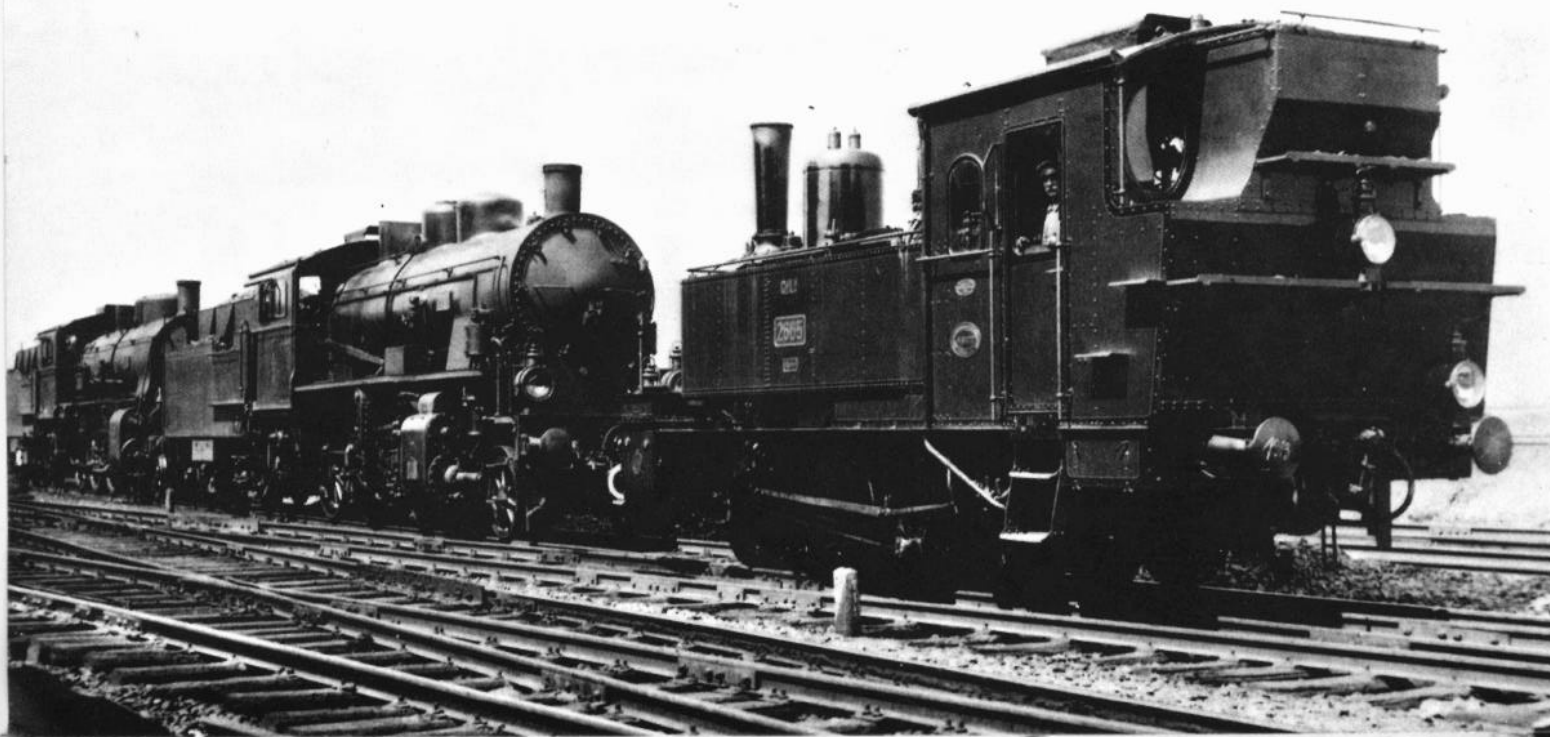
Bild 12: Dieses Foto der Lok 2605 des Baujahres 1923 zeigt, daß bereits damals hohe Kohlenkastenaufsätze angebaut waren. Im Bildhintergrund stehen je eine Güterzuglok der Gattung G 3/4 und G 4/5.
