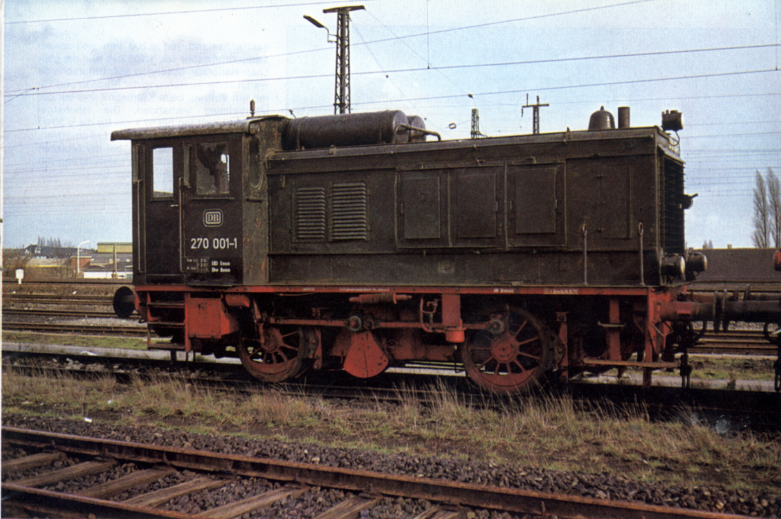
Bild 7: Im Gegensatz zu den anderen Maschinen der Baureihe V 20 hatte die 270 001 ihre Luftbehälter auf dem Vorbau. Die Aufnahme entstand am 19.2.1977 im Bw Hamm.
