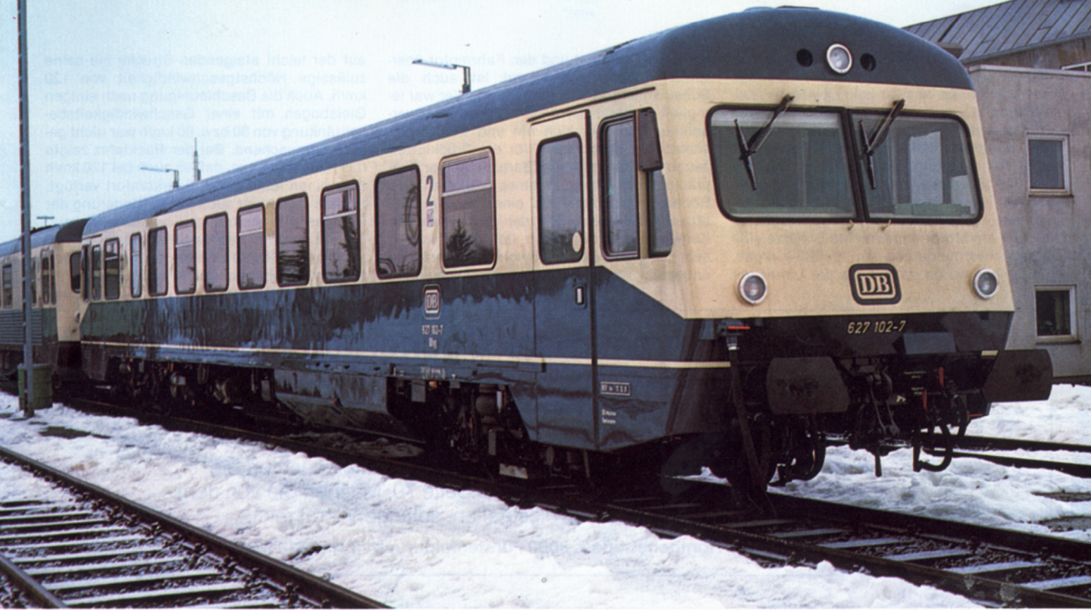
Bild 3: Seitenwände ohne Sicken und ein neues Schema für die Lackierung hat auch der neue 627 102 erhalten, der ebenfalls bereits in Kempten ist.
