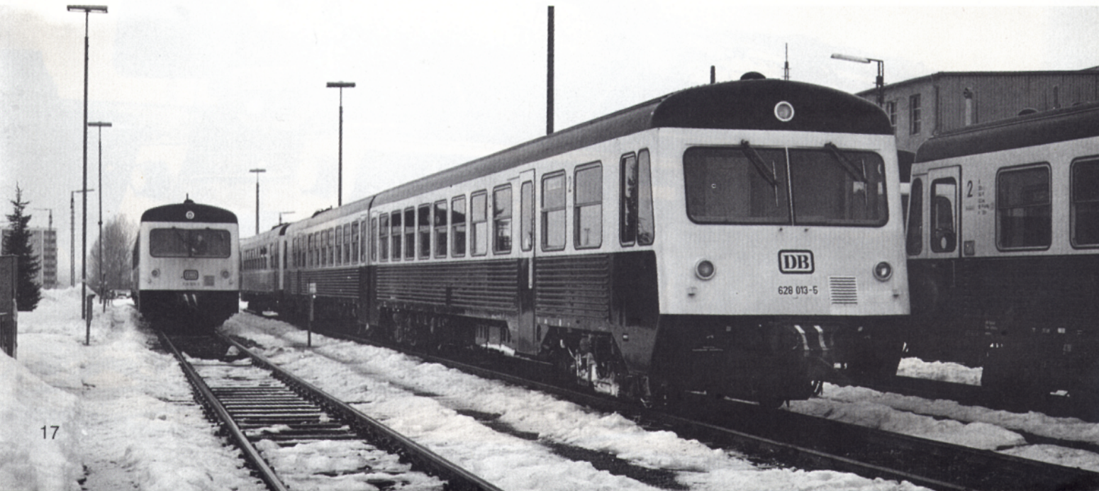
Bild 5: Hier im Vergleich der Triebwagen 628 013 aus der Vorserie, der noch die gesickten Seitenwände und eine Scharfenberg-Kupplung hat.
