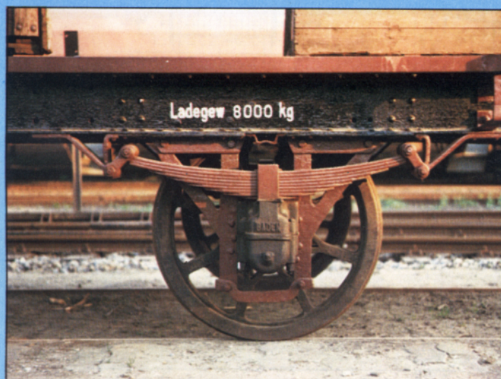
Bild 7 + 8: Ähnlich wie in Bayern wurden Sternspeichenräder auch bei anderen deutschen Bahnverwaltungen verwendet. Die Abb. zeigt einen alten badischen Güterwagen, dessen Achslager ebenfalls große Ähnlichkeit mit den bayerischen Wagen aufweist. Beide Fotos wurden Ende 1981 im norddeutschen Raum aufgenommen. Entsprechend der Beschriftung muß es sich um ein restauriertes Fahrzeug handeln (Unt. 26.2.81). Ob es sich um die Originalradsätze speziell dieses Wagens handelt, läßt sich heute nicht mehr feststellen.
