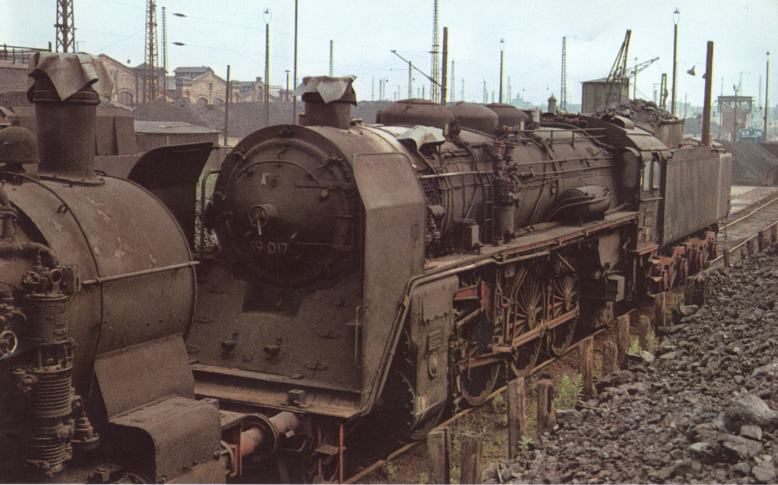
Bild 21: Vor der Aufarbeitung für das Museum zeigt sich die 19 017 mit zusätzlichem Speisedom in einem ziemlich unansehnlichen Zustand. Die Aufnahme entstand am 5.9.1965 bei der VES-M Halle. Foto: M. Delle
