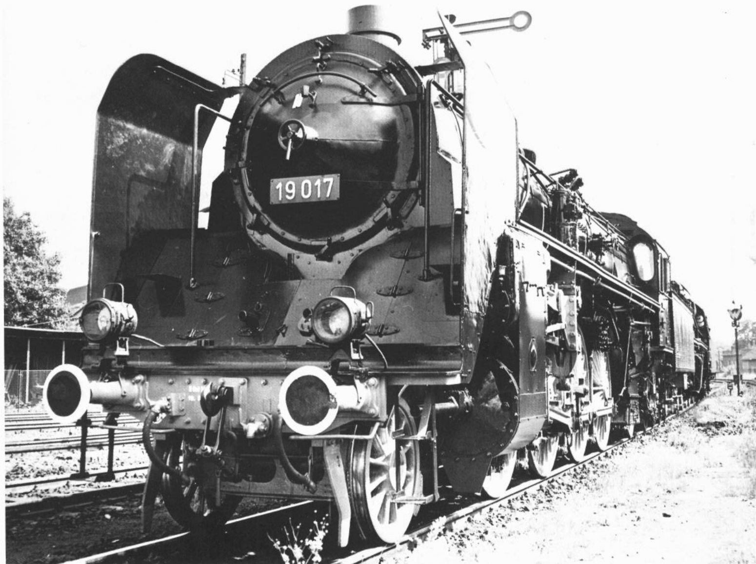
Bild 1: Die für das Verkehrsmuseum Dresden wieder aufgearbeitete und weitgehend in den Urzustand zurückversetzte 19 017. Bei der Lok wurde der Generator am Kessel abgebaut. Stilgerecht wären hier die sächsischen Länderbahnlaternen.
