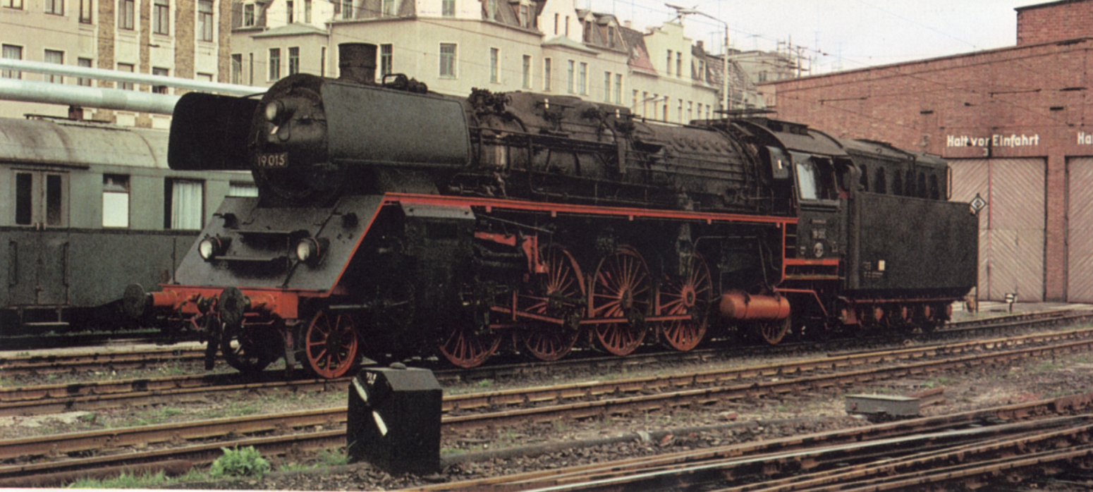
Bild 25: Zwei Jahre später, am 7.9.1967 hat die immer noch als 19 015 bezeichnete Lokomotive eine Ölfeuerung bekommen, und der Tender ist bereits entsprechend umgebaut.
