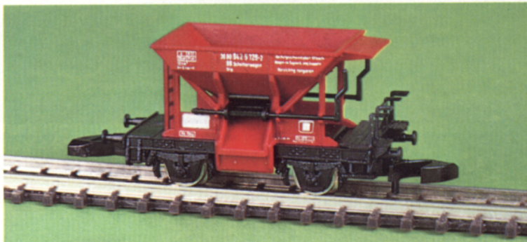
Bild 12: Dies ist der kleinste in Großserie hergestellte Modellbahnwagen. Der nur 33 mm lange Talbot-Schotterwagen von Märklin mini-club hat sogar bewegliche Klappen.
