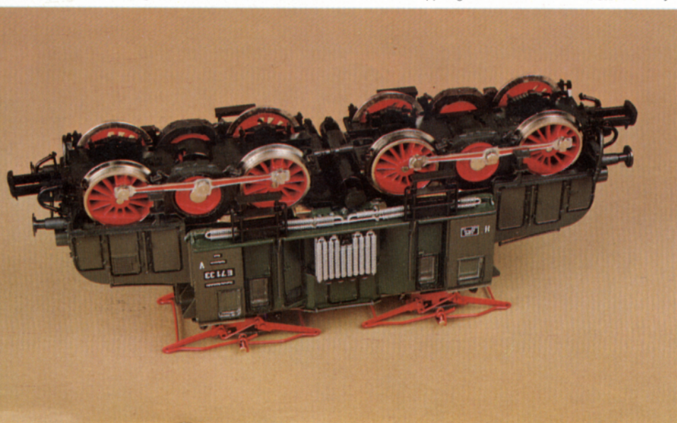
Bild 11: Die beiden Triebgestelle der E 71 33 sind über eine besondere Kurzkupplung verbunden.
