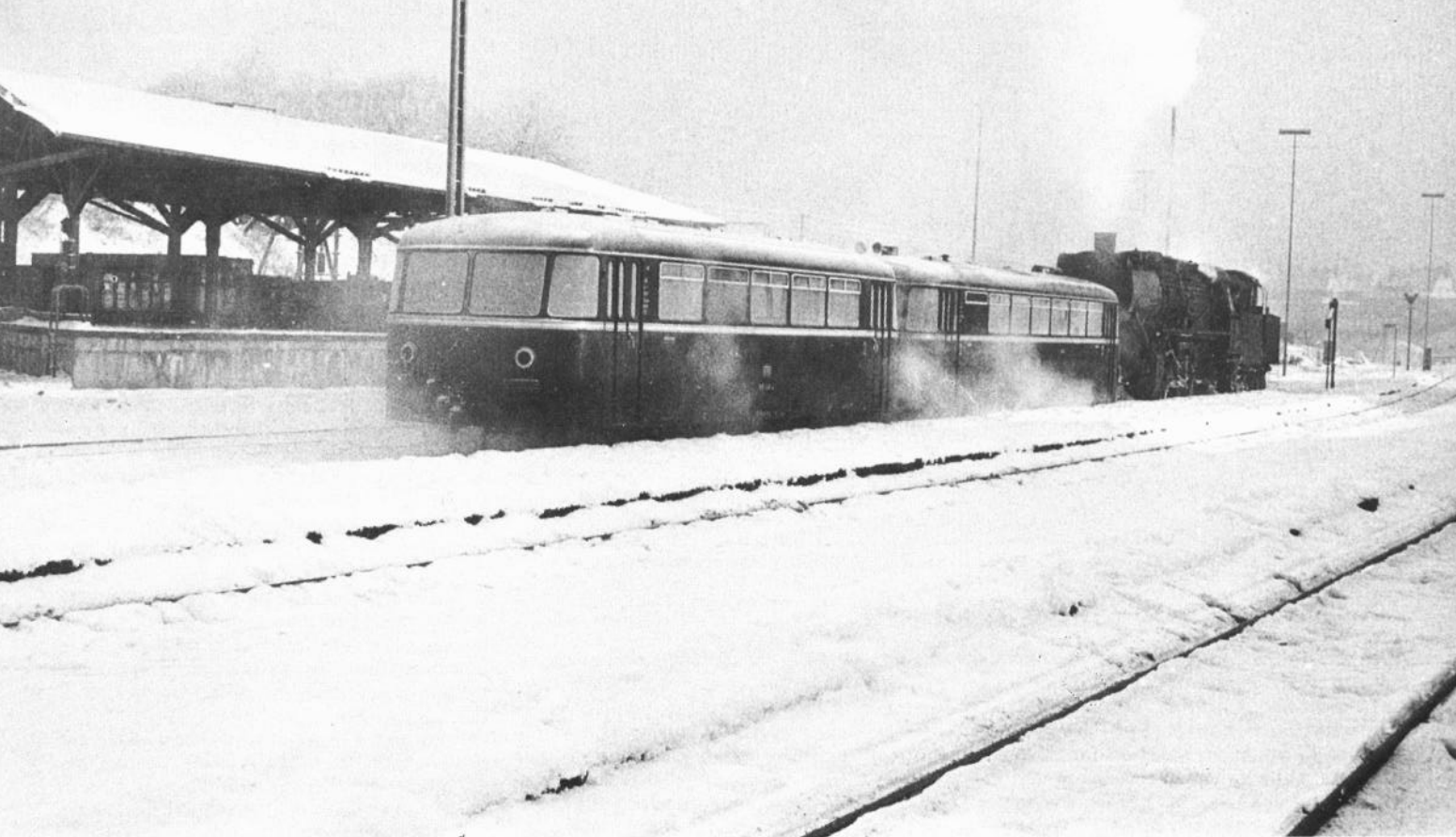
Bild 7: -25° Nachttemperatur war zuviel — der eingefrorene Schienenbus wird 1969 von einer 50er aus dem Bahnhof Selb Stadt ins Bw Hof geschleppt.
