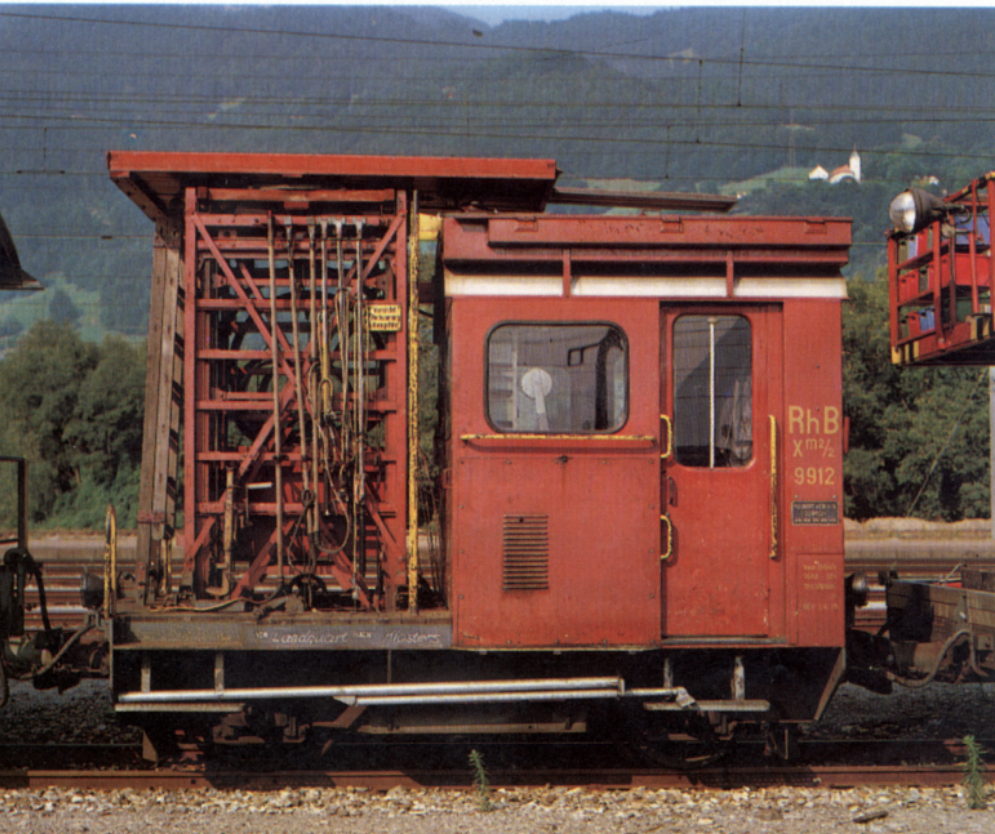
Bild 10: Zu Wartungsarbeiten an der Fahrleitung dient dieser Turmwagen Xm 2/2 Nr. 9912, der aus einem Dieseltraktor Tm 2/2 entstand. Hier im Depot Landquart im September 1981.
