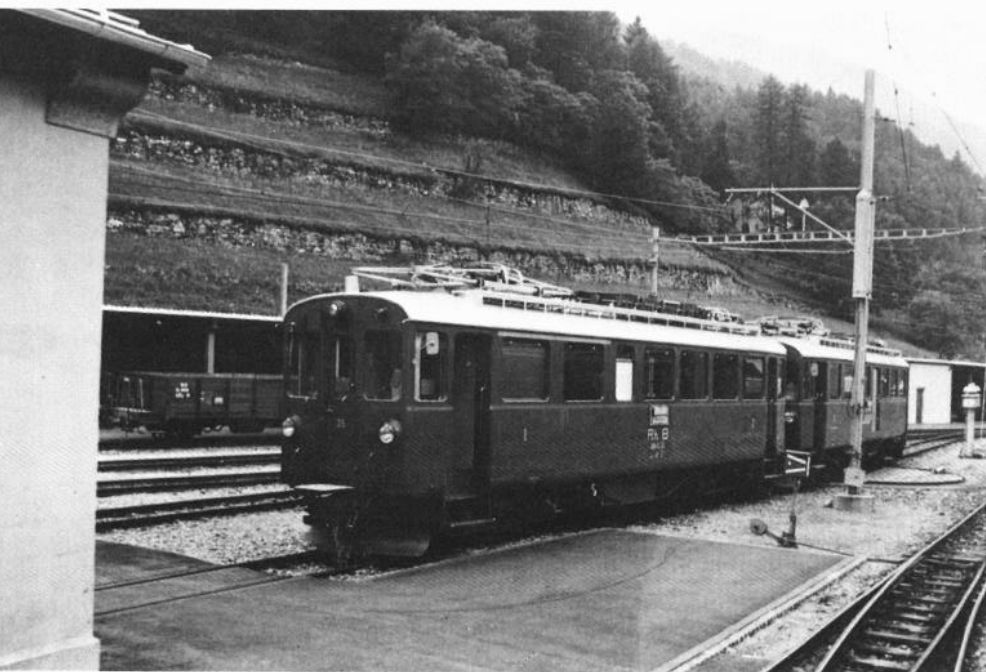
Bild 5: Noch aus der Anfangszeit der Berninabahn stammen diese beiden, inzwischen natürlich grundlegend modernisierten Triebwagen, der ABe 4/4 Nr. 35 und der BDe 4/4 Nr. 38, hier am 18.7.80 im Depot Poschiavo. Im Spitzenverkehr kann die RhB auf diese Fahrzeuge noch nicht verzichten.
