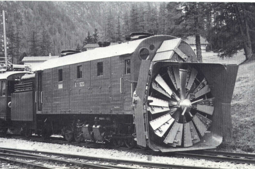
Bild 14: Ein Veteran aus dem Jahre 1910 ist diese selbstfahrende Dampfschneeschleuder X rot d 9213, 1963 in Pontresina aufgenommen. Interessant ist das sechssachsige Gelenktriebwerk Bauart Meyer.
