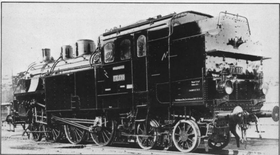
Bild 10: In einem bemerkenswert guten Allgemeinzustand präsentiert sich die 77 110 zu Beginn der dreißiger Jahre dem Fotografen. Offensichtlich war die Lok soeben von der Untersuchung aus dem Aw Kaiserslautern gekommen. Das Revisionsdatum lautet 27.10.31. Der Wasservorrat wird mit 13,9 m 3 angegeben, der Kohlenvorrat mit 4,65 t.
