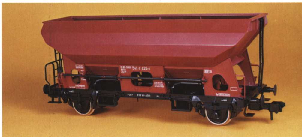
Bild 16: Für die Spur I von Märklin entstand dieser moderne Selbstentladewagen mit beweglichen Rundschiebern der DB-Gattung Ed 090.
