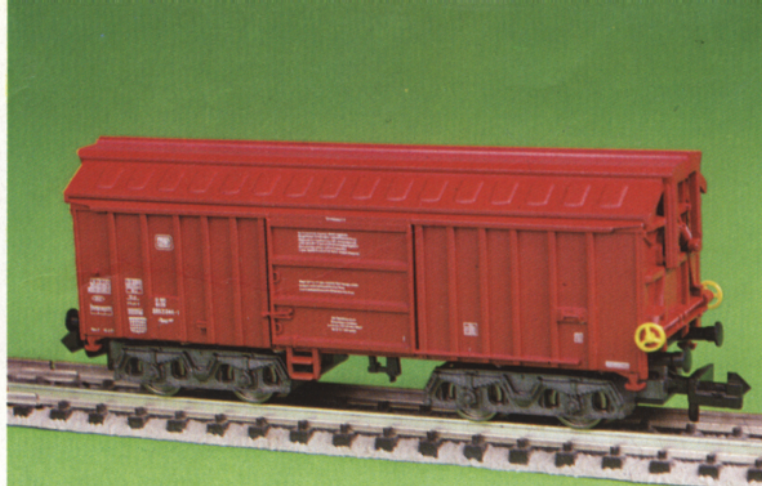
Bild 10: Dieser Schwenkdachwagen der Bauart Taes 887 der DB für Fleischmann piccolo hat zwei abschwinkbare Dachhälften.
