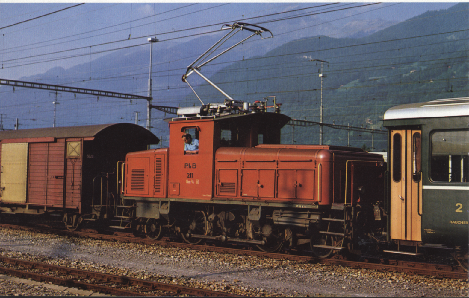
Bild 9: Die Ge 2/4 Nr. 211 verschiebt im Bahnhof Landquart im September 1981. Diese Lok stammt aus der gleichen Serie wie die 222, wurde jedoch 1943 in eine Zweikraft-Rangierlok umgebaut.
