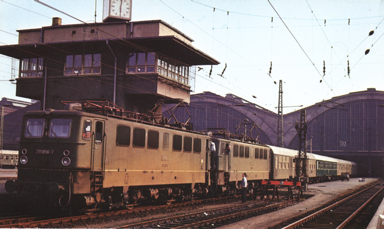
Bild 1: 211 056-7 (E 11 056) als Vorspannlokomotive zu einer weiteren 211 vor einem überlangen Schnellzug im Leipziger Hauptbahnhof. Beide Lokomotiven tragen noch den grünen Anstrich, der aber bei fälligen Haupt- oder Zwischenuntersuchungen durch den neuen weinroten Anstrich ersetzt wird.
