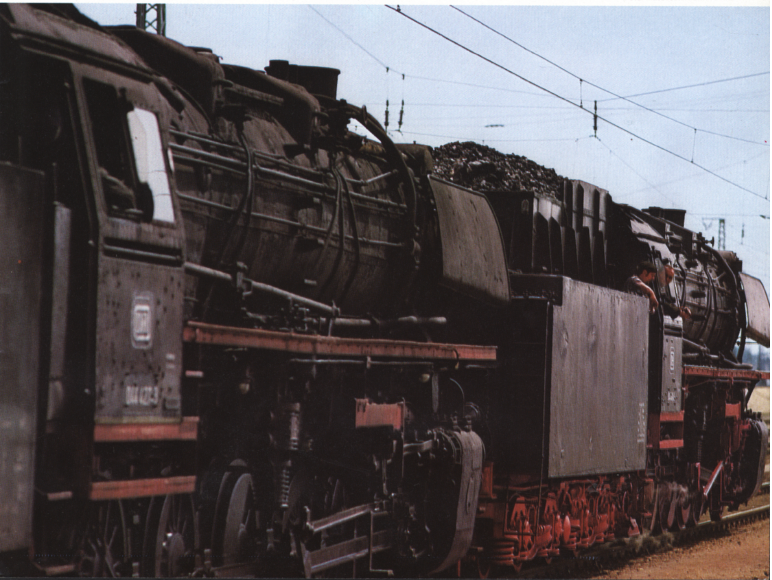
Bild 9: Überführungsfahrt Crailsheim—Regensburg (Bremslok mit Gegendruckbremse!)
