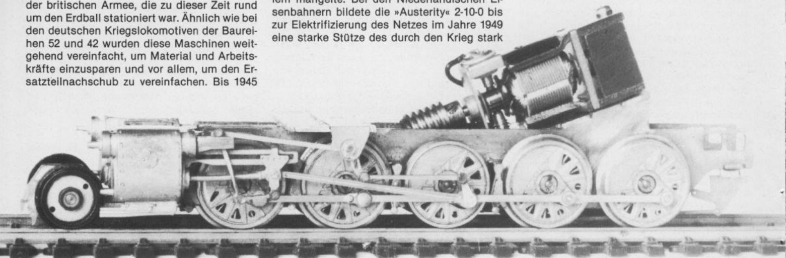
Bild 2: Das Fahrwerk der Lok aus sauber gefertigten Messingätzteilen. Der robuste Antrieb ist gut zu erkennen.
