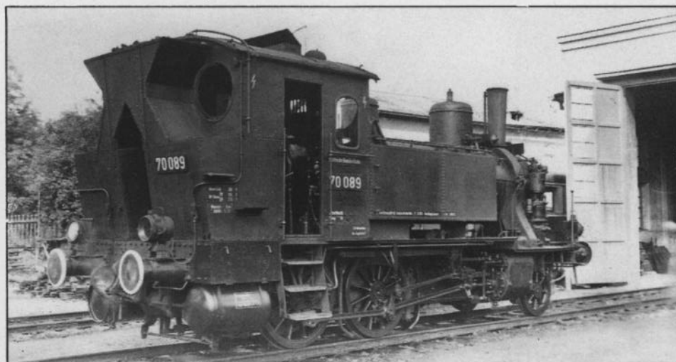
Bild 7: Dieses Foto der 70 089 vom Bw Ingolstadt zeigt den trichterförmigen Aufbau auf den Kohlenbehältern. Das angeschriebene Datum der letzten Untersuchung ist der 1.4.1953. Foto: Bellingrodt
