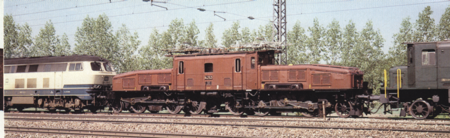
Bild 1: Das Schweizer Krokodil Ce 6/8 III in braun steht mit einem kompletten Ausstellungsüberprüfungszug für München-Freimann am 22.05.1979 in München-Laim bereit. Dies ist die erste Krokodilversion mit zwei Blindwellen pro Triebwerk und Seite. Dieses Modell wird auch von der Firma Arnold in Spur N gefertigt. Foto: K.-D. Holzborn
