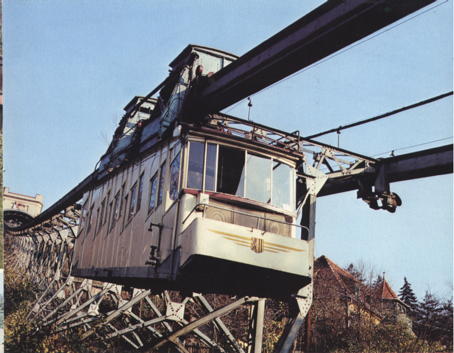
Bild 1: Der Wagen 2 der Schwebebeseilbahn Dresden-Loschwitz auf dem Weg zur Talstation. Vor dem »Fahrerstand« befindet sich eine offene Plattform für Gepäck und Fahrräder.
