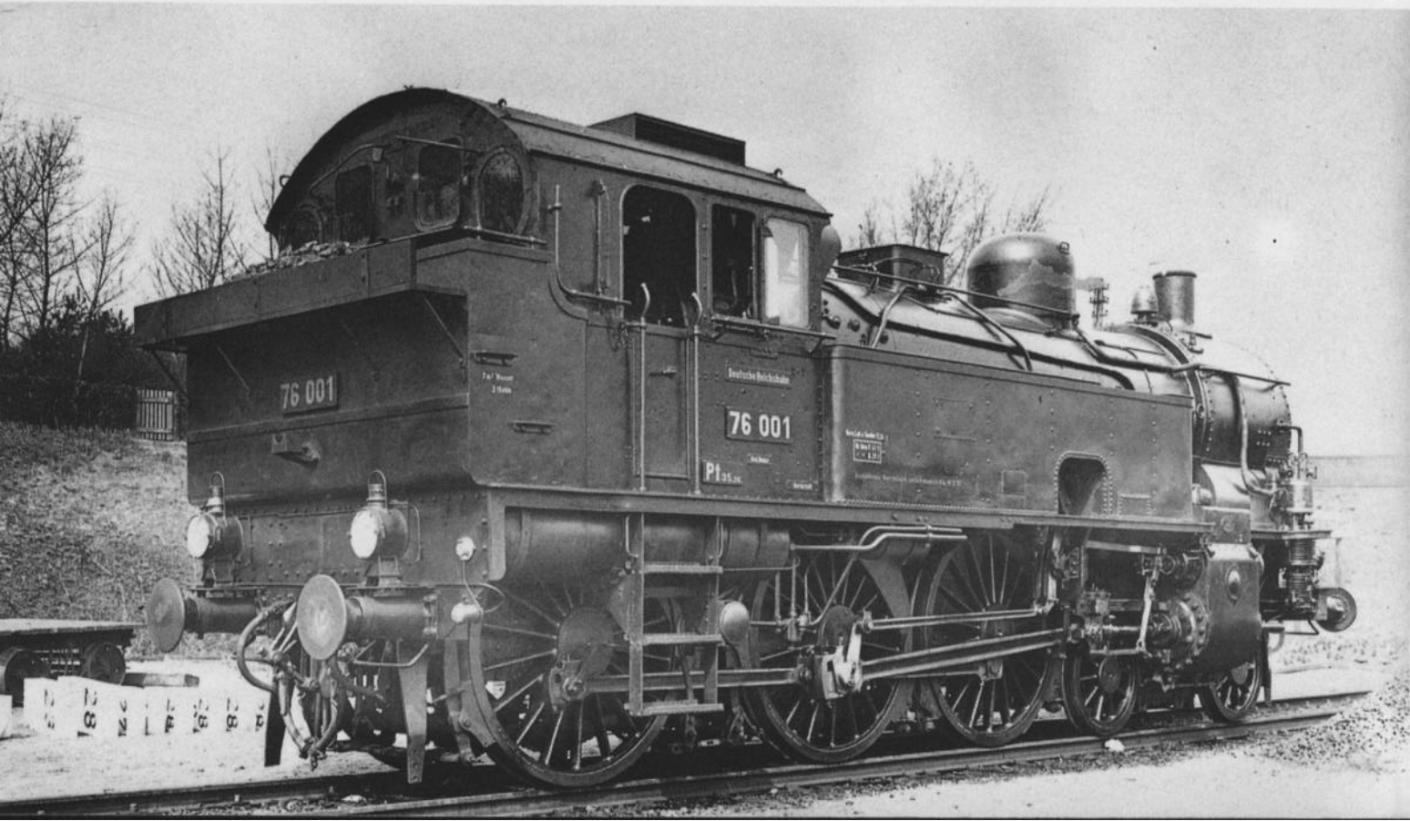
Bild 2: Zu Beginn der dreißiger Jahre kamen die Loks der BR 76 zum Bw Darmstadt. Den Anschriften an der 76 001 ist zu entnehmen, daß die Aufnahme nach 1937 entstand. Um die Sicht bei Rückwärtsfahrt nicht zu beeinträchtigen, blieb der Kohlenkasten ohne Aufsatz.
