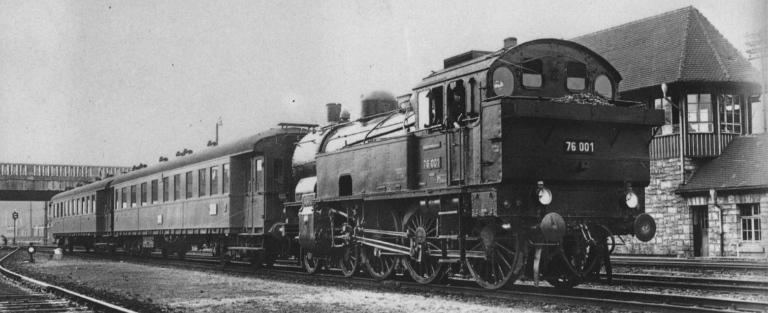
Bild 5: Ein von der 76 001 geführter Eilzug passiert das wohlbekannte Stellwerk Darmstadt. Die Maschinen der Baureihe 76 rückwärts laufen zu lassen, war immer mit der Gefahr einer Entgleisung verbunden. Ein solcher Unfall im Jahre 1939 verursachte nicht nur den Verlust der Lokomotive 76 009 sondern forderte leider auch Menschenleben.
