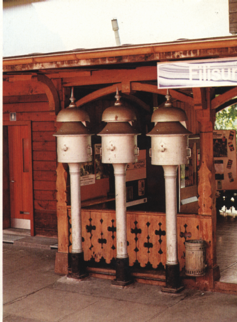
Bild 7: Und dies sind die Läutewerke des Bahnhofs Serneus; siehe auch Bild 1. Ein ähnliches Läutewerk befindet sich auch als HO-Modell im BEMO-Angebot.
