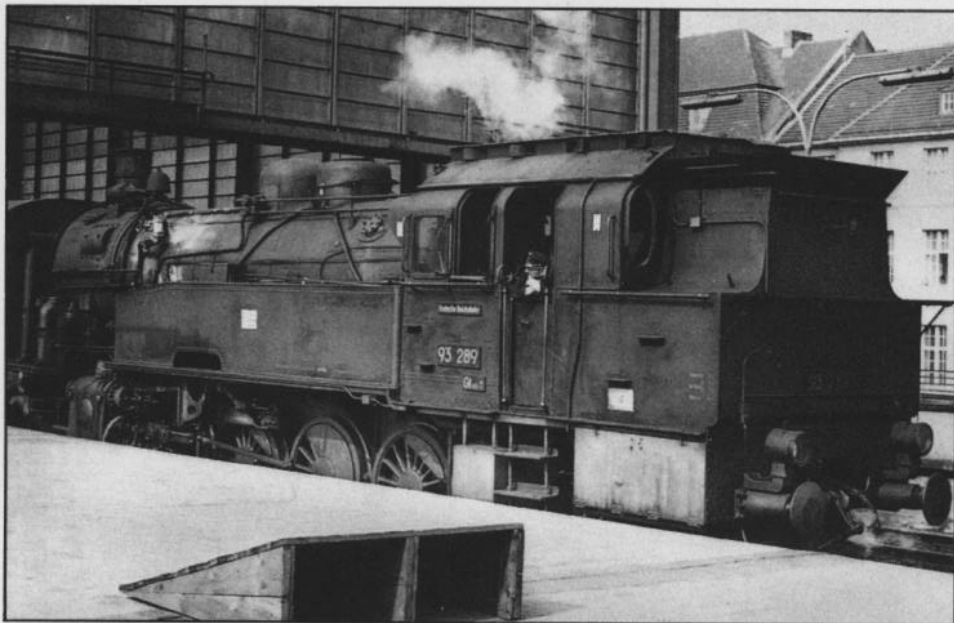
Bild 6: Mitte der 60er Jahre fuhr auch die 93 289 in Berlin. Heimat-Bw war Berlin-Grunewald. Diese Lok hatte zwei runde Dome, aber schon den Lüftungsaufsatz auf dem Dach.
