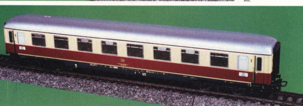
Bild 4: Über eine Innenbeleuchtung und über LED-Schlußbleuchten verfügt dieser TEE-Abteilwagen der Baugröße HO von Märklin.
