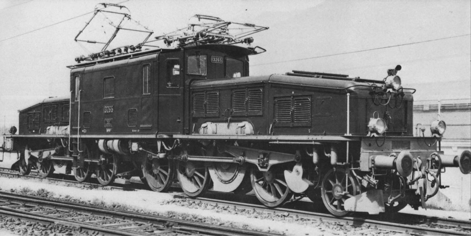
Bild 3: Diese Be 6/8 II stammt aus der ersten Lieferserie von 1920—1921. Augenfalliger Unterschied ist die zusätzliche Blindwelle vor der ersten Kuppelachse.
