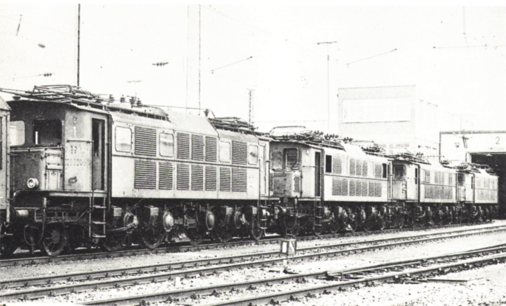
Bild 1: In der Zeit zwischen der Ausmusterung und dem Ab-transport hatten die Maschinen viel Rost angesetzt, einige Scheiben und einen Teil ihrer Inneneinrichtung verloren.
