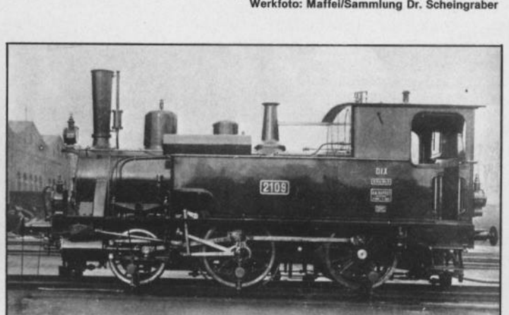
Bild 7: Zu den letzten Maschinen der Gattung D IX zählt die Lok mit der Bahn-Nr. 2109. Das Foto zeigt die Lok kurz vor der Ablieferung im Jahr 1899 bei Maffei. Werkfoto: Maffei/Sammlung Dr. Scheingraber
