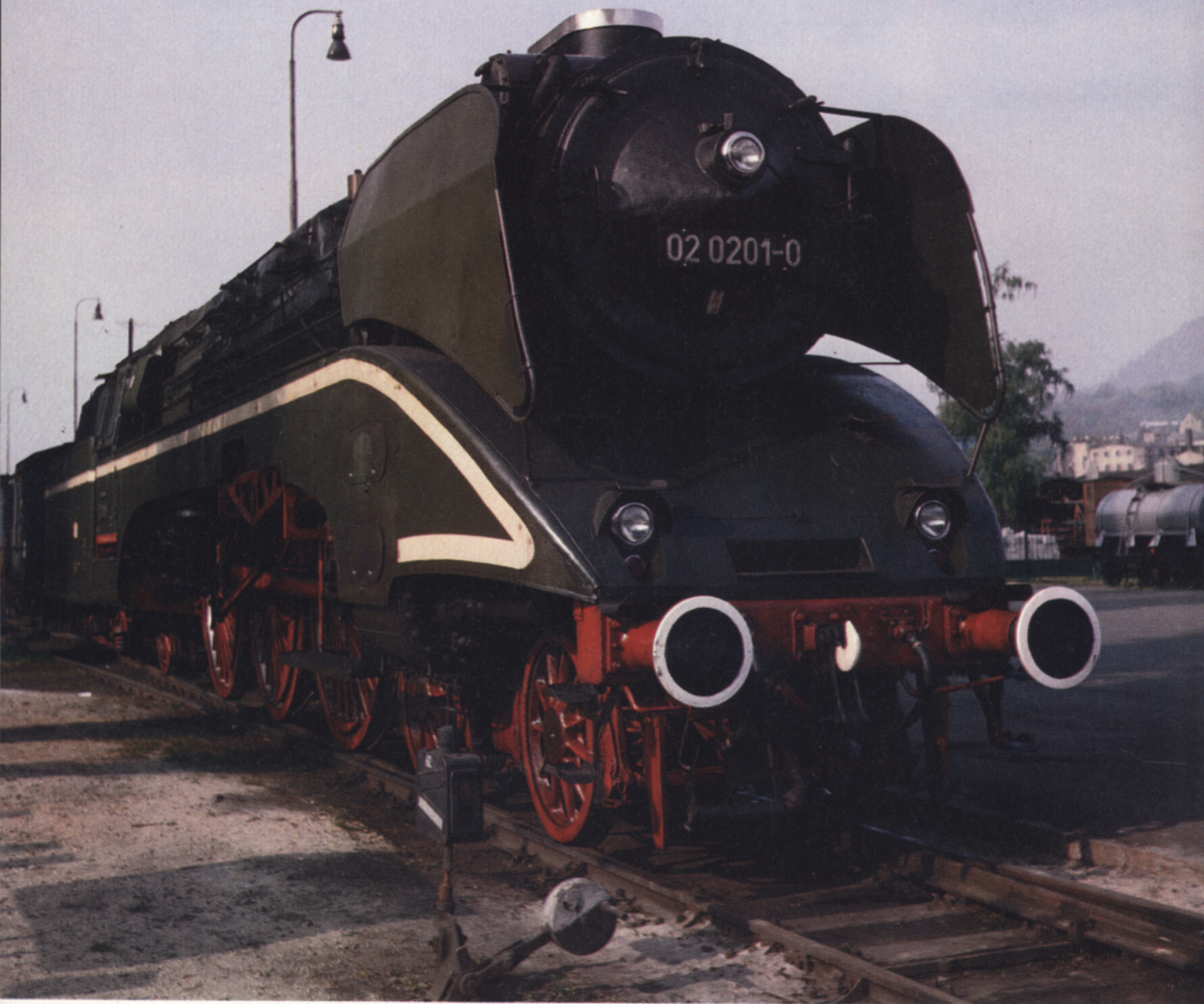
Bild 11: Ein ausgesprochenes Schmuckstück stellt die 02 201 dar. Sie ist die schnellste betriebsfähige Dampflokomotive der Welt. Sie kam mit eigener Kraft nach Decin, war aber dann kalt abgestellt. Sie entstand bei der DR unter Verwendung der Treibradsätze der 61 002, den Außenzylindern und der Schleppachse der 45 024 und des Tenders der 44 468. Der Kessel stammt von einer BR 22, also ein DR-Neubau Kessel.
