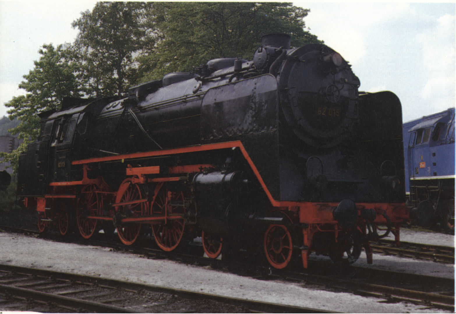
Bild 2: Die 62 015 sollte als Einheitslokomotive ursprünglich die preußische T 18 ablösen. Wegen des hohen Achsdruckes von 20 Mp blieb es jedoch bei nur 15 Exemplaren, und die T 18 versah weiterhin bis in die 70er Jahre ihren Zugdienst.
