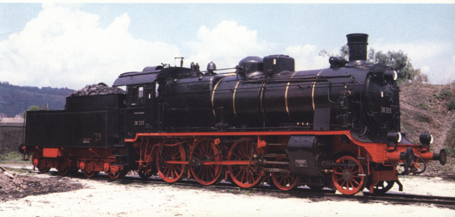
Bild 10: Die 38 205 des Verkehrsmuseum Dresden ist der einzige betriebsfähig erhalten gebliebene sogenannte sächsische „Rollwagen“. Die Maschine hatte eine Doppelgleitbahn und einen zweischienigen Kreuzkopf. Der Voreilhebel ist hinter dem Kreuzkopf angebracht.
