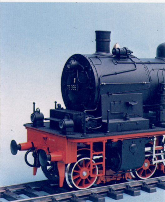
Bild 16: Vor der Rauchkammer liegt der Vorwärmer mit allen Leitungen.
