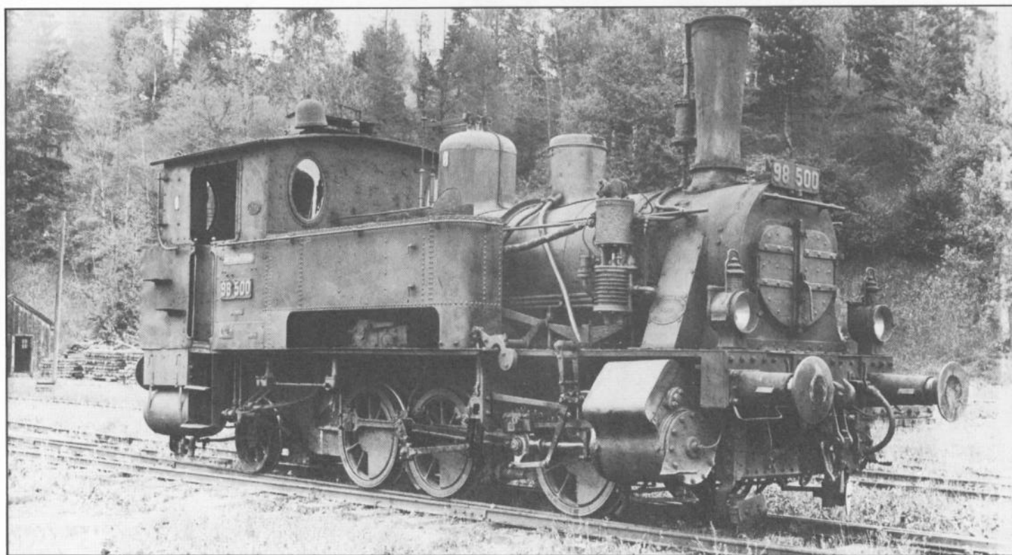
Bild 20: Diese 98 500 hatte eine für Krauss typische Rauchkammertür. Foto: Archiv Bellingrodt
