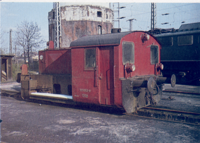
Bild 19: Kleinlok der Leistungsgruppe II 323 053 mit geschlossenem Führhaus, aufgenommen im März 1977 im Bw Hildesheim.
