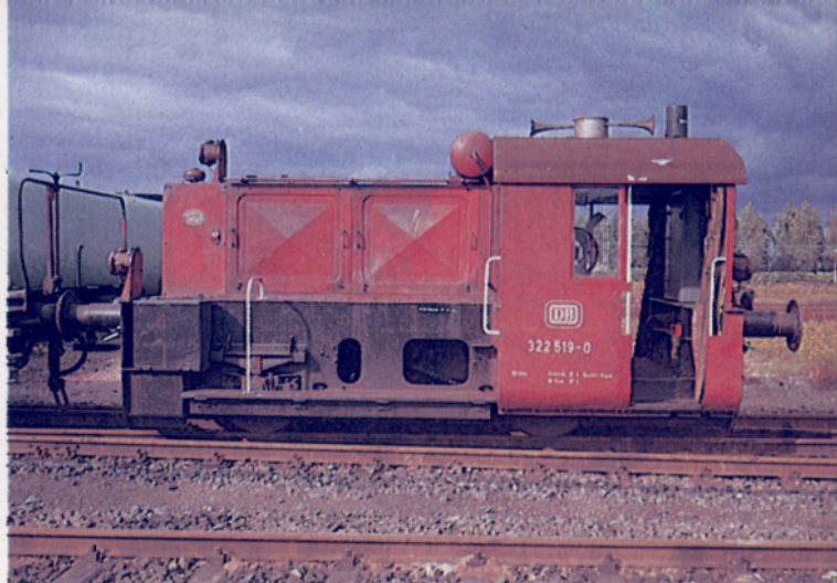
Bild 18: Die 322 519, aufgenommen am 3.7.78 im Bw Köln-Nippes. Sie hat am Einstieg noch die Ledervorhänge, das seitliche Fenster ist bereits verglast.
