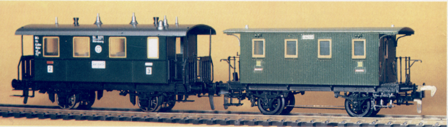
Bild 9: Die komplette Garnitur, noch unlackiert und mit Original-Kupplungen und Bremsschläuchen »gesupert«. Gut erkennbar sind die überaus filigranen Bühnengeländer.
