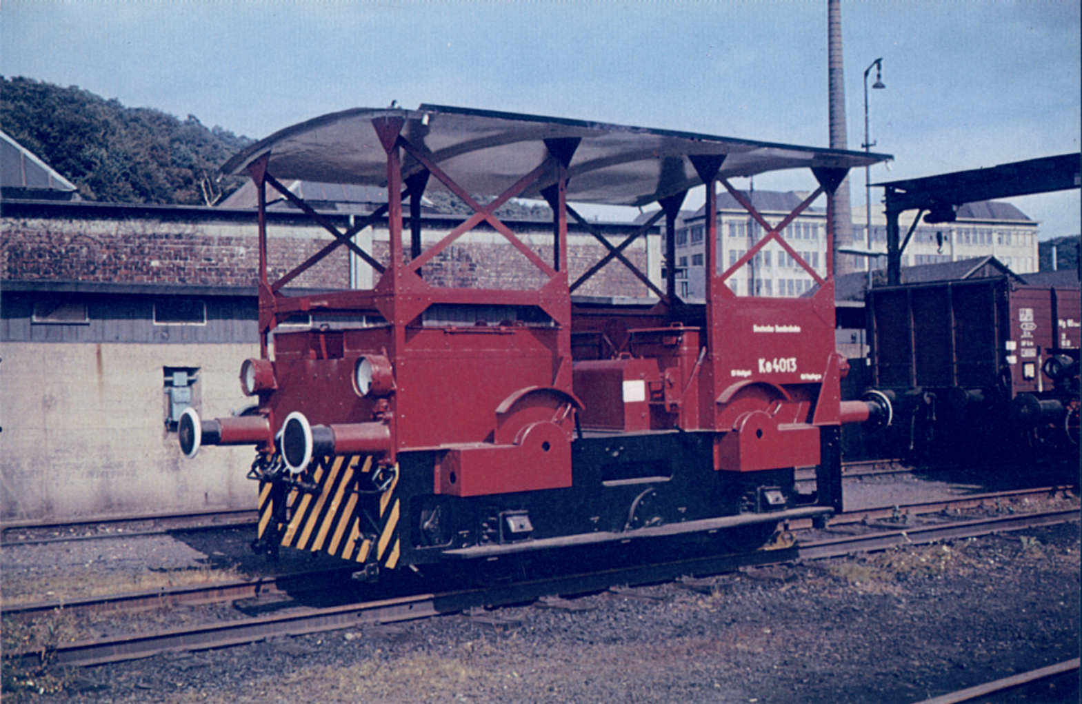
Bild 2: Auch diese »fahrbare Gartenlaube« zählt zu den Kleinlokomotiven der Leistungsgruppe II. Es ist die von der DGEG sehr schön restaurierte Ka 4013 in Bochum-Dahlhausen, eine der frühen Akkulokomotiven.
