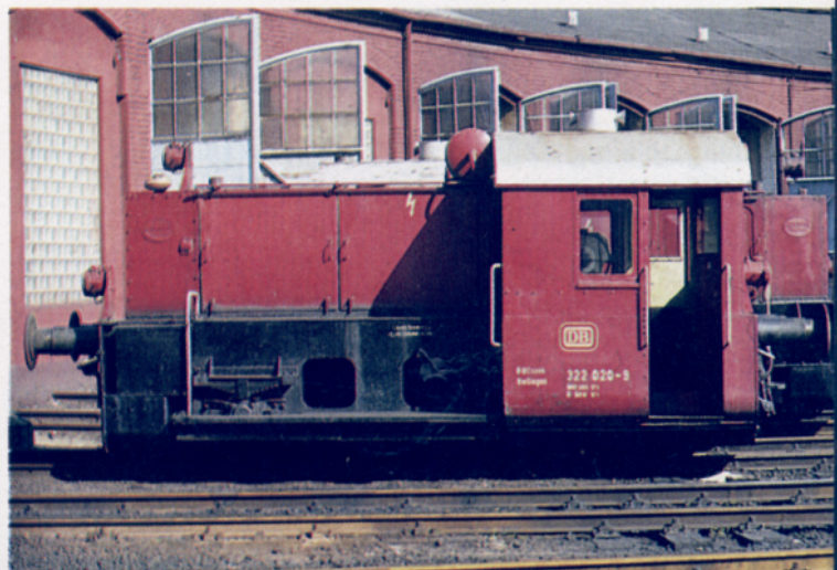
Bild 22: Kleinlokomotive 322 020 im Bw Siegen am 25.9.1978. Führhaustüren mit Fenster, glatte Türen am Vorbau.
