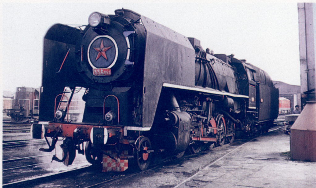
Bild 4: Die 556.0 (1'E h2-Güterzuglokomotive) gab es mit großen und mit Witte-Windleitblechen. Die 556.042 stammt noch aus den ersten Lieferungen und war im September 1980 im Depot Liberec noch im Einsatz.
