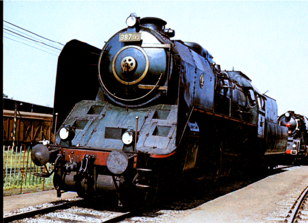
Bild 3: 387.043 — Grundtyp der »ČSD-Einheitslok« ist die Reihe 387.0. Diese 2'C 1' h3-Lokomotive von Škoda ist durch ihren Stahlguß-Barrenrahmen bemerkenswert.
