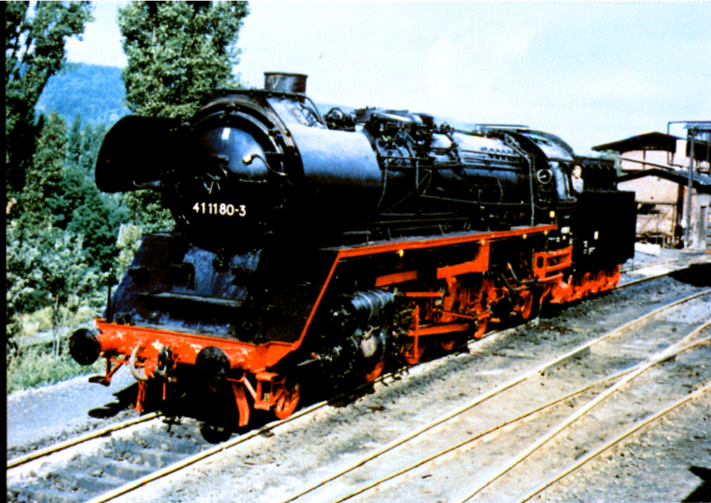
Bild 3: Die 41 1180-3 steht nach einer Hauptuntersuchung zur Abschlußuntersuchung bereit. Die Zylinderbekleidung und Signallaternen fehlen noch (23. August 1980).
