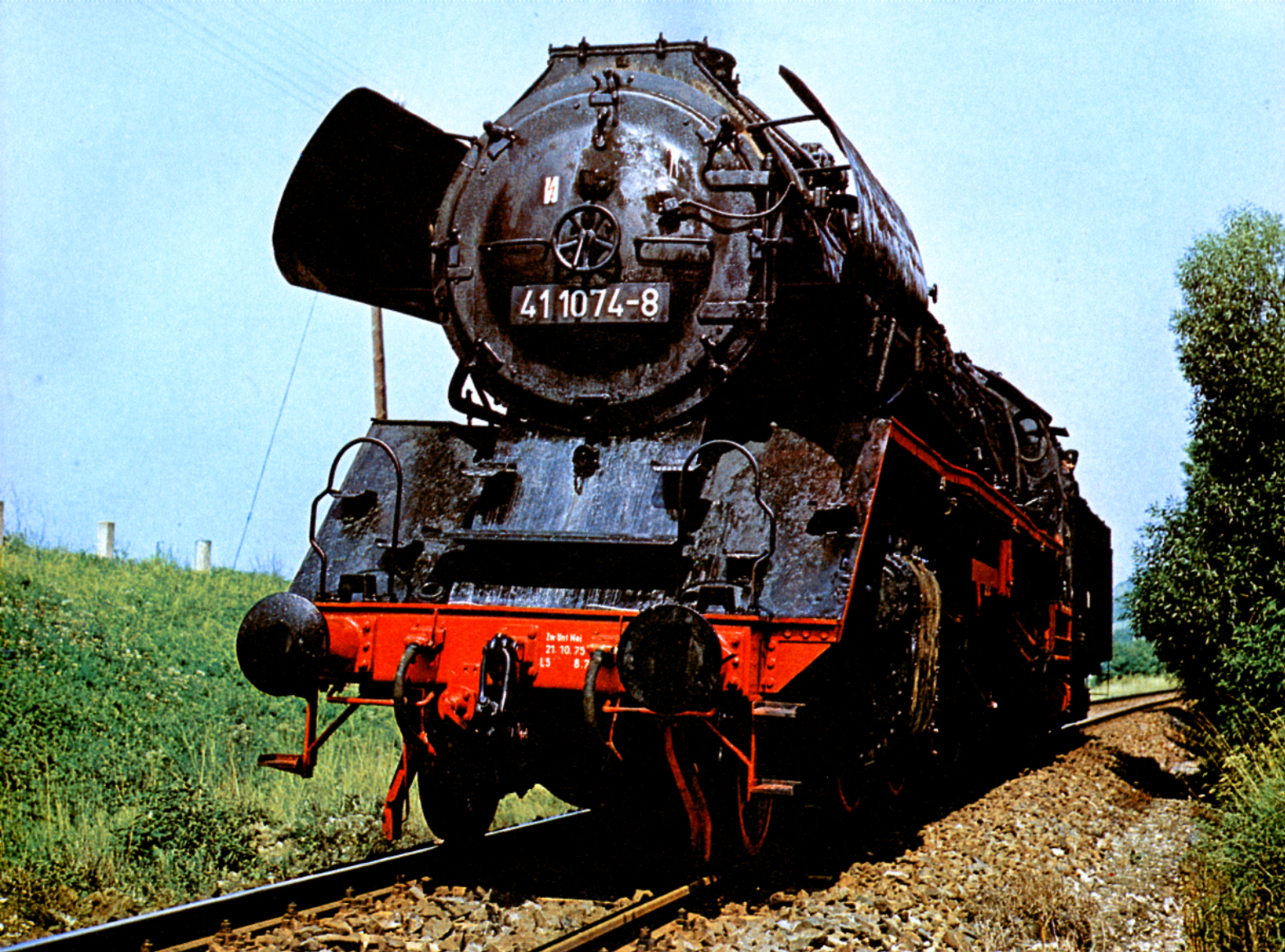
Bild 5: Die 41 1074-8 nach einer L 5-Untersuchung bei einer Leerprobefahrt. Deshalb fehlen auch noch die Signallaternen (August 1979).
