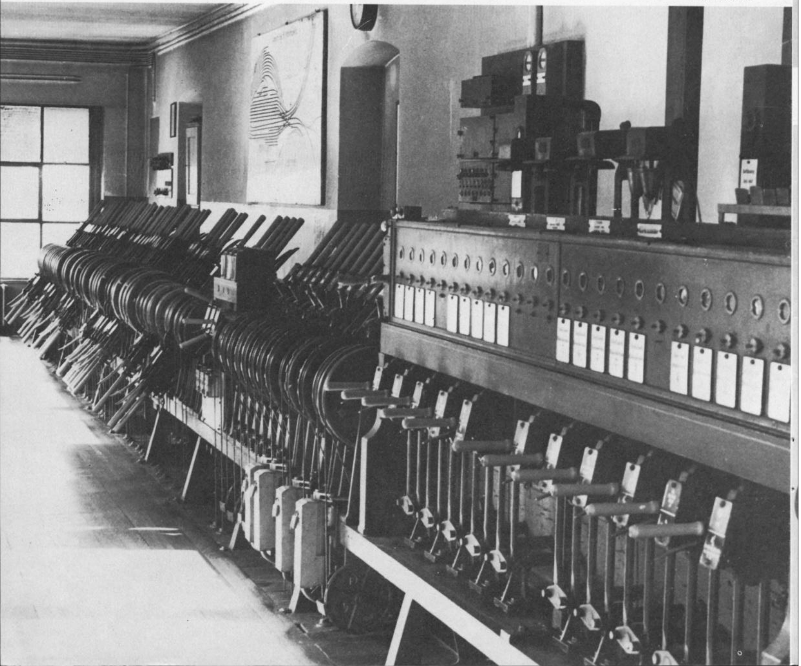
Bild 21: Ein Blick in das Stellwerk des Bahnhofes Marktredwitz. Hierbei handelt es sich um eine Hebelbank mit 102 Hebeln, eine der größten Hebelbänke bei der Deutschen Bundesbahn am 19.9.1970.
