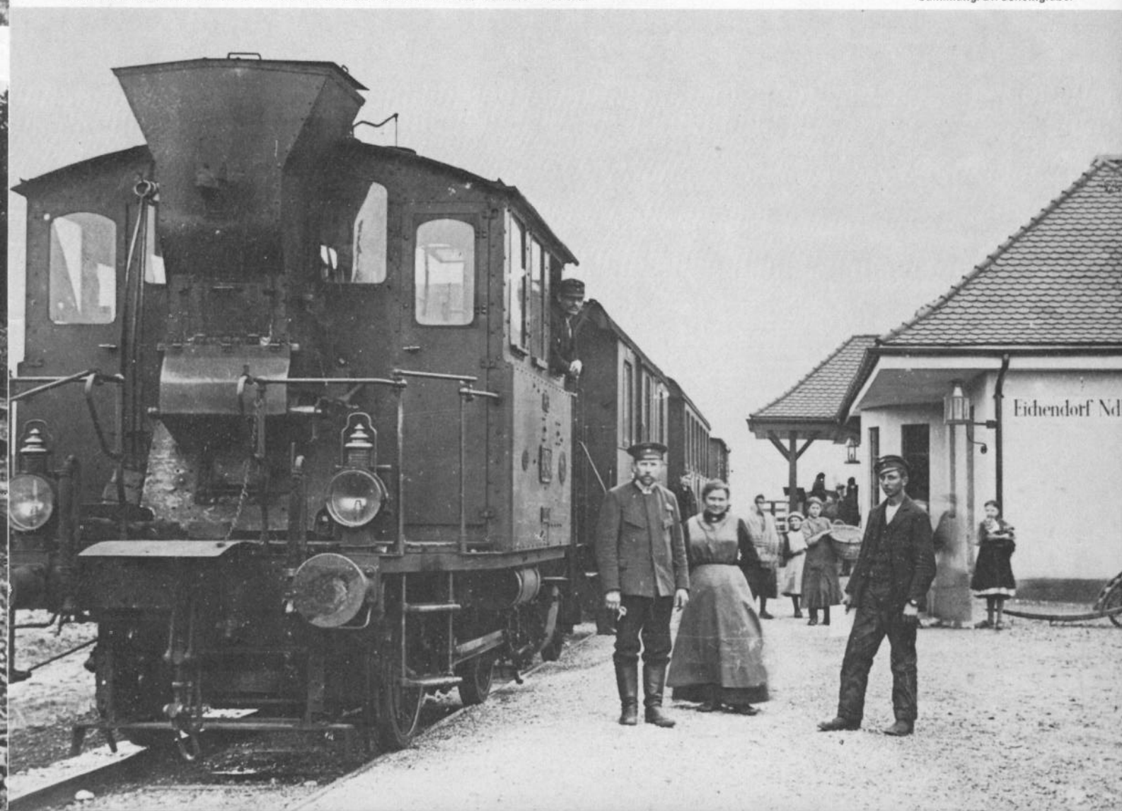
Bild 18: Soeben ist der Lokalbahnzug im Bahnhof Eichendorff/Niederbayern, geführt von der Lokomotive 4548 der letzten von Krauss gebauten Maschine der Gattung PtL 2/2 angekommen. Diese Lokomotive ohne Blindwelle fuhr bei der Deutschen Reichsbahn mit der Betriebs-Nr. 98 322.
