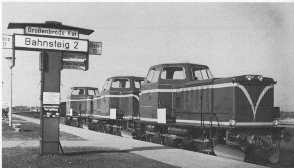
Bild 9: Am Großenbrode Kai stehen die Nr. 67, 68 und 69 der Schwedischen Staatsbahn versandbereit. Baujahr 1955, Grund- typ 800 D (1. Serie) mit 800 PS.
