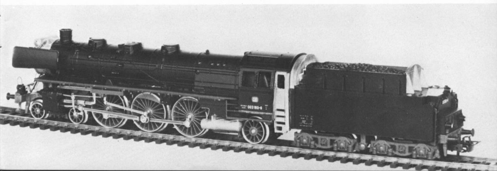
Bild 3: Das gleiche Modell, diesmal von der Heizerseite, schräg von hinten aufgenommen. Gut erkennbar sind die neue Kohlebunker-rückwand und die Führerhausabschlußteile. Der Stehkessel erhielt links und rechts außerdem Druckluftkessel.
