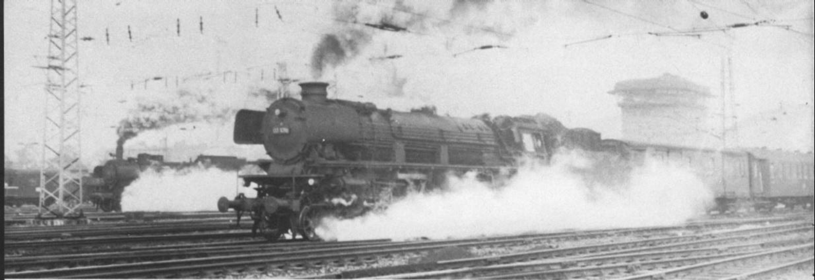
Bild 7: Einige der neubekesselten Maschinen hatten zunächst einen Kranzschornstein erhalten.
