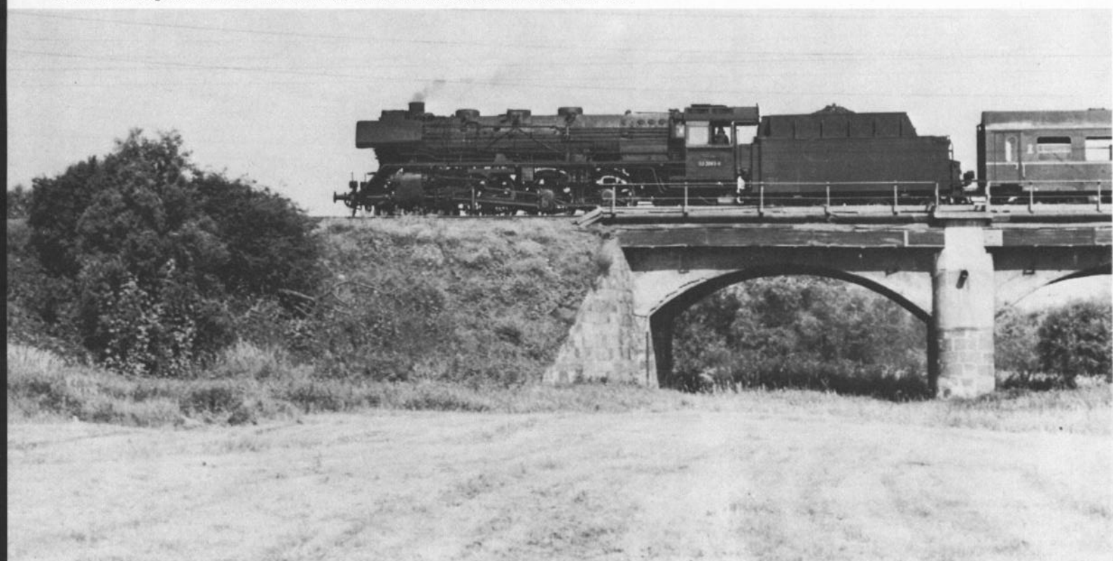
Bild 8: 03 2083-8 - Silhouette einer 03 mit Altbau-Langkessel und neuem Hinterkessel. Vor dem Schornstein ist der Mischkasten sichtbar. Das ist der Bauzustand der DR 03 ab 1960. Den neuen Hinterkessel erkennt man an der größeren Zahl Waschluken. Die Aufnahme entstand auf der Muldebrücke bei Bitterfeld im Juli 1976.
