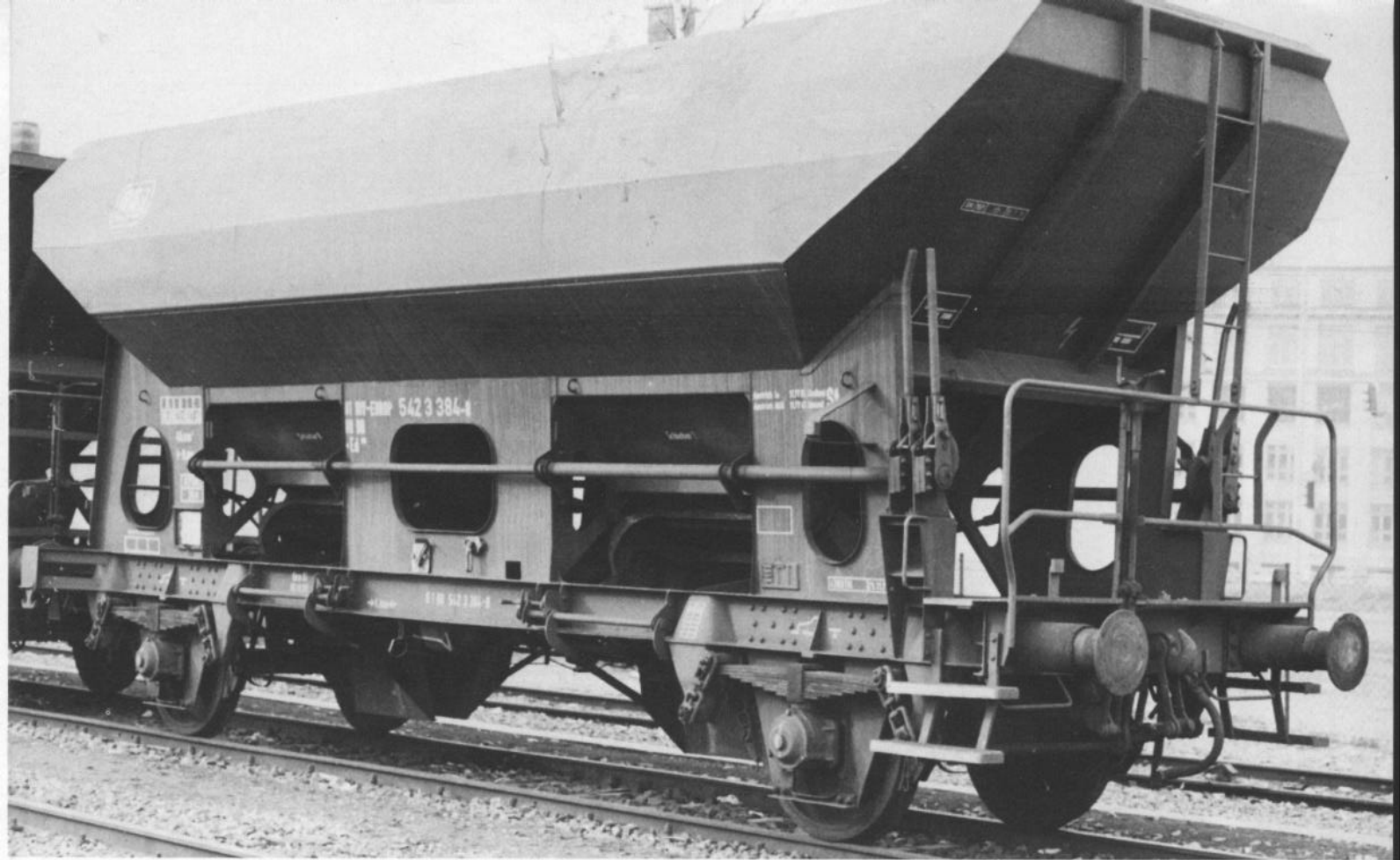
Bild 4: Einen etwas größeren Laderaum mit 33,5 \text{ m}^3 hat dieser Wagen der Gattung Ed 086, der noch mit Einfeldschaken am Federgehänge ausgestattet ist.
