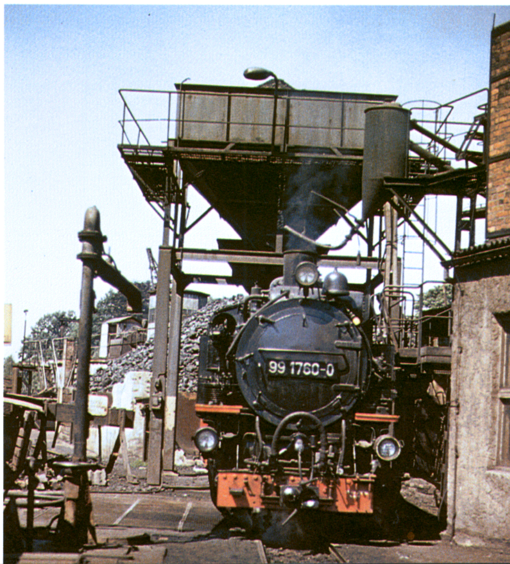
Bild 3: Für ein Schmalspur-Bw hat Zittau eine ausgesprochene komfortable Bekohlungsanlage in der die 99 1760-0 gerade bekohlt wird (1979).
