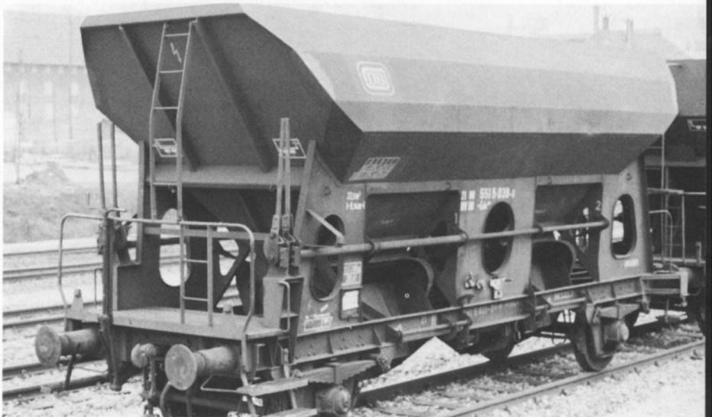
Bild 4: Einen etwas größeren Laderaum mit 33,5 \text{ m}^3 hat dieser Wagen der Gattung Ed 086, der noch mit Einfeldschaken am Federgehänge ausgestattet ist.
