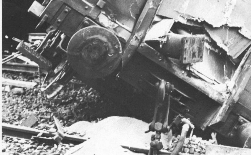
Bild 4: In der Stirnwand des vierten Wagen steckte ein Puffer vom nachfolgenden Fahrzeug.
