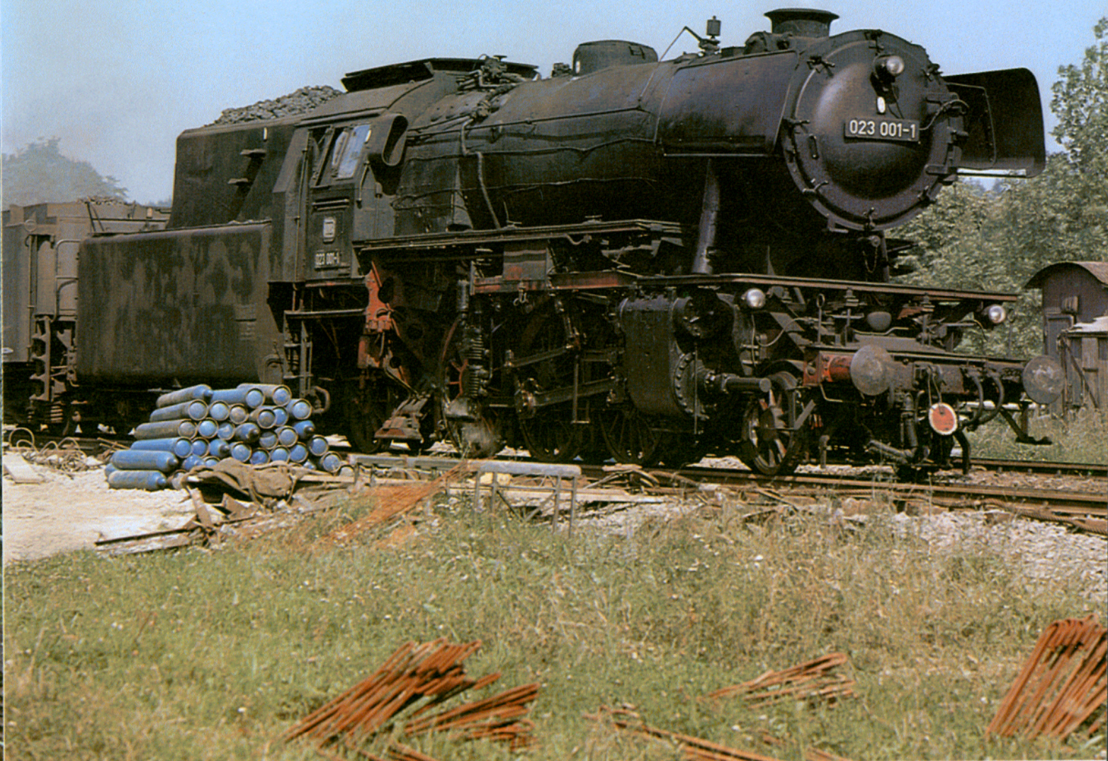
Bild 4: Am Ende ihrer Dienstzeit wurden die Lokomotiven der Reihe 023 nicht selten auch vor Arbeitszügen eingesetzt, so auch die 023 001 beim Brückenbau in der Nähe von Vellberg an der Strecke Schwäbisch Hall–Crailsheim. Foto: Obermayer
