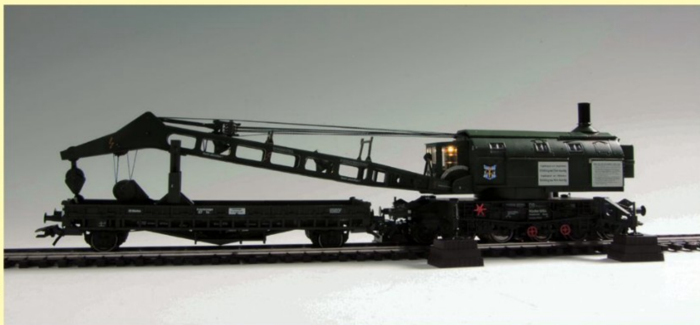
Neben den beiden parallel angesteuerten Arbeitsscheinwerfern im Ausleger besitzt der Kran auch eine schaltbare Beleuchtung in der Bedienerkabine.
