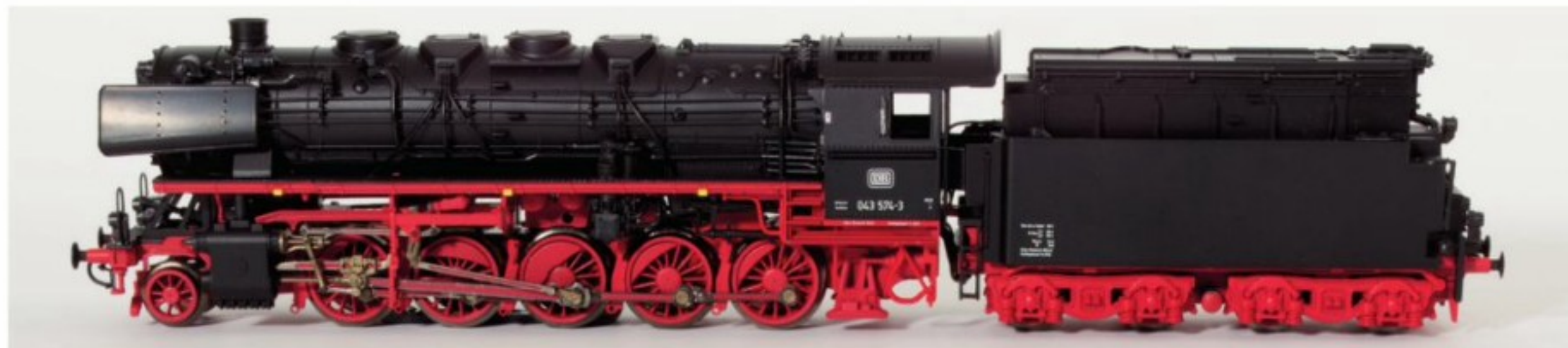
Rocos 44 besitzt nach der Überarbeitung vor einigen Jahren den kombinierten Antrieb von Lok und Tender über Kardanwellen. Bewegliche Türen kaschieren sowohl die Welle als auch den Abstand zwischen Lok und Tender. Etwas störend wirken der Drahtverhau zwischen Lok und Tender sowie die (durchaus technisch bedingt) vereinfachte Tendervorderwand. Die Tenderdrehgestelle sind starre Attrappen und der Achsenverschiebbarkeit wegen etwas zu breit.
