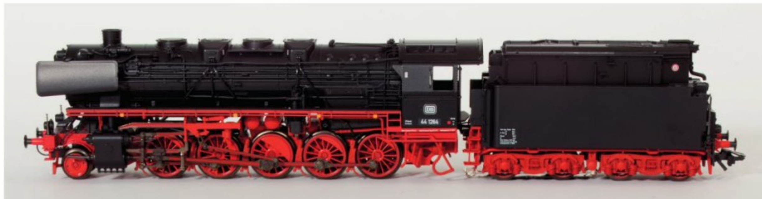
Die Heizerseite des neuen Märklin-Modells. Auffällig ist lediglich der durch fehlende Türen sichtbare Abstand zwischen angetriebener Lok und Tender. Der Scheibenradsatz im Vorlaufgestell war auch beim Original vorhanden.
