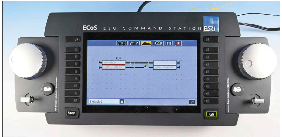
Der Gleisplan des Musteraufbaus kann auch mit der ECoS realisiert werden. Hier kommt ein ECoSDetektor RailCom zum Einsatz und zeigt an, dass die Fahrzeuge schon „am Start“ sind.
