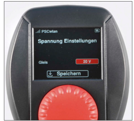
Die Spannung kann in 2-Volt-Schritten zwischen 16 und 22 Volt eingestellt werden.
