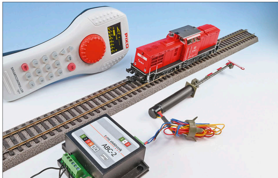
Für diesen Testaufbau musste in der ESU-Lok noch ABC in CV27 aktiviert werden. Die Fahrstufe ist aufgedreht und der Zugschluss ist an. Die Lok fährt aber nicht, weil das Signal Halt zeigt und ABC aktiv ist.
