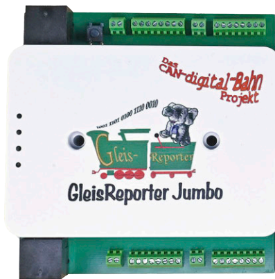
Mit jeweils 32 Anschlüssen bieten die Jumbos viele Möglichkeiten für die effiziente Anlagenverkabelung.
