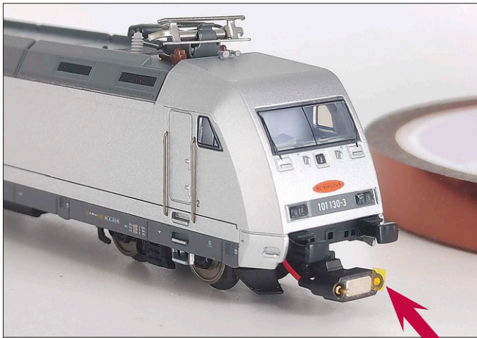
Ein kleines Stück Klebeband über der Kontaktfläche an der Kupplung verhindert die Erkennung des Zuges und damit die Umschaltung der Stromabnahme.
