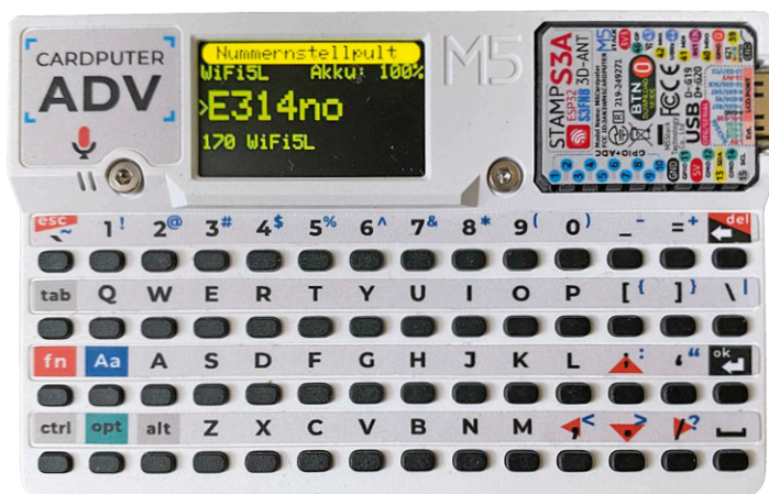
Der Cardputer ADV ist sofort einsatzfertig, da er bereits mit Display, Tastatur und Akku ausgestattet ist. Der integrierte ESP32-S3-Prozessor übernimmt die Anbindung per WLAN an das Python-Stellwerk. Alle Abbildungen: Friedrich Bollow
