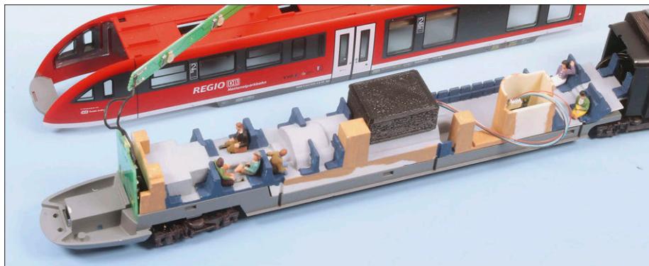
Im Desiro der Baureihe 642 von Tillig kann man ein Kompaktmodul von Uhlenbrock bequem unterbringen. In der Toilette befindet sich unten der sechspolige Steckplatz nach NEM 651, in den nur ein kleiner Decoder passt. Über den microSUSI-Anschluss ist der Soundwürfel am Decoder angeschlossen. Dieser wird auf der Motorabdeckung mit dünnem doppelseitigem Klebeband vibrationsfrei befestigt. Je nach Größe des Soundwürfels muss man gegebenenfalls an der Inneneinrichtung die Gepäckablagen beseitigen.
