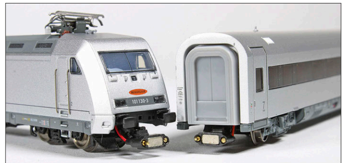
Die Magnetkraft zieht den leichtrollenden Wagen bereits aus diesem Abstand an die Lok.
