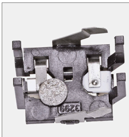
Die Selenplättchen werden durch isolierende Kartonstreifen ersetzt.
