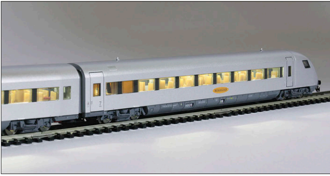
Die verwendeten Beleuchtungsplatinen sorgen für einen ausgewogenen Lichteindruck.
