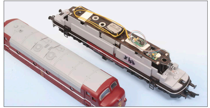
Diese ältere NoHAB von Tillig verfügt nur über einen sehr kleinen Ausschnitt in der Platine für einen Decoder. Ein Sounddecoder wäre hier zu groß. Soundmodul und Lautsprecher fanden dann auf der Platine ihren Platz. Alle Fotos: S. Koch
