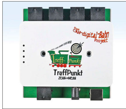
Der Treffpunkt ermöglicht den Anschluss der Jumbo-Module an den CAN-Bus von Zimo und Roco.
