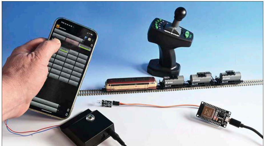
Hier erfolgt die Ansteuerung mit der EngineDriver-App auf einem Android-Smartphone. Benötigt werden nur ein ESP32 und eine Infrarotsendediode.
