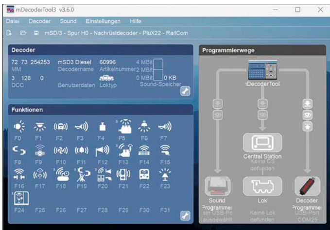
Das mDecodertool3 kann mSD3- und mLD3-Decoder mit dem Programmierer und der CS3 von Märklin bearbeiten.
