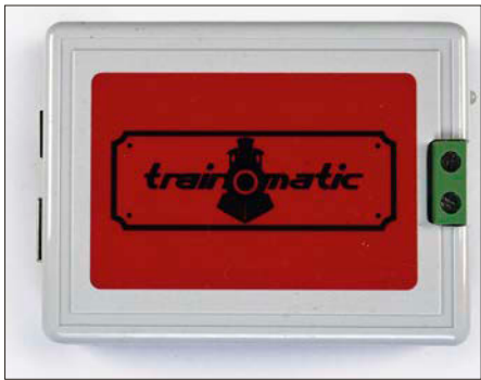
Lokomander 2-Decoder können mit diesem Programmer aktualisiert werden.
