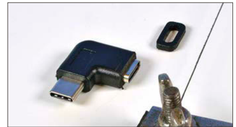
Damit der Winkeladapter als Arduino-Halter ins Gehäuse geklebt werden kann, wird ein wenig Kunststoff rings um die Buchse mit der Laubsäge entfernt.
