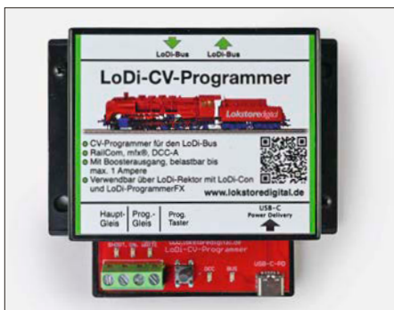
Der LoDi-CV-Programmer ist Programmierer und Mini-Digitalzentrale in einem Gerät.
