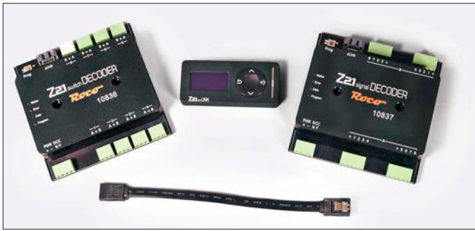
Mit dem Z21 pro Link lassen sich Weichendecoder und Signaldecoder von Roco entweder direkt am Gerät oder per WLAN mit Maintenance Tool beziehungsweise Z21-App konfigurieren.
