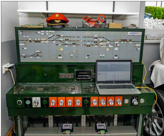
Beim Vorbild sind unterhalb des Verschlusskastens zahlreiche Relais- und Magnetschalter angeordnet. Hier reichen zwei LoDi-Rückmelder.
