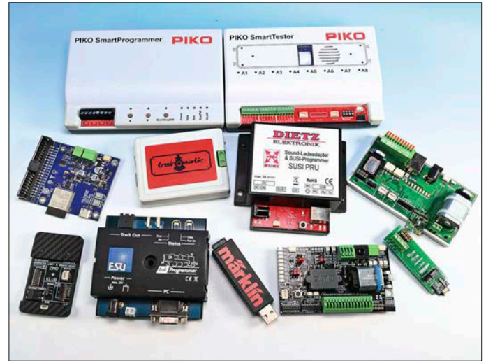
Nahezu jeder Decoderhersteller hat heutzutage eine Lösung im Programm, mit der Updates auf Decoder gespielt werden können. Viele Hersteller bieten dazu Programmer und Testplatinen an.
