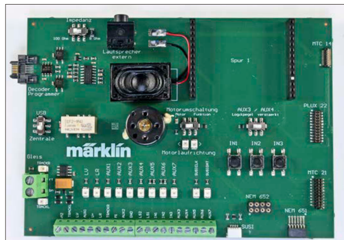
Der Decoder-Tester als Ergänzung zum Märklin-Programmierer bietet viele Schnittstellen und umfangreiche Testmöglichkeiten.
