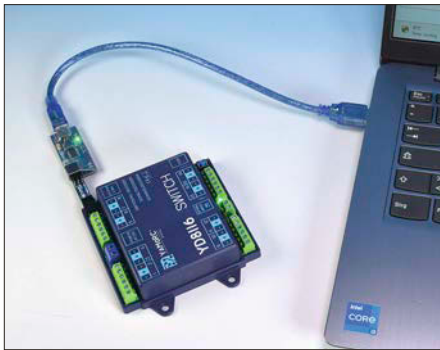
Mit dem YD9100 können alle YaMoRC-Module per ES-Link konfiguriert werden.
