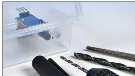
Einbau der Lichtschranken: Anhalten und Anzeichnen, erst 2 mm und dann 5 mm bohren und schließlich noch mit einer Rundfeile die Löcher nacharbeiten.
