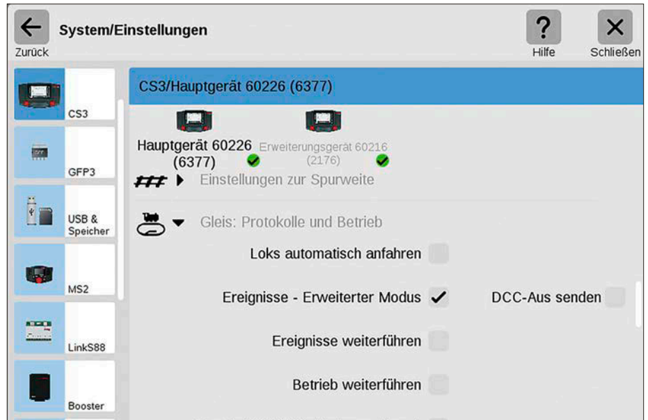
Im Systemeinstellungsmenü muss die erweiterte Ereignissteuerung aktiviert werden, um alle Ereignisfunktionen einschließlich der Steuerungselemente nutzbar zu machen. Alle Abbildungen: Lothar Seel
