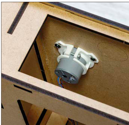
Der Montagering wird von unten am Anlagen- oder Trassenbrett befestigt und bietet sicheren Halt für das Modul.
