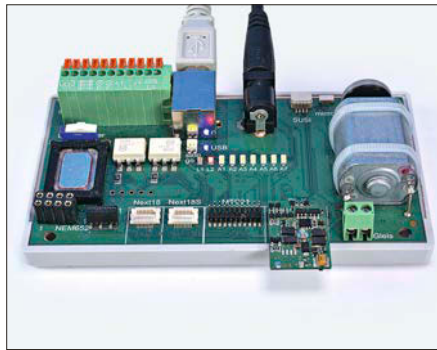
Der Digitest von Uhlenbrock ist Programmier- und Testgerät auf einer Platine.
