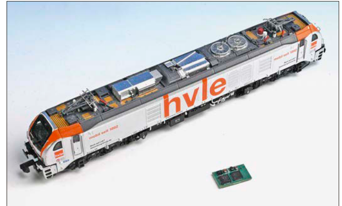
Der DH24A ( 14,4 \times 8,4 mm) von Doehler & Haass bedient über seine 5-Volt-Logikausgänge das volle Funktionsspektrum der Sudexpress EuroDual in der Baugröße N. Foto: Heiko Herholz
