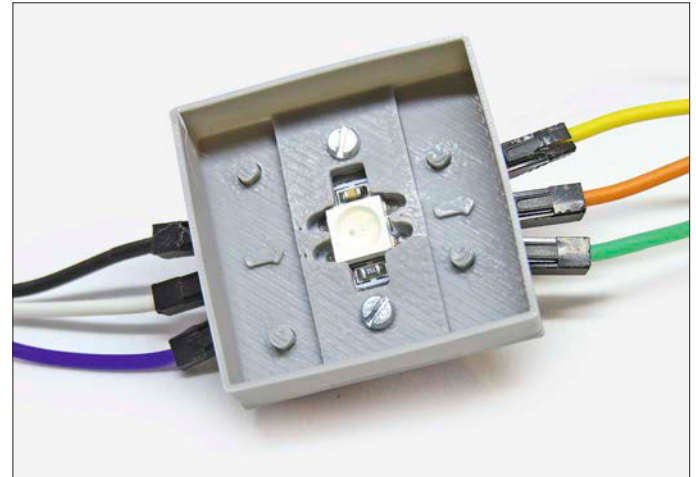
Ein vollständig montierter und angeschlossener Lichtkasten. So kann er nun in einem Gebäude für die Lichtautomation sorgen.
