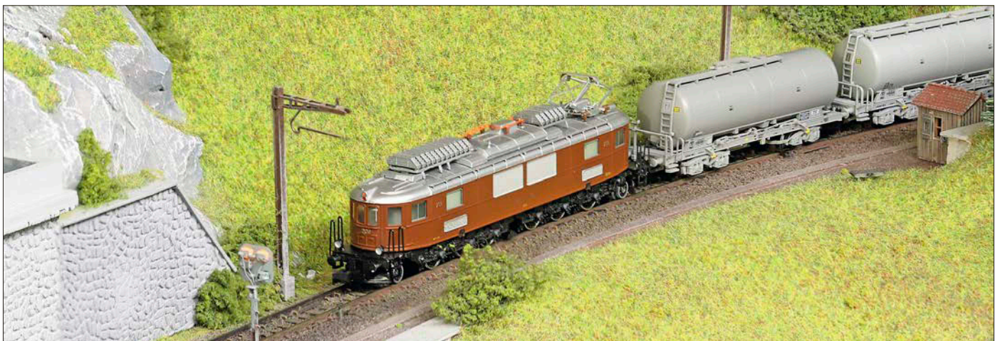
Auch heute macht die Ae 6/8 der BLS von Fulgurex in der Baugröße N noch eine erstaunliche gute Figur. Die Digitalisierung lohnt sich bei diesem Modell ganz besonders, denn die gute Zugkraft des Modells bleibt erhalten. Alle Fotos: Manfred Merz
