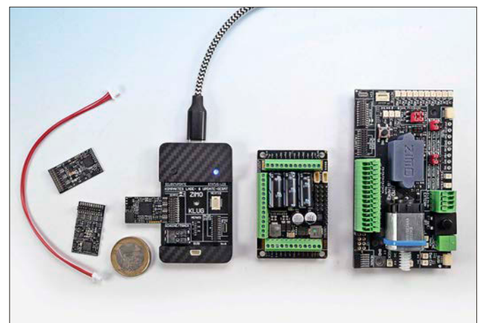
Auf das KLUG können kleine Decoder direkt aufgesteckt werden. Große Decoder werden per SUSI verbunden.
