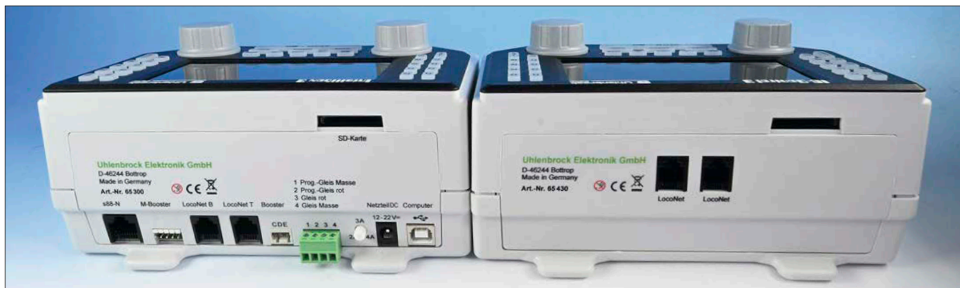
Die Intellibox 3 (links) bietet zahlreiche Anschlüsse für die unterschiedlichsten Dinge, die bei der IB-Control 3 (rechts) nicht vorhanden sind, da hier nur der LocoNet-Anschluss und der Steckplatz für die SD-Karte gebraucht werden.
