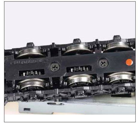
Vier der sechs Achsen sind angetrieben. Zwei sind mit Haftreifen ausgerüstet.
