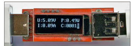
Rechts oben: Das Messgerät wird von einer Powerbank mit Einschalttaster versorgt. Der Stromverbrauch ist sehr gering (rechts). Sind die Lichtschranken aktiv, kommen nochmal ein paar mA hinzu.
