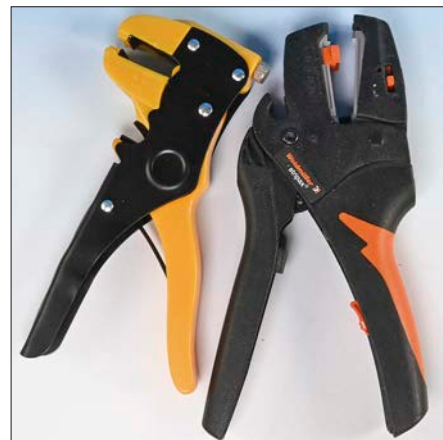
Die Abisolierzange links kostet nur ein Bruchteil des Markengerätes rechts und lässt sich nur grob einstellen.
