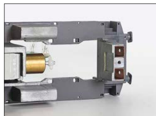
Das Licht eines Lämpchens fällt durch das Loch in seiner Kammer genau auf die Eintrittsfläche des Lichtkörpers im Lokgehäuse.
