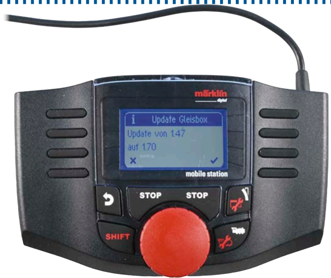
MS2 können sich gegenseitig updaten. Auch das Update einer Gleisbox kann mit der MS2 vorgenommen werden. Die MS2 wiederum bekommt initial Updates von der CS3. Foto: H. Herholz
