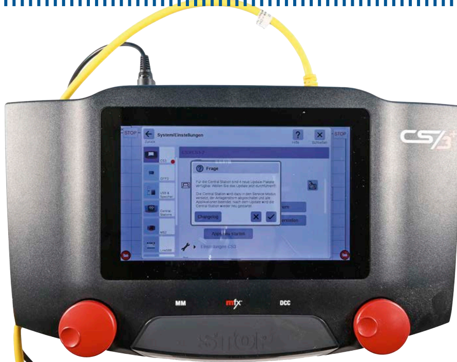
Man muss nur den roten Punkten folgen, um die Updates in der CS3 zu finden. Die CS3 kann sich selbst updaten und bekommt dabei auch die Updatedateien übertragen, mit denen die CS3 andere Geräte wie die Mobile Station 2 updaten kann. Foto: H. Herholz
