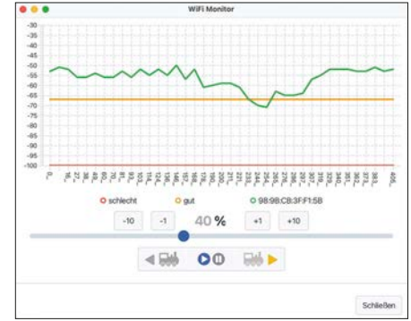
Der WiFi-Monitor in der CTC-App zeigt die Feldstärke des WLAN-Signals in der Lok an. Alle Abbildungen: Hans-Jürgen Götz
