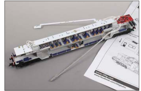
Die Platinen werden an der Inneneinrichtung befestigt. Das Untergeschoss wird von den Seiten ausgeleuchtet.
