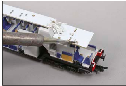
Zur Stromversorgung ragen bereits werksseitig Metallfährchen nach oben. Diese werden mit den Platinen verlötet.
