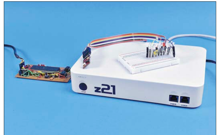
Hier wird doppelt getunnelt. Das LocoNet transportiert DCC-Nachrichten für Funktionen, die von der z21 nicht beherrscht werden.
