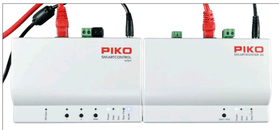
Der neue SmartBooster fügt sich nahtlos in das SmartControl WLAN-System ein und unterstützt dabei auch das RailComPlus-Verfahren, mit dem Triebfahrzeuge automatisch am System angemeldet werden.
