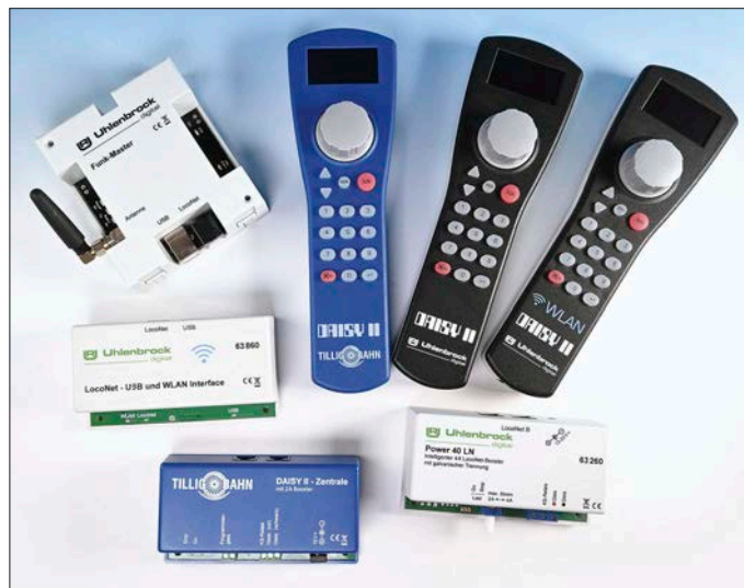
Das Daisy-II-System kann mit LocoNet-Komponenten leicht erweitert werden. Im einfachsten Fall werden Handregler, Booster, Funk und WLAN-Interface angeschlossen.
