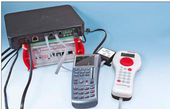
Ein etwas verrückter Aufbau: Die schwarze Z21 ist im Slave-Modus an das LocoNet der mc² angeschlossen. Am CAN-Bus der Z21 läuft ein MX32 von Zimo. Am X-Bus der Z21 ist ein Multi-XP-Adapter von MXion angeschlossen, an dem wiederum ein SmartController light von Piko läuft.
