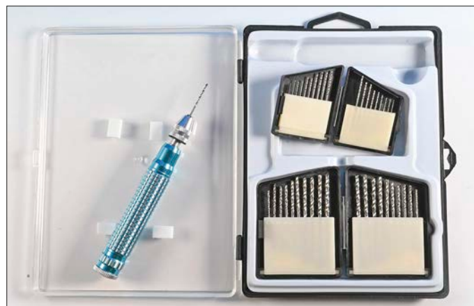
Ein Handbohrerset hilft bei vielen Umbauten an Modellbahnwagen und Triebfahrzeugen. Wer ein mechanisches Stellwerk von RST zusammenbauen will, benötigt einen 1,6 mm-Bohrer.
