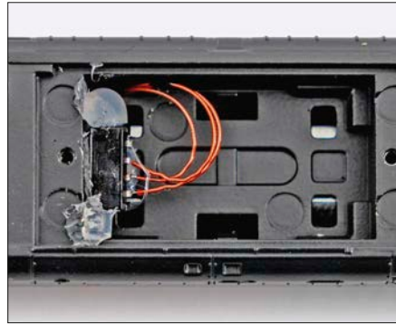
Für die Positionserkennung ist eine Infrarotdiode zuständig, die auf der Unterseite der Lok montiert wird.
