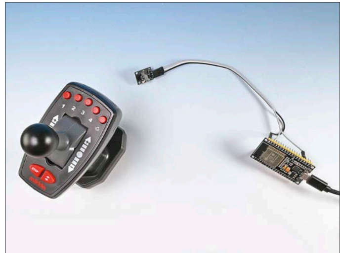
Der Versuchsaufbau besteht zunächst aus einem Power-Control-Stick von Märklin, einer Infrarot-Empfangsdiode und einem ESP32. Alle Abbildungen: Heiko Herholz
