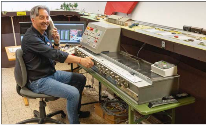
Das elektromechanische Reihenstellwerk vom Typ SBW der GKB lebt bei der Sulmtalbahn weiter.
