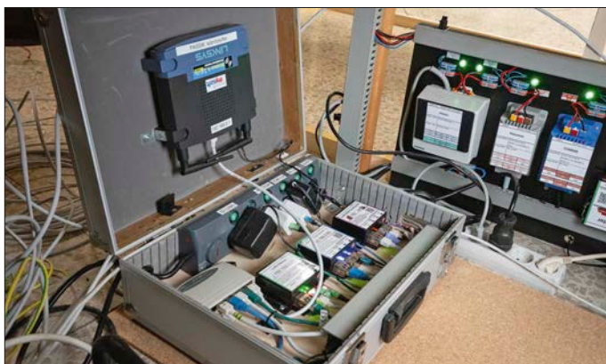
Der neueste Bahnhof wird mit iTrain und Lokstoredigital gesteuert. Zentrale Komponenten sind in einem Koffer untergebracht.
