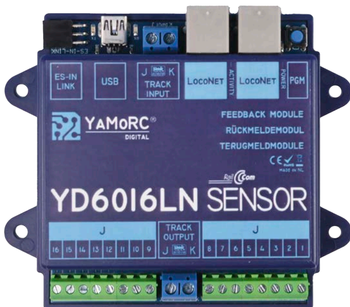
An der ES-Link-Buchse oben links können weitere ES-Link- oder s88-Rückmelder angeschlossen werden.
