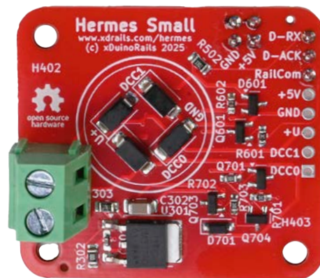
Der Adapter wird am Schraubklemmen-Anschluss mit dem Digitalsignal verbunden. Auf der rechten Seite kann man eine Stiftleiste einlöten und den Adapter auf einem Steckbrett einsetzen. Foto: Heiko Herholz
