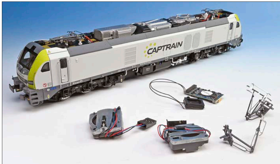
Das Material für den Umbau der Eurodual liegt bereit: Sounddecoder, zwei Stromabnehmer und zwei spezielle Servoantriebe werden in das Modell eingebaut.
