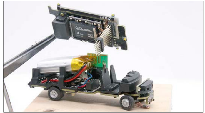
Der Platz im Aufbau wird vollständig genutzt. Sound-Chip und microSD-Speicherkarte sitzen in der oberen Platine.
