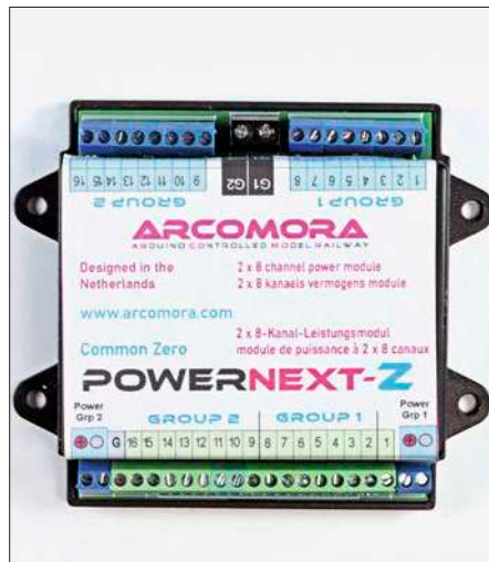
PowerNext-Z hat einen gemeinsamen Minuspol und kann in zwei Gruppen mit unterschiedlichen Spannungen arbeiten.
