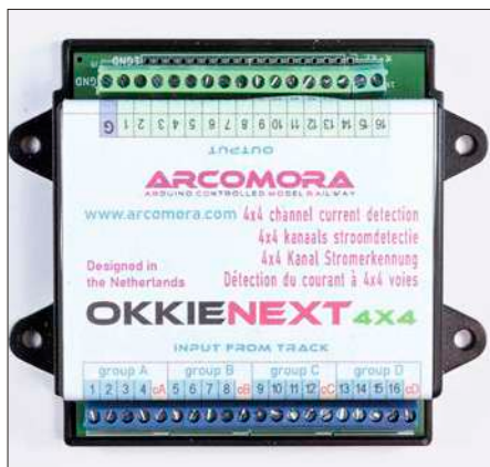
OkkieNext4x4 ist ein 16-fach Gleisbelegtmelder. Die 16 Ausgänge können mit einem LocoNext-Modul verbunden werden.
