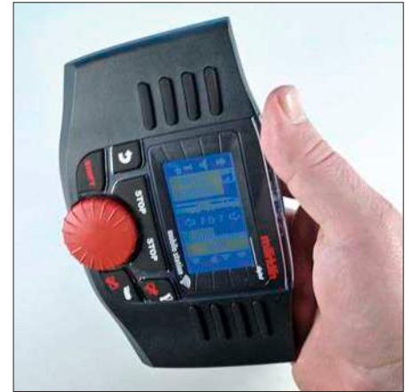
Die Mobile Station WLAN (MSW) dreht das Display automatisch mit.
