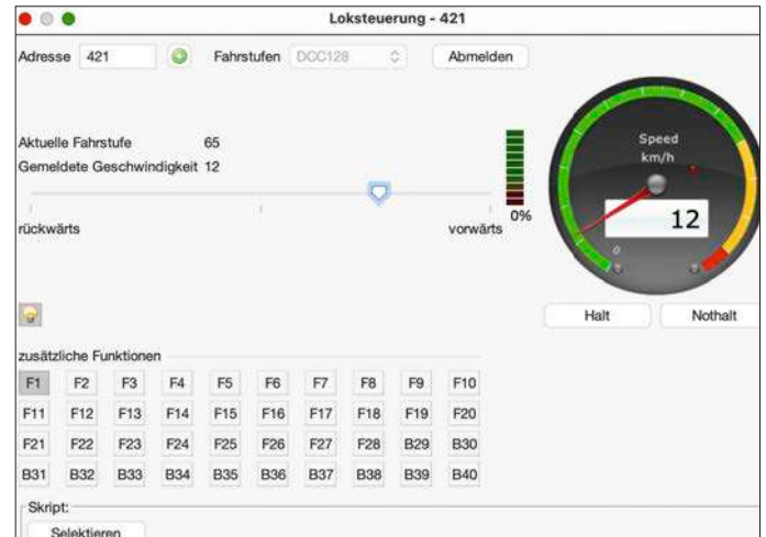
Mit dem BiDiB-Wizard kann man erste Testfahrten am PC machen. Das Tachometer zeigt die Ist-Fahrstufe des Decoders an, wenn diese Daten per RailCom vom Decoder gesendet werden.
