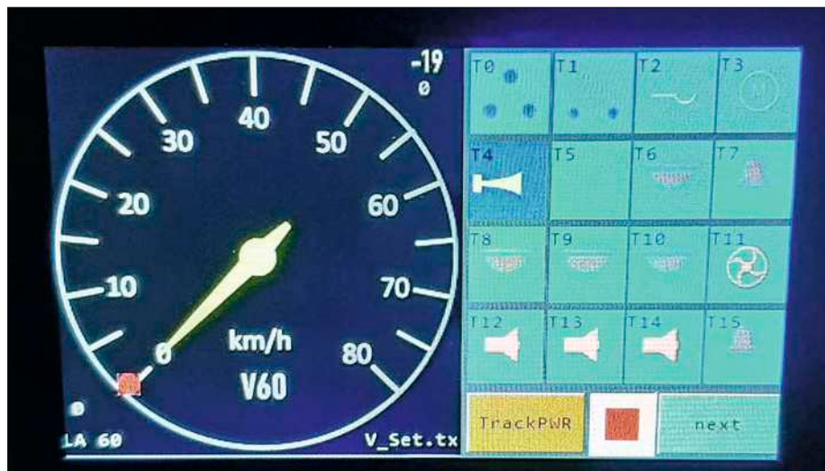
Die Lokadresse ist unten links sichtbar. Die Anzeige der X-Bus-Adresse erscheint beim Start kurzzeitig oben zwischen Tacho und Funktionstastenblock.
