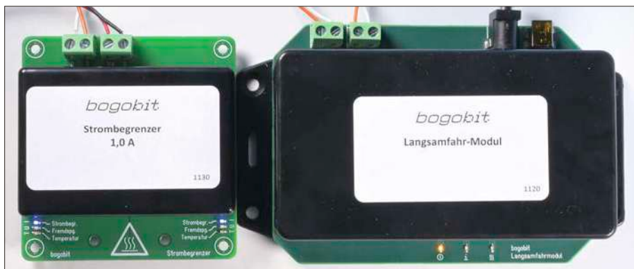
Hier sind der Strombegrenzer und das Langsamfahr-Modul im Einsatz. Der Strombegrenzer ist aktiv und wird langsam warm, wie man an der leicht glimmenden Temperatur-LED sieht.
