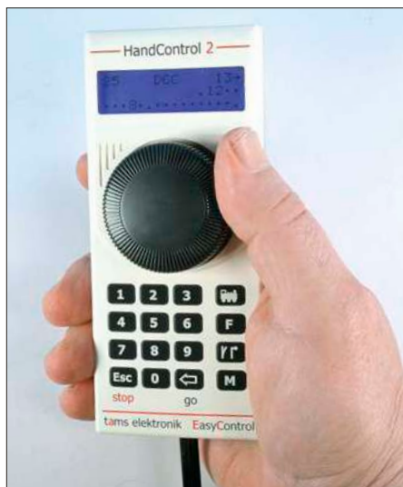
Tams bezieht das Gehäuse von Lenz und verwendet ein dreizeiliges Display.
