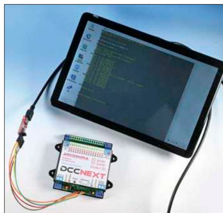
Zur Konfiguration wird DCCNext mittels eines einfachen USB-Interface mit einem Windows-PC verbunden.
