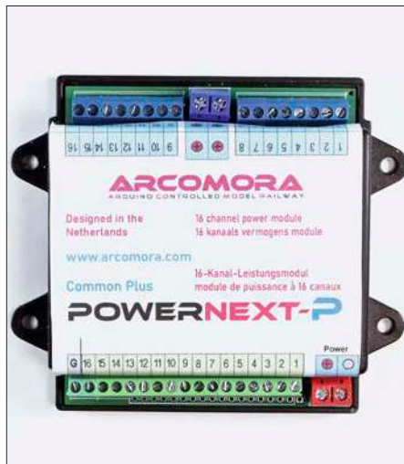
PowerNext-P bietet 16 Ausgänge mit gemeinsamem Pluspol. Es ist ideal zum Anschluss von handelsüblichen Signalen.
