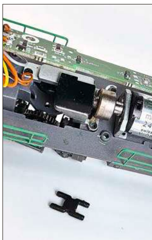
Die Anschlüsse der Telex-Kupplung werden durch ein Loch im Rahmen nach oben gefädelt.
