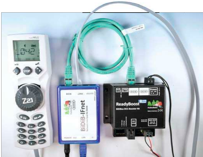
Die Kombination aus BiDiB-IFnet und ReadyBoost ergibt ein Digitalsystem, das auch mit einer Multimaus von Hand gesteuert werden kann.
