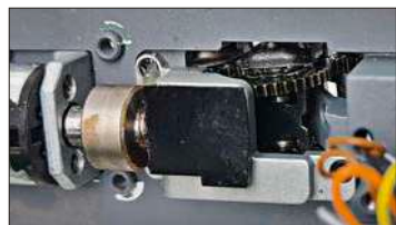
Die Antriebskraft wird vom Motor über Schnecke und Zwischenzahnrad auf ein H-förmiges Blech übertragen, das auf der anderen Seite in ein Längszahnrad im Drehgestell eingreift.
